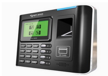
Slika 33 Uređaj za kontrolu pristupa
