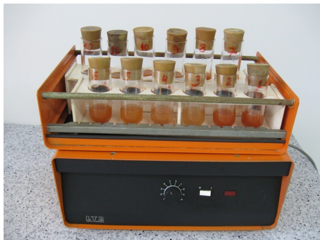
Slika 2.10. Horizontalni laboratorijski šejker, korišćen pri eksperimentima sorpcije.
