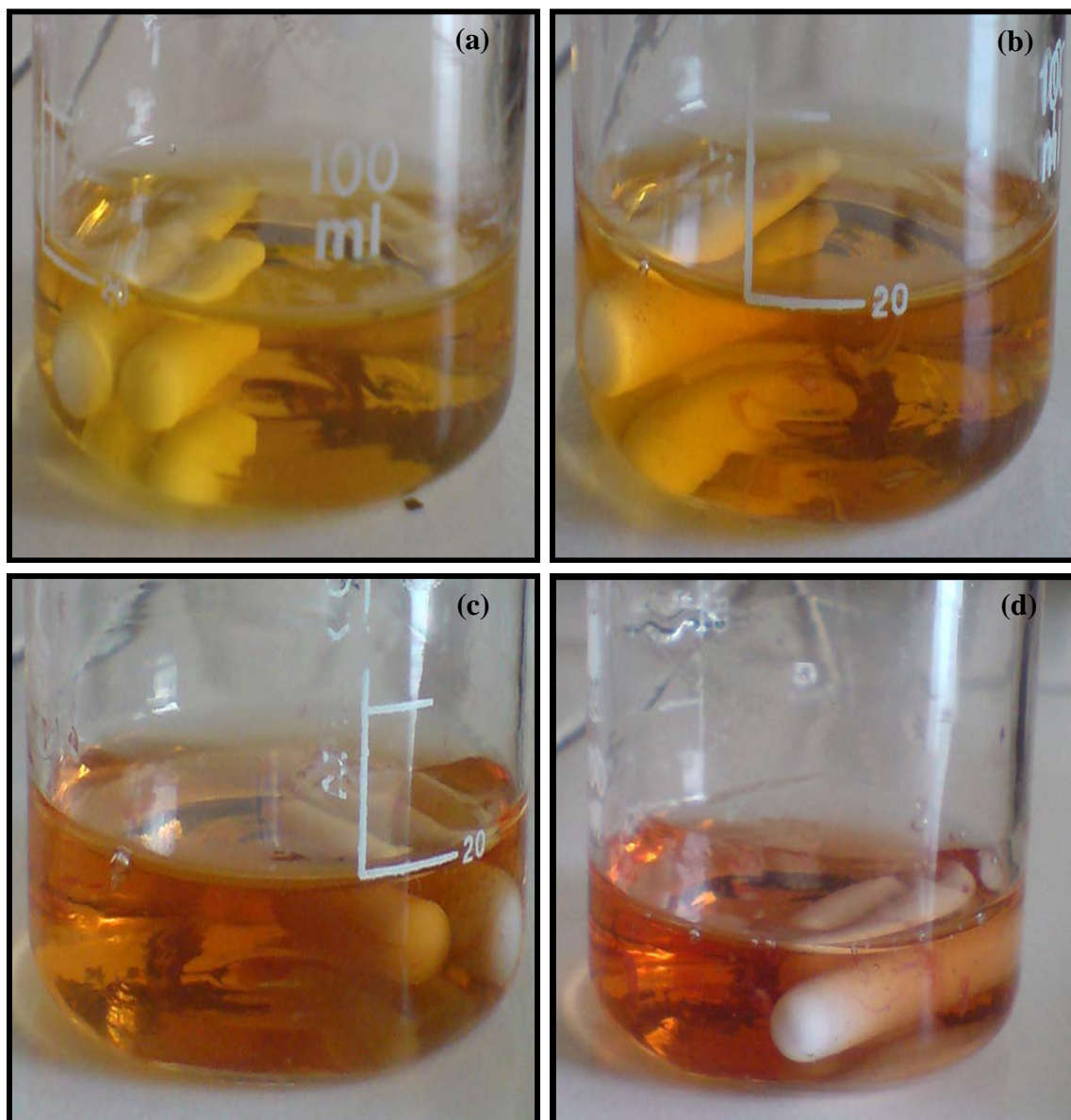
Slika 9.2. Promena boje pri titraciji rastvora hitozana: (a) V = 5,2 \text{ ml} , (b) V = 5,4 \text{ ml} , (c) V = 5,6 \text{ ml} - završna tačka i (d) V = 6,3 \text{ ml} .
