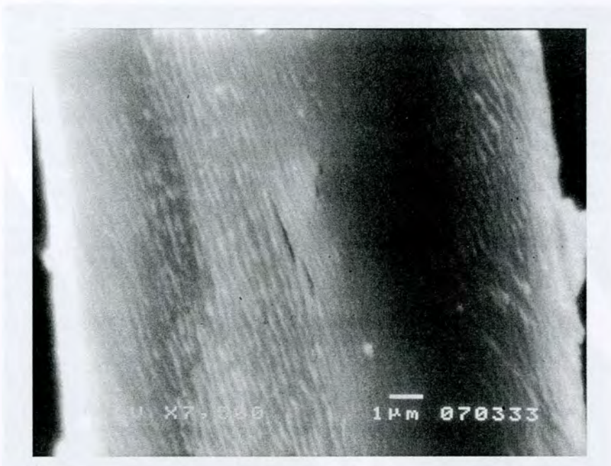
Slika 85. Skenirajući mikrograf netretiranog pamuka (uvećanje 7500)
