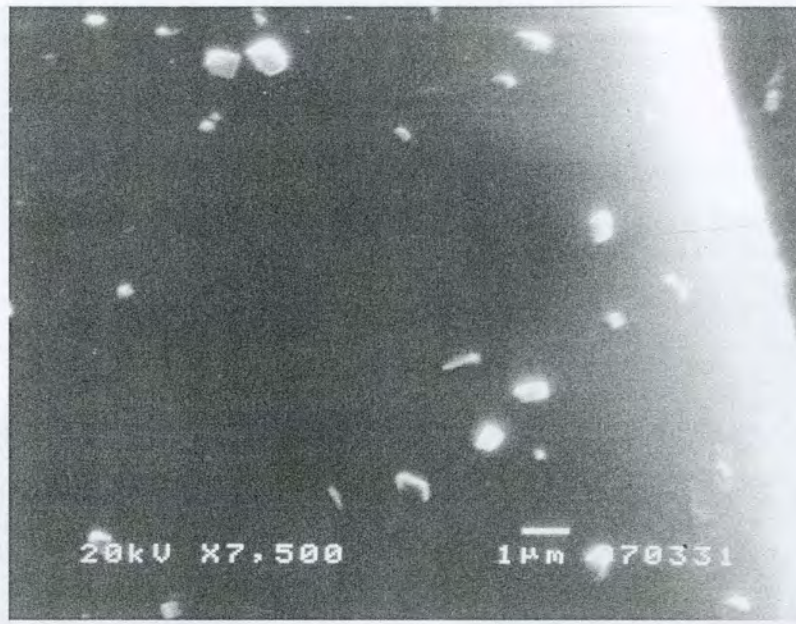
Slika 46. Skenirajući mikrograf netretiranog PES-a (uvećanje 7500)
