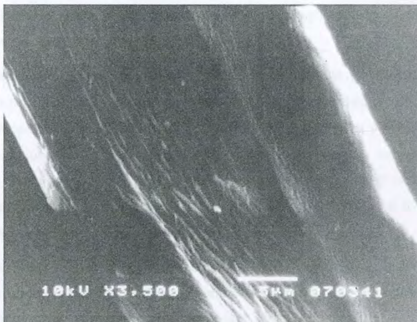
Slika 87. Skenirajući mikrograf pamuka obrađenog korona pražnjenjem (130 s, uvećanje 3500)
