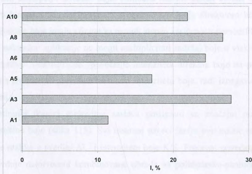
Slika 114. Povećanje intenziteta C. I. Direct Red 80 na fabričkoj mešavini PES/PAM obrađenoj rastvorom alkalije
