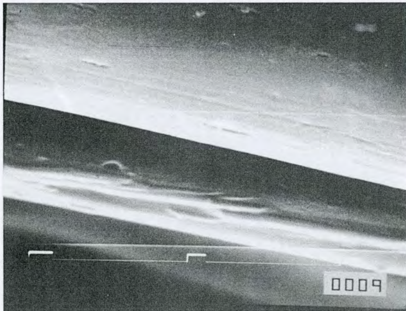
Slika 49. Skenirajući mikrograf alkalizovanog PES-a (A6, GM=2,27%, uvećanje 5000)
