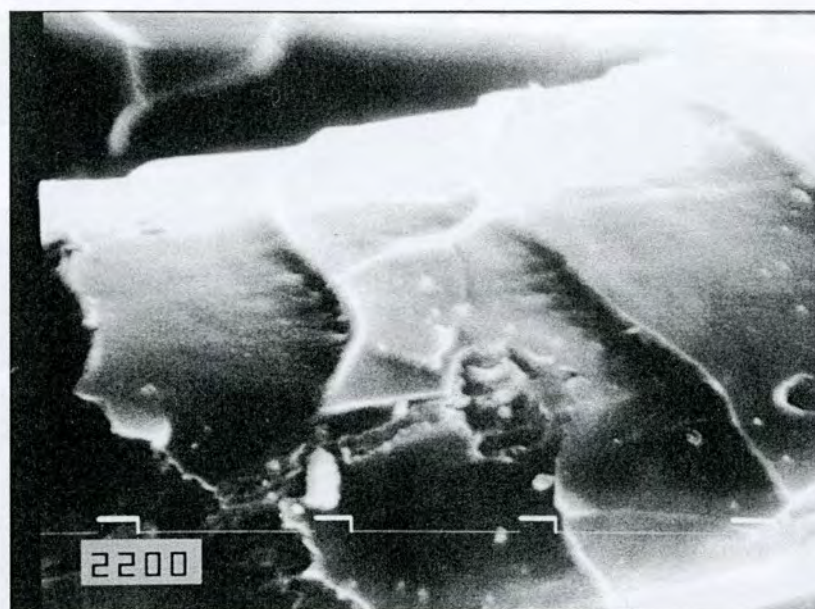
Slika 100. Skenirajući mikrograf vune obrađene korona pražnjenjem (60 s, uvećanje 3500)
