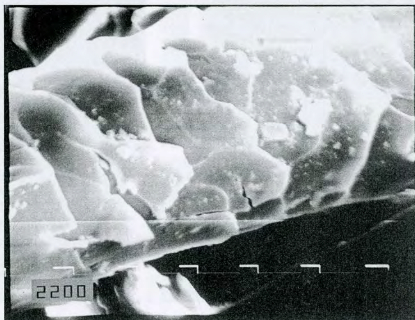
Slika 101. Skenirajući mikrograf vune obrađene korona pražnjenjem (80 s, uvećanje 3500)
