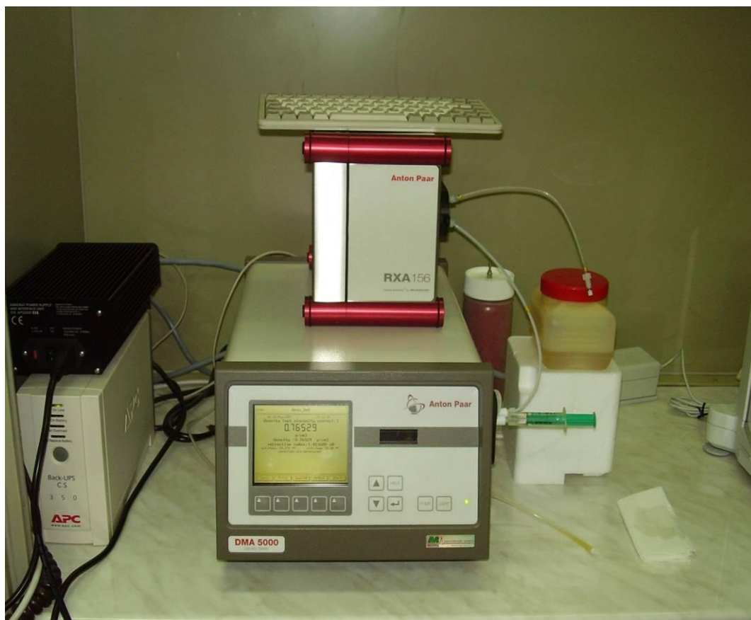
Slika 3.10 Kombinovani sistem Anton Paar DMA 5000/RXA 156
