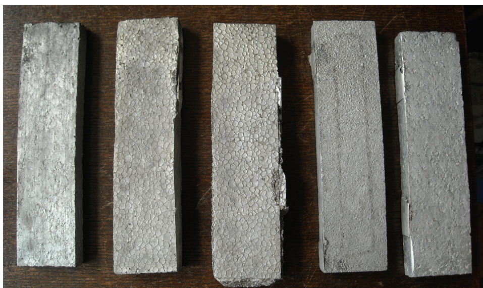
Sl.79. Izgled odlivaka tipa ploča dobijenih livenjem u pesku i po LF procesu
