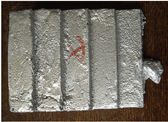
Sl. 89. Pojava površinske poroznosti, neravna površina odlivaka sa pojavom bora izazvani primenom debljih slojeva premaza
