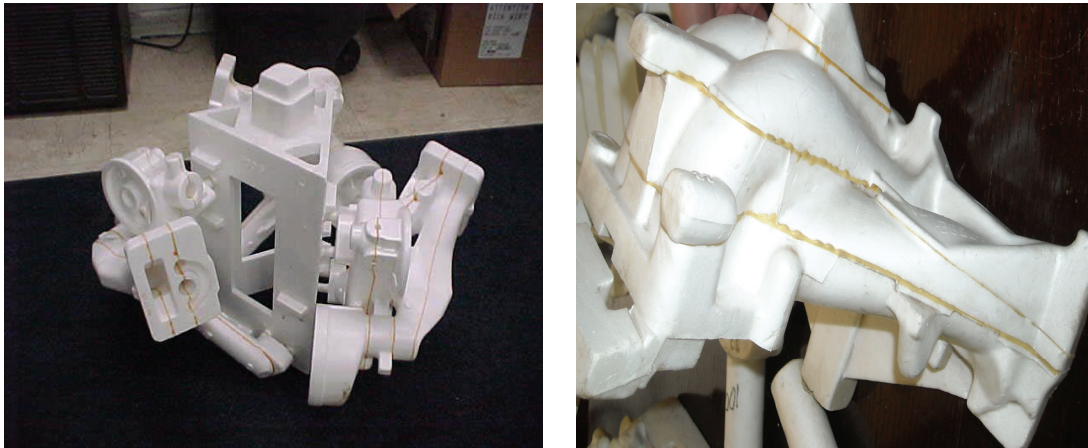
Sl.29. Modeli sklopljeni u "grozd" (vidi se linija spajanja modela sa centralnim sprovodnikom i ulivnicima) [48]
