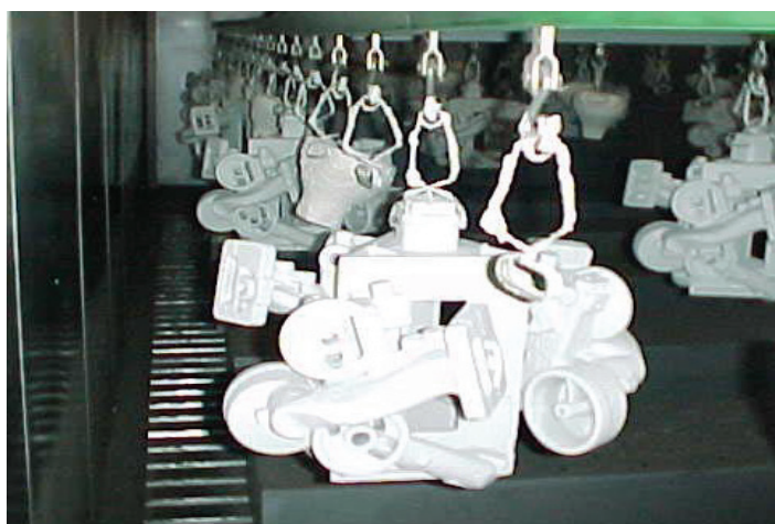
Sl.31. Sušenje nanetih slojeva premaza na vazduhu 24h [12]
