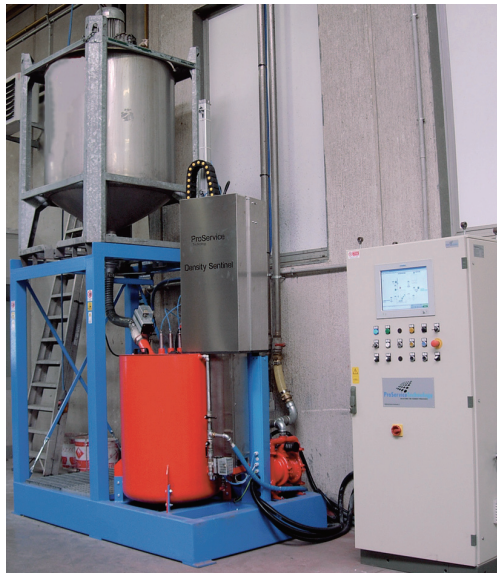
Sl.14. Oprema za pripremu premaza za ispitivanje i primenu [70]
