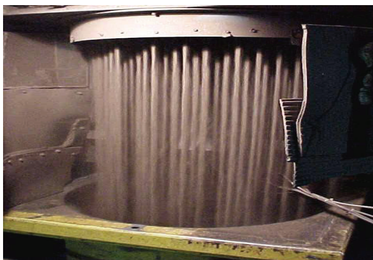
Sl.34. Zasipanje postavljenog "grozda" nevezanim peskom [12]
