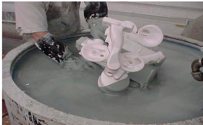
Sl.30. Nanošenje vatrostalnog premaza na "grozd" potapanjem u tank sa suspenzijom premaza [12]
