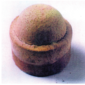
a. ispucali slojevi premaza
