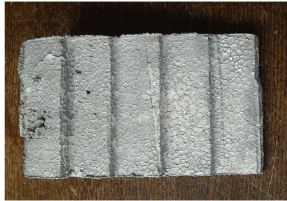
Sl. 89. Pojava površinske poroznosti, neravna površina odlivaka sa pojavom bora izazvani primenom debljih slojeva premaza
