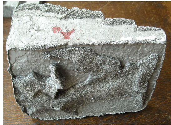
Sl. 90. Penetracije metala u kalup, tanji slojevi premaza kod debljih zidova odlivaka čelika
