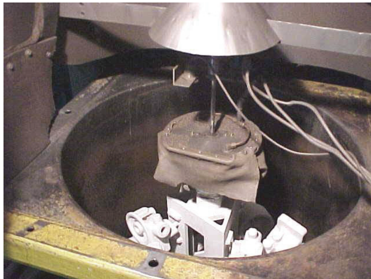
Sl.33. Postavljanje "grozda" u kalupnicu [12]
