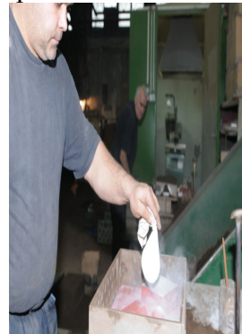
c. izjednačavanje sloja premaza na modelu
