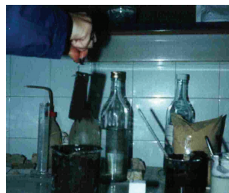
b. potapanje modela u suspenziju premaza
