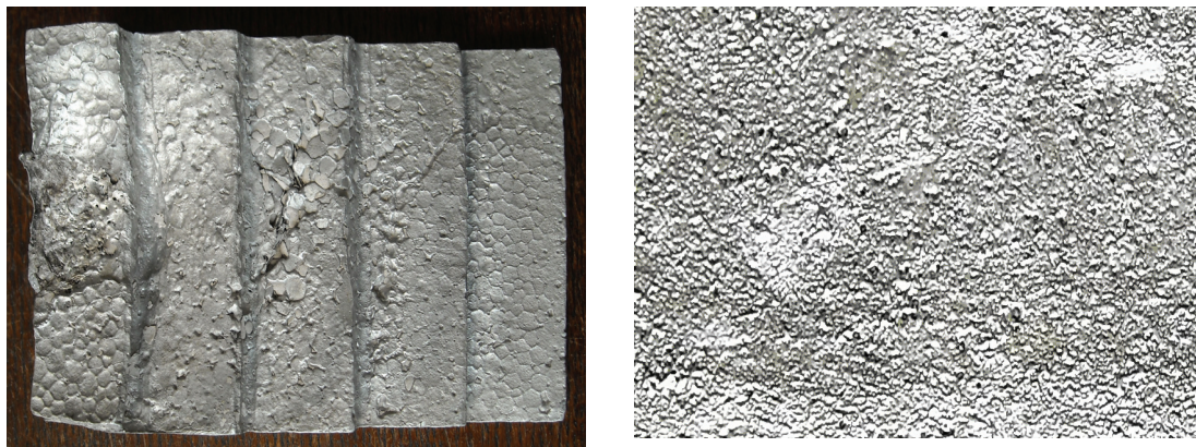
Sl. 88. Neravne i hrapave površine odlivaka izazvane zrnovitom površinom modela i debljim slojevima vatrostalnog premaza
