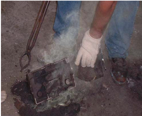
a. istresanje odlivaka iz kalupa
