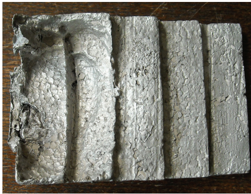
Sl. 90. Penetracije metala u kalup, tanji slojevi premaza kod debljih zidova odlivaka čelika
