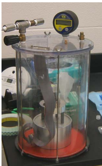
Slika 2.11 Cilindar sa CO atmosferom korišćen u STM merenjima
