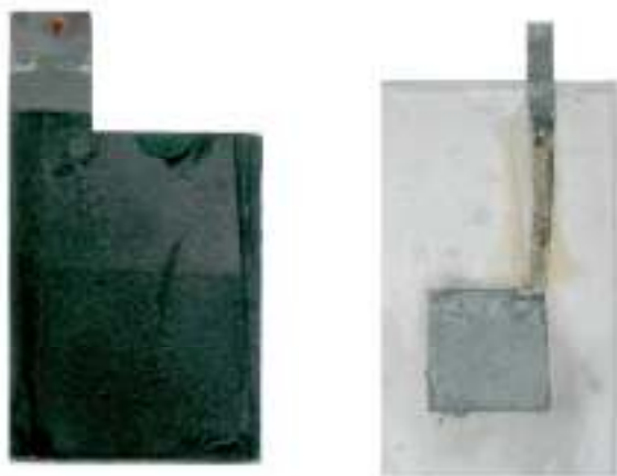
Слика 4.75. Електроде од полианилина и цинка које су коришћене у ћелији
