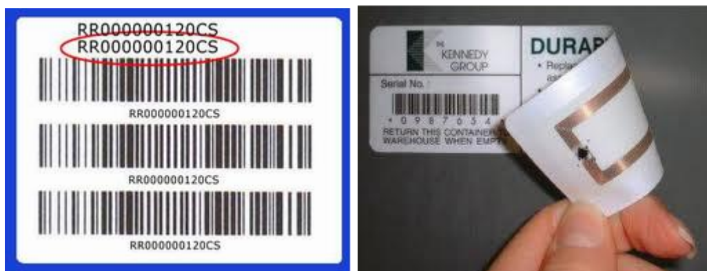
Слика 2.2. Бар код и RFID налепница за идентификацију поштиљке
