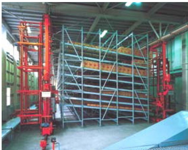
Slika 1.13 Automatsko komisioniranje paketnih jedinica
