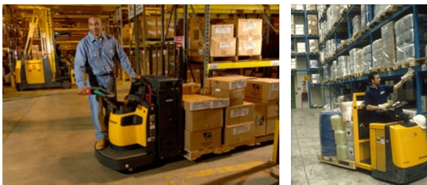
Slika 1.7 Prikaz viljuškara za horizontalni transport (paletna kolica; viljuškar komisioner za horizontalni transport)
