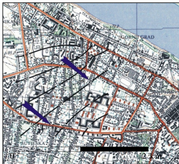
Slika 81. Pravci kretanja i dubine do nivoa podzemnih voda na teritoriji Zemuna na dan 30.11.2005. godine (Milenić, 2006)
