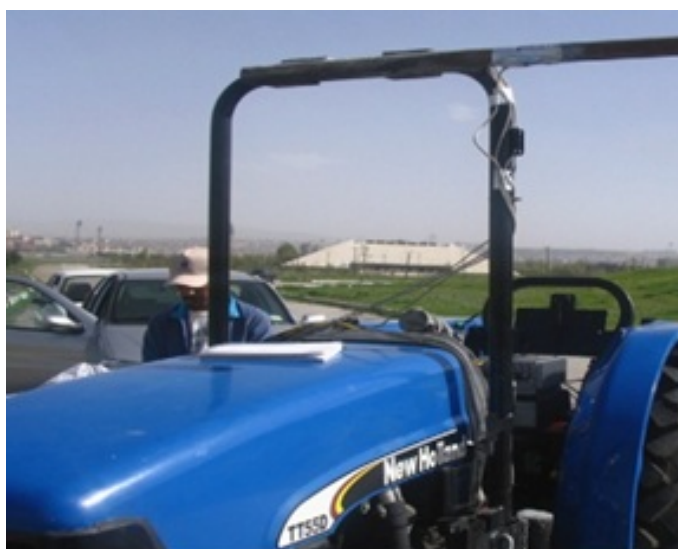
Slika 4.3. Sistem zaštite od višestrukog prevrtanja, Silleli (2008)
