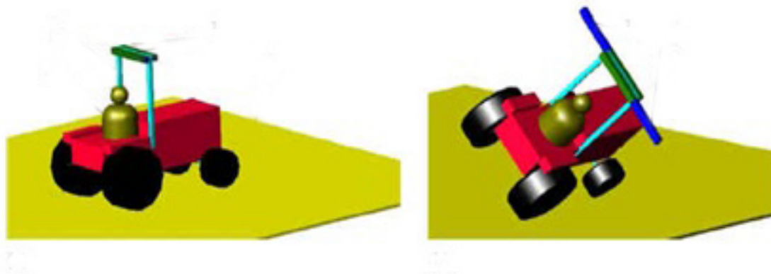
Slika 8.6. Princip rada automatskog zaštitnog rama, NIOSH (2001)
