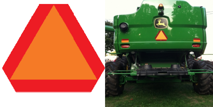
Slika 4.4. SMV ( Slow Moving Vehicle ) znak i katadiopterske nalepnice na kombajnu, Legault (2002)
