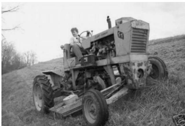
Slika 4.5. Konstruktivno prilagođena mašina za rad na terenima sa nagibom, Mashadi (2009)
