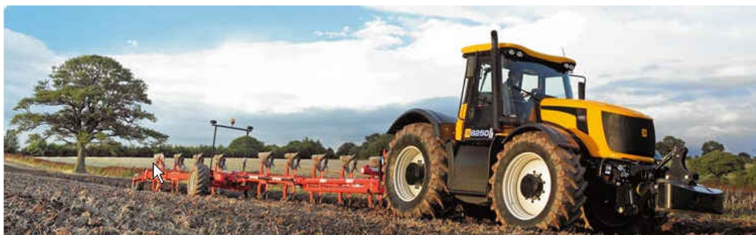
Slika 8.9. JCB FastTrac 8250, model traktora sa brzinom kretanja do 70 km/h i sistemom kočenja sa ABS-om (Anti-lock Breaking System), JCB (2006)
