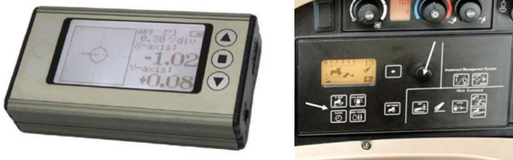
Slika 8.5. Centralni digitalni displej traktora-radne mašine sa informacijom o nagibu, Vigor Technology (2012)
