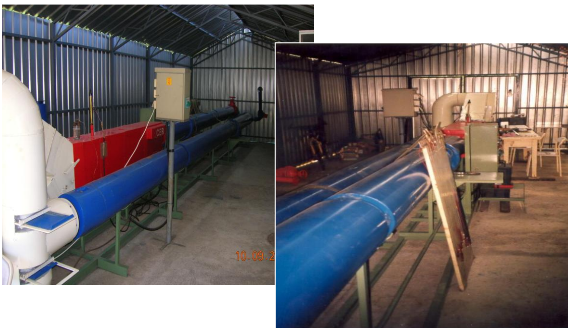
Сл. 1. Експериментална сушара за испитивање процеса конвективног сушења (сликана из два угла - повратни вод и потисни вод)
