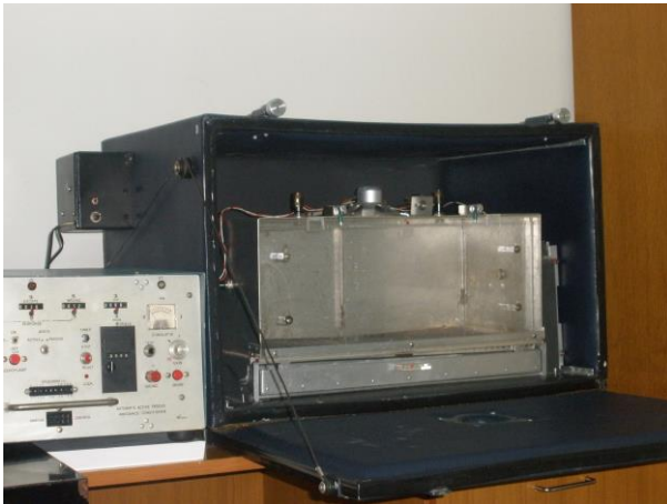
Slika 4. Aparatura za izvođenje uslovljenog ponašanja tipa aktivnog izbegavanja (AA).
