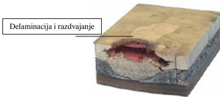
Slika 3.16 Prikaz poprečnog preseka oštećenog oklopa od kompozita [16]
