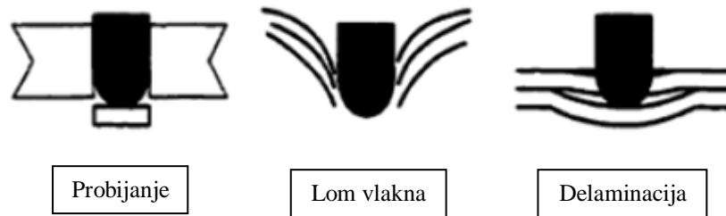
Slika 4.11 Mehanizmi oštećenja koji se javljaju u kompozitnom materijalu pod dejstvom balističkog udara [73]
