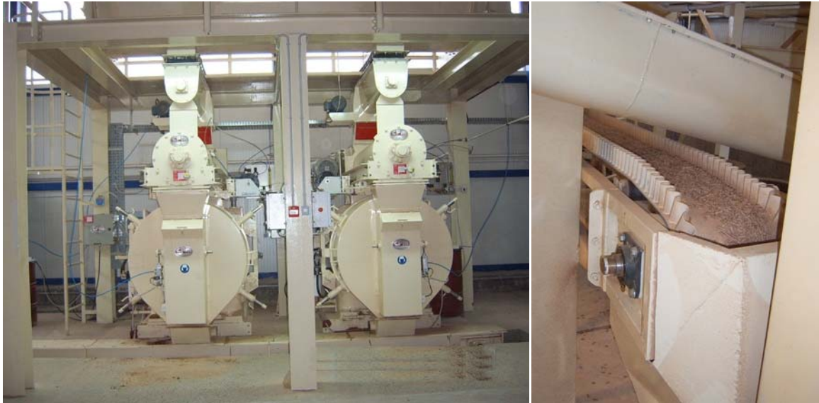
Слика 16. Пресе за производњу пелета и завршетак линије за хлађење
