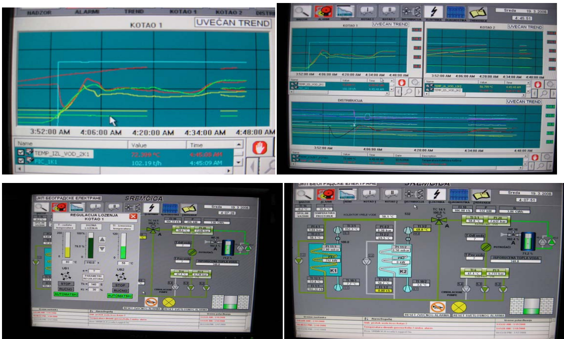
Слика 73. Монитор на термокоманди – приказ података које прикупља SCADA систем
