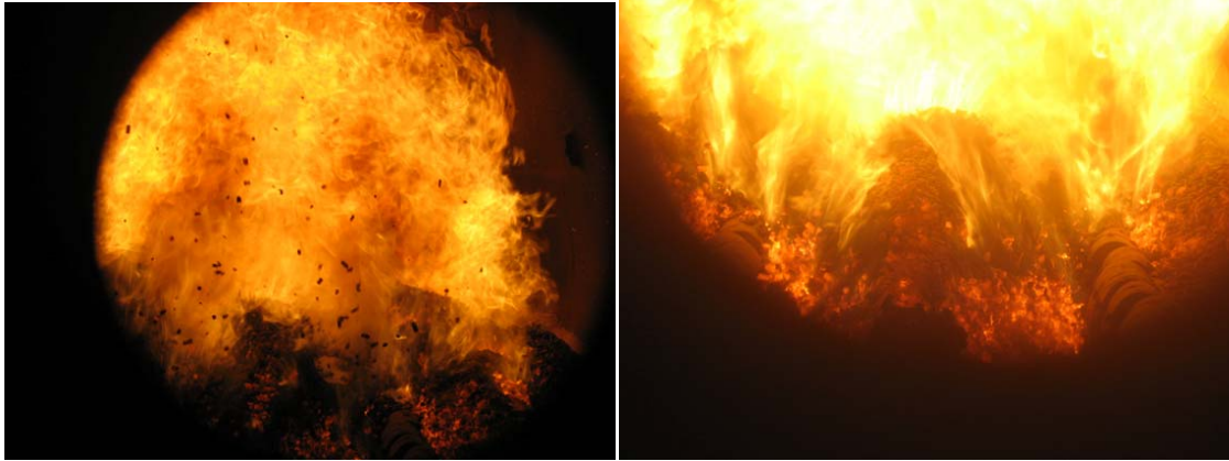
Слика 56. Сагоревање пелета у котлу – поглед кроз контролни отвор
