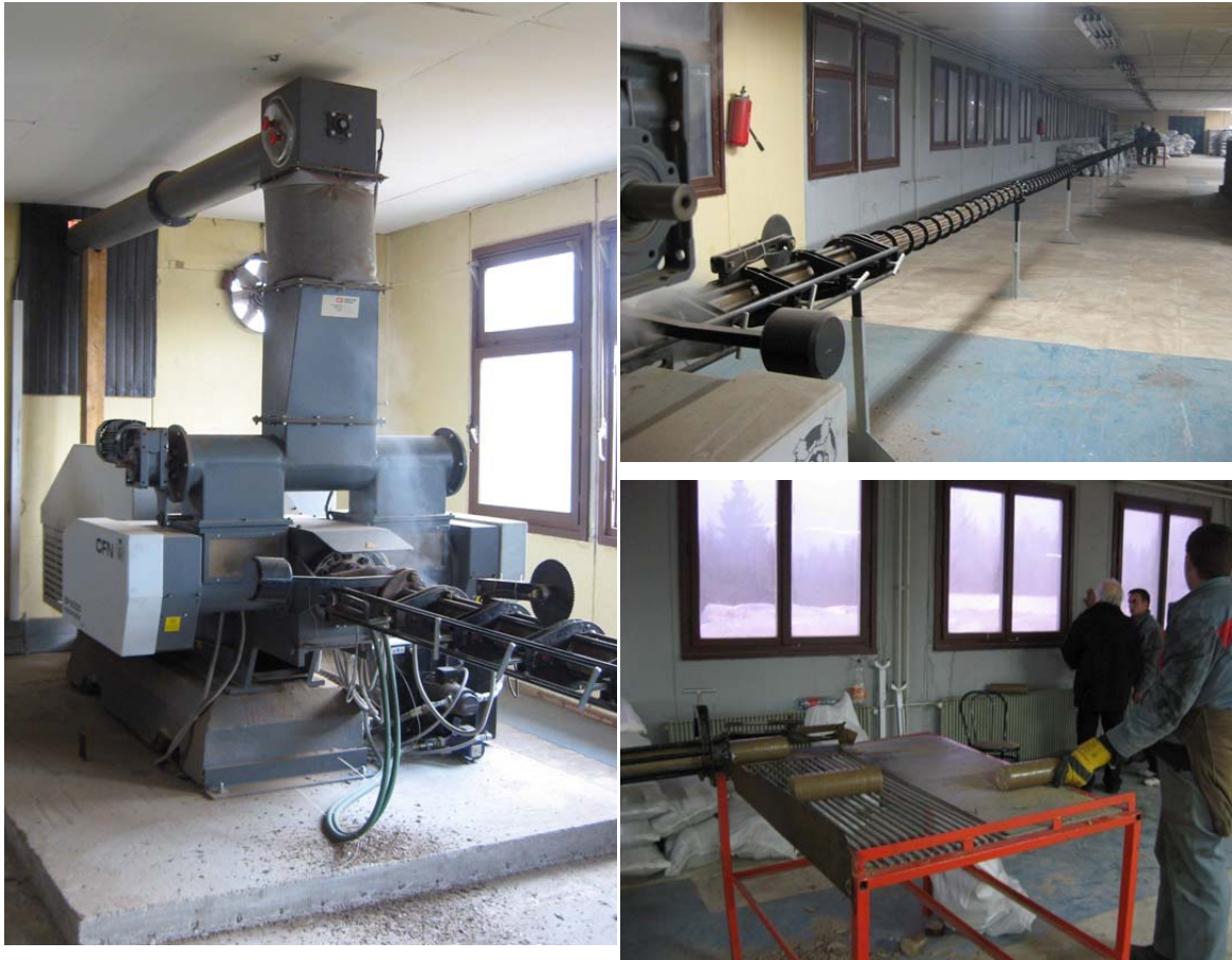
Слика 14. Преса за брикетирање дрвне биомасе и линија за хлађење
