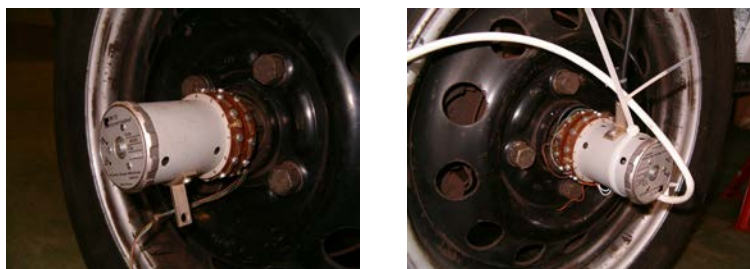
Slika 7.24. Konektor za prenos signala do mjernog mosta
