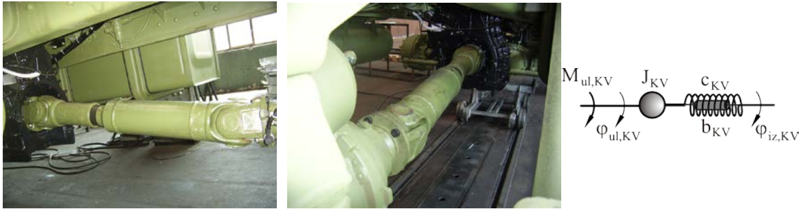
Slika 7.6. a) Kardansko vratilo [69], b) Uprošćena šema kardanskog vratila
