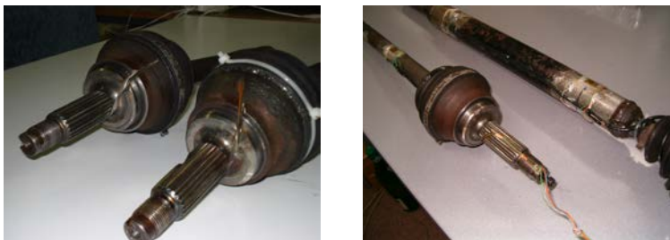
Slika 7.22. Poluvratilo sa žljebom i mjernim trakama za mjerenje momenta
