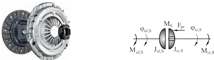
Slika 7.4. a) Frikciona spojnica vozila [78], b) Uprošćena šema frikcionne spojnice
