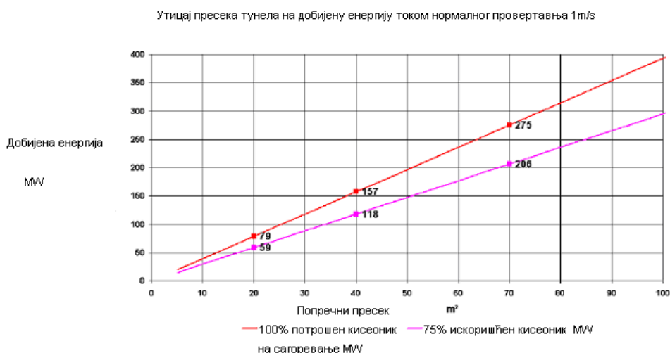
Слика 3.3. Развој пожара у тунелу у функцији количине ваздуха [Pleß-Seliger, 2009].
