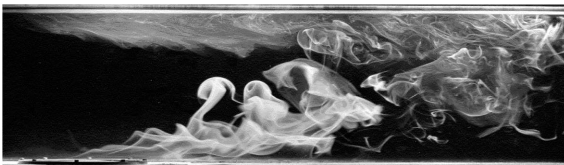
Слика 4.2.: Ширење дима у тунелу за пожар топлотне снаге 15 kW , [Wu - Bakar, 2000]
