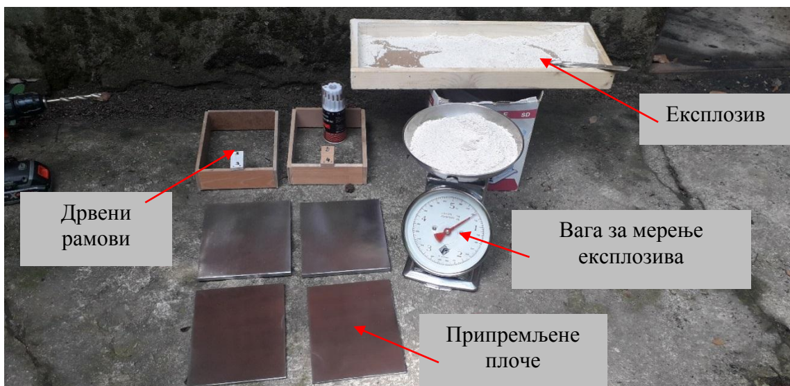
Слика 4.15. Металне плоче и кутије за заваривање експлозијом.
