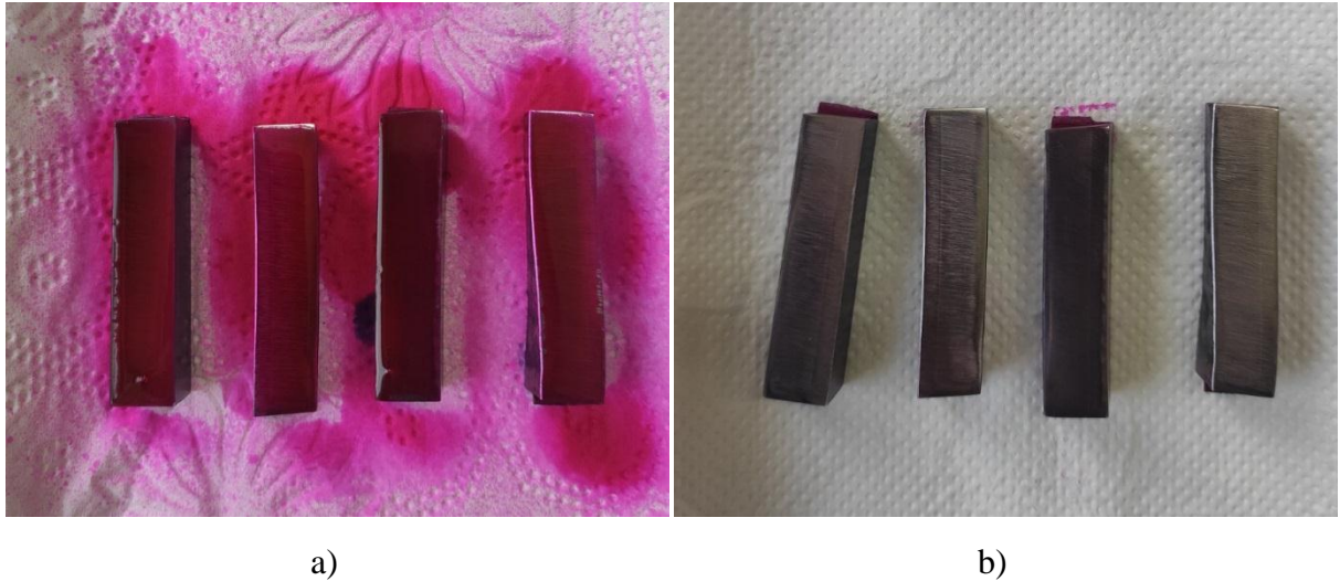
Слика 6.22. а) Пенетрант на површини узорака за испитивање, б) Узорци за испитивање редом узорци 1-9,3-9,4-9,2-13.
