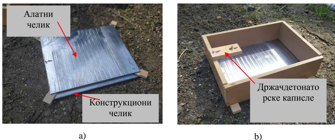
Слика 4.16. Процес монтаже за извођење експеримента.
