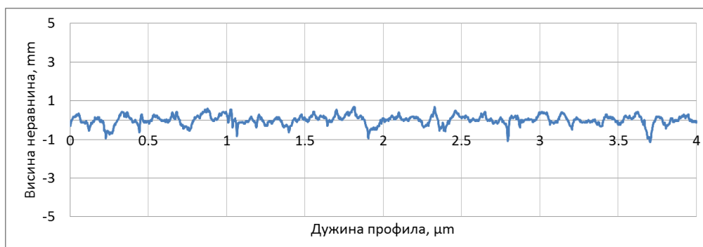
Слика 6.11. Профил површине алатног челика, узорак 2.
