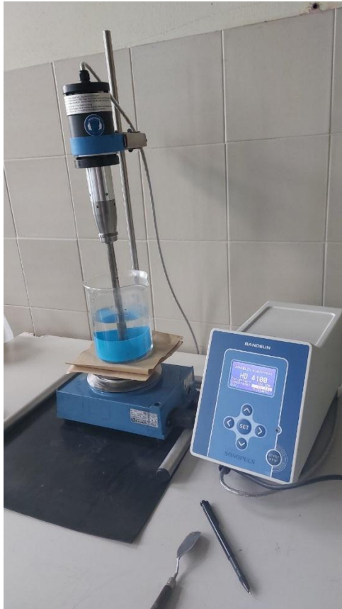
Слика 5.12. Изглед уређаја (лево), шематски приказ уређаја (десно) (Dojcinović, 2008), (ASTM G 32 – 03, 2023).
