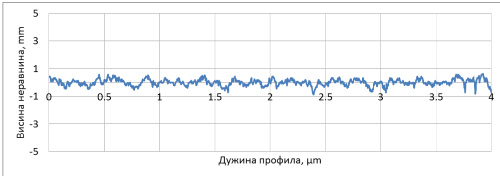
Слика 6.6. Профил површине конструкционог челика, узорак 1.
