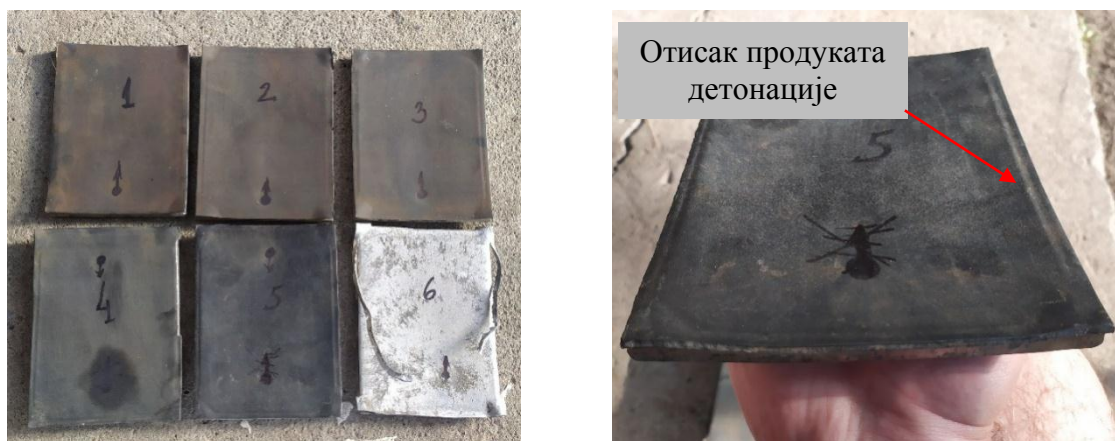
Слика 4.14. Плоче добијене експлозивним заваривањем Опружни/Конструкциони челик.
