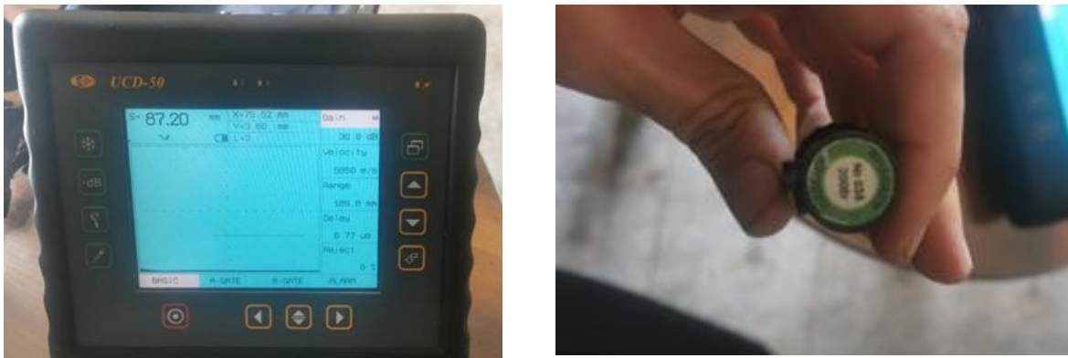
Слика 6.13. Ултразвучни дефектоскоп.
