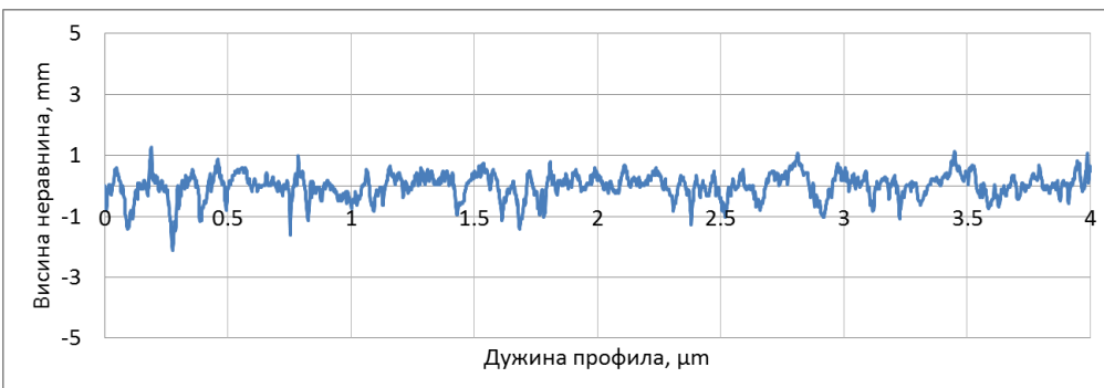
Слика 6.9. Профил површине конструкционог челика, узорак 4.
