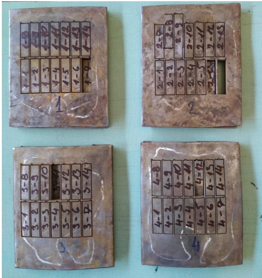
Слика 6.18. Нумерација исечених узорка.
