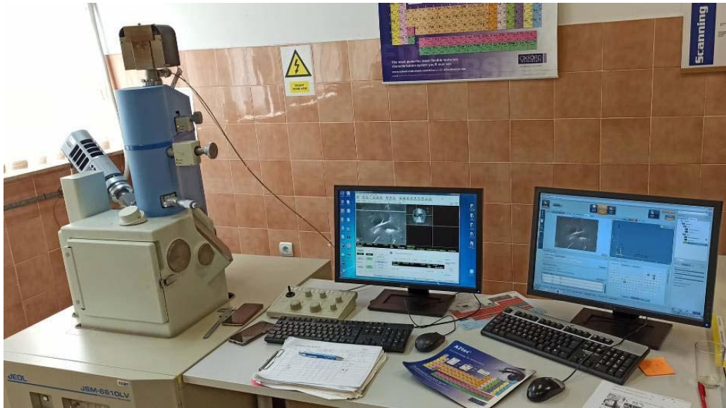
Слика 5.13. Скенирајући електронски микроскоп „SEM“ (Марјановић, 2022).
