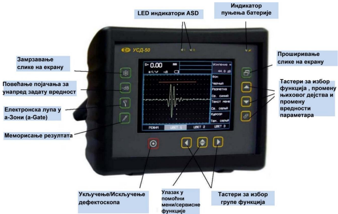
Слика 5.20. Чеони панел коришћеног ултразвучни дефектоскоп (Кропус, 2012).
