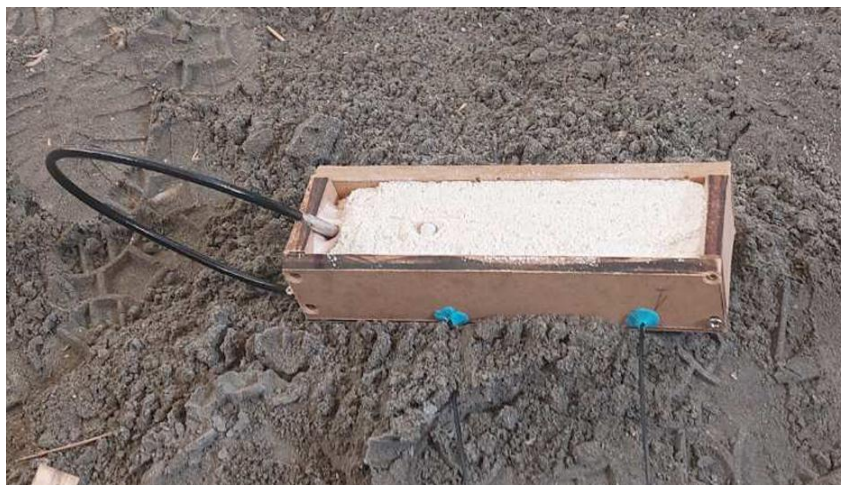
Слика 6.2. Узорак експлозива Демекс за мерење брзине детонације у кутији.
