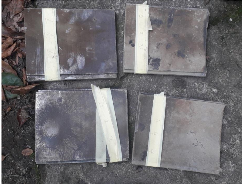
Слика 4.18. Плоче добијене експлозивним заваривањем алатни/конструкциони челик.
