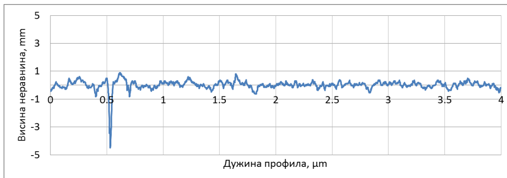
Слика 6.10. Профил површине алатног челика, узорак 1.
