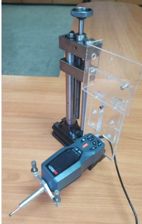
Слика 6.3. Уређај „ ISR-C002 “ за мерење храпавости површина.
