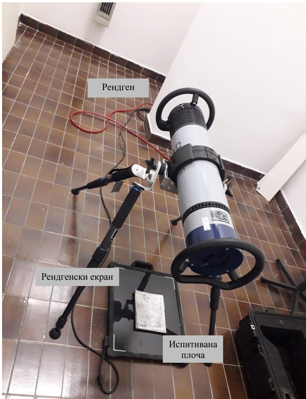
Слика 6.15. Процес испитивања плоче Рендгеном.
