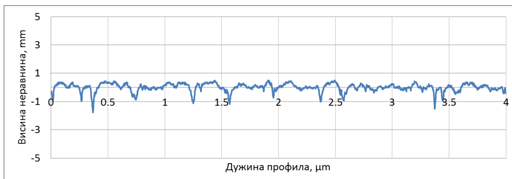
Слика 6.12. Профил површине алатног челика, узорак 3.
