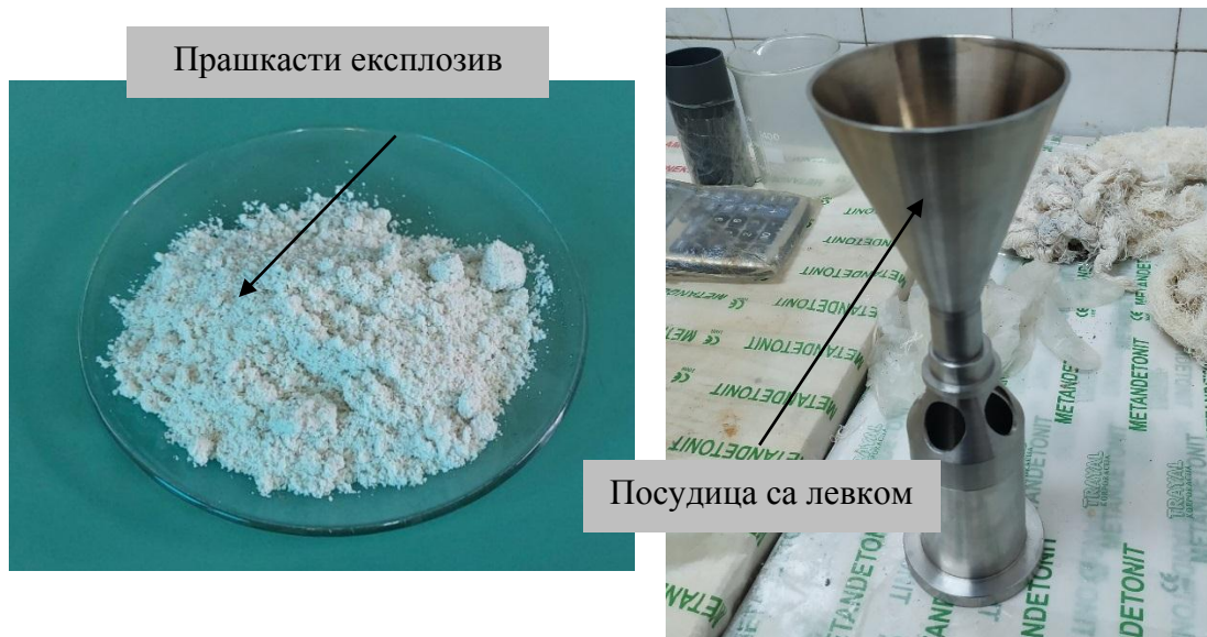
Слика 4.9. Поступак за мерење запреминске густине експлозивног материјала
