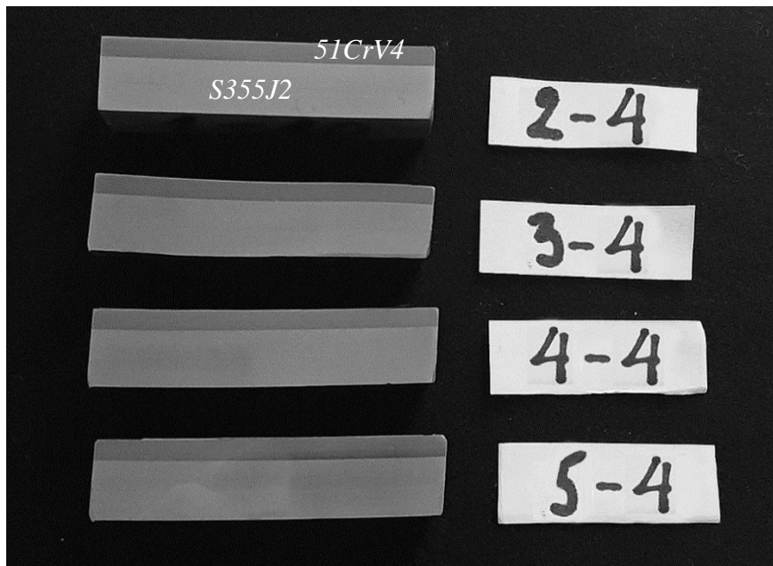
Слика 6.27. Металографски узорци (Опружни/Конструкциони челик).
