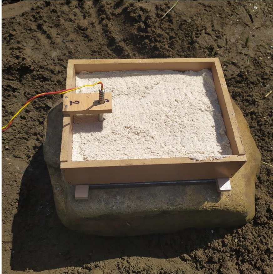
Слика 4.3. Експериментална поставка експлозивног заваривања.
