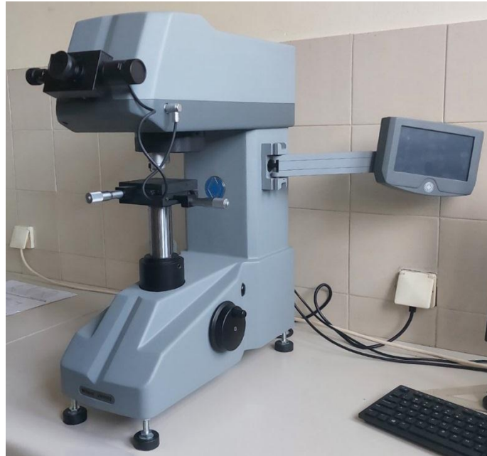
Слика 5.16. Уређај за мерење тврдоће „Wilson DiaMet“.
