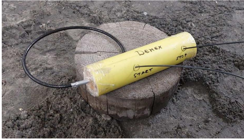
Слика 6.1. Узорак експлозива Демекс за мерење брзине детонације у PVC цеви.
