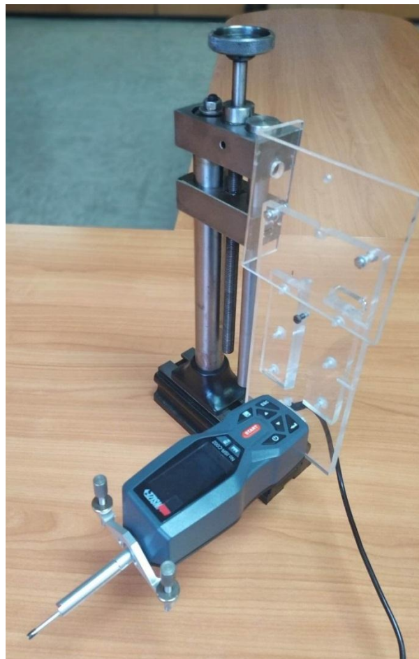
Слика 5.6. Уређај „ISR-C002“ за мерење храпавости површина.
