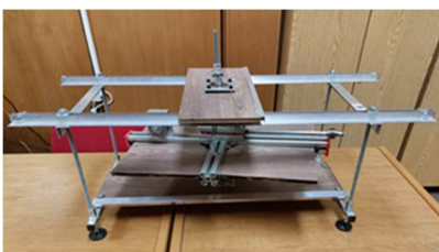
Слика 8.3 Учило за демонстрацију обртања тела око произвољно изабране осе (омогућава сагледавање кинематике улежиштења произвољног избора оптерећења тела и демонстрацију инерцијалне силе и еластично везане масе током обртања)
