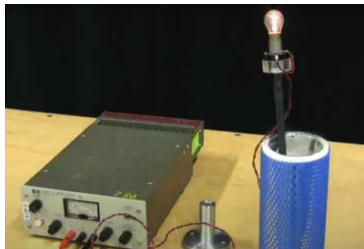
Слика 4.6 Пример лабораторијског сета за демонстрирање и анализу утицаја температуре на отпор проводника у лабораторији Департмана за физику америчког MIT-а [159]
