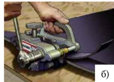
Слика 2.31. Напредан начин постављања механичких спојница
