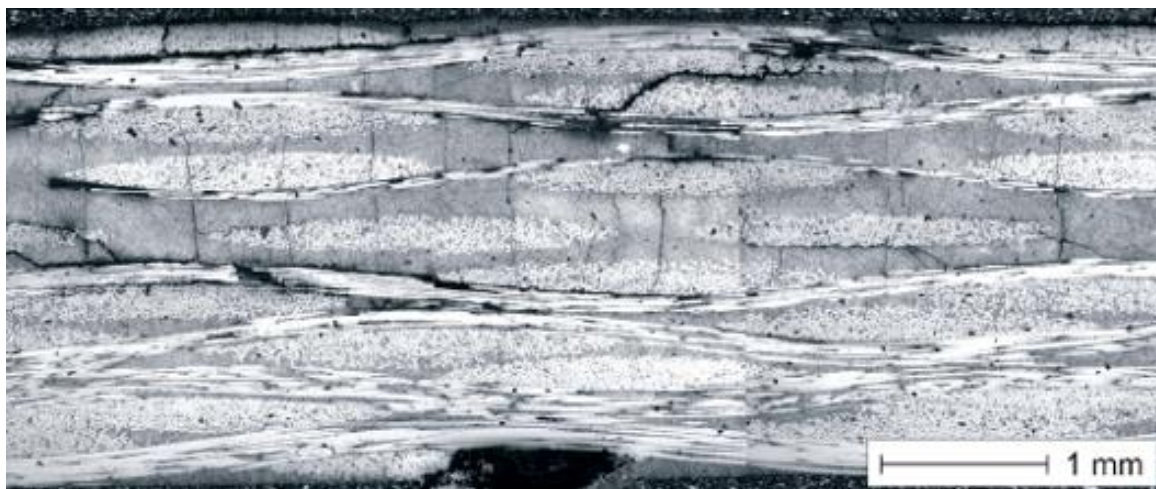
Слика 4.27. Микроскопски приказ тканог текстилног композита [141]
