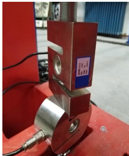
Слика 5.8. Редно везана мерна хелија уређаја са калибрационом мерном хелијом
