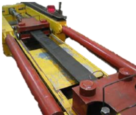
Слика 2.50. Испитивање споја насталог вулканизацијом
