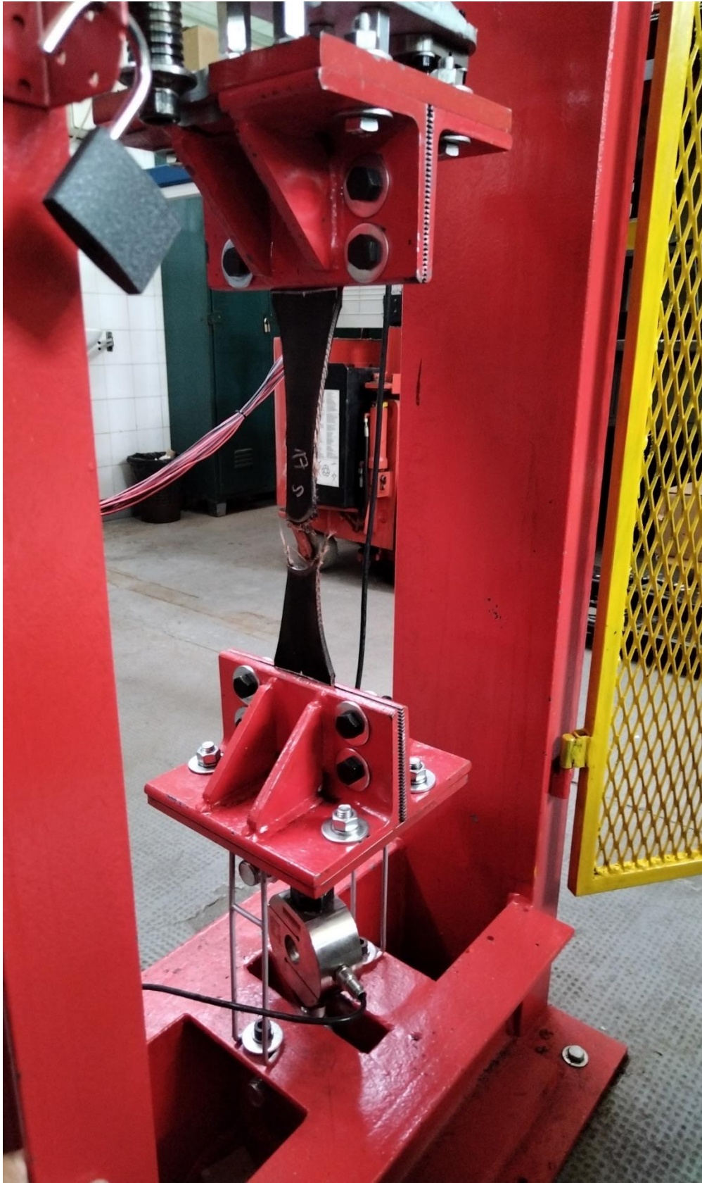
Слика 6.10. Узорак покидан током аксијалног статичког испитивања
