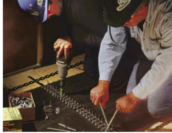
Слика 2.29. Механичко повезивање крајева траке
