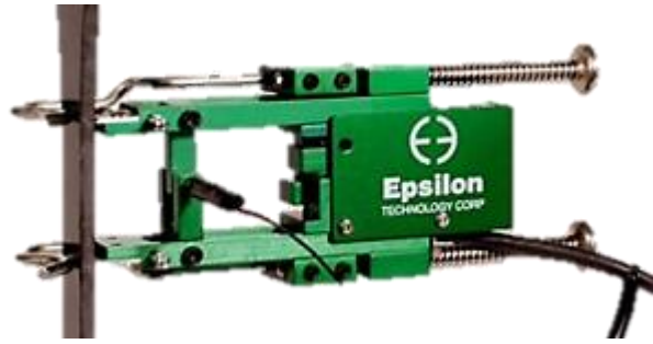
Слика 2.46. Испитивање еластичне деформације узорка
