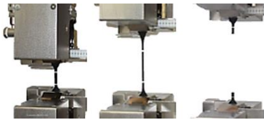
Слика 2.43. Испитивање затезне чврстоће узорка
