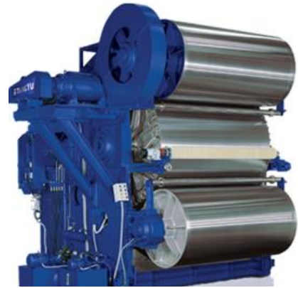
Слика 2.23. Преса за сједињавање слојева
