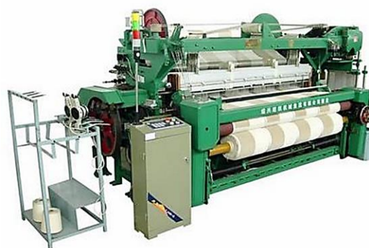
Слика 2.10. Машина за ткање текстилних носећих слојева
