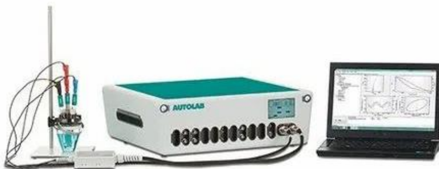
Слика 12. Изглед корозионе ћелије и потенциостата са кабловима, десно изглед поларизационих крива на рачунару (Akrabis Scientific Limited)
