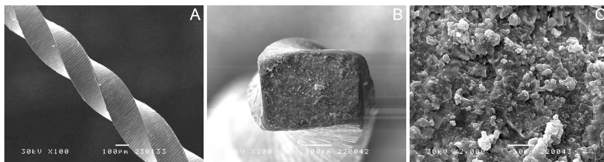
Слика 20. СЕМ приказ ProTaper Next пре излагања тесту на циклични замор на увећању \times 100 (A) и попречни пресек фрактурисаног фрагмента након излагања поменутом тесту на увећањима \times 200 (B) и \times 2000 (C)
