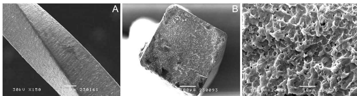
Слика 35. СЕМ микрографија кородираног HyFlex пре излагања тесту на циклични замор на увећању x150 (A) и попречни пресек фрактурисаног фрагмента након излагања поменутом тесту на увећањима x200 (B) и x2000 (C)
