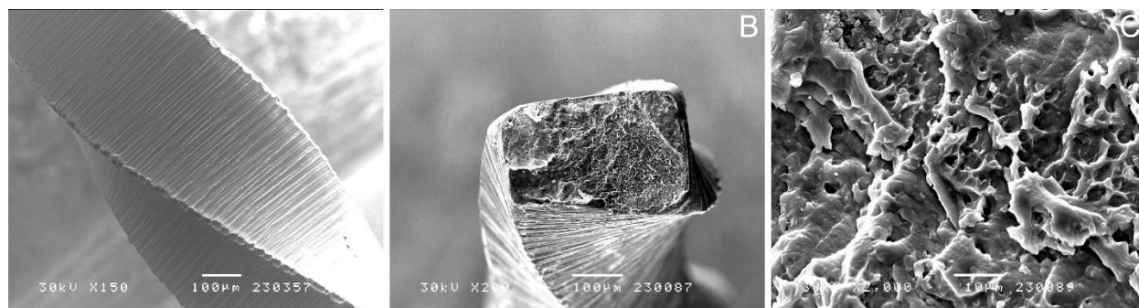
Слика 34. СЕМ микрографија кородираног WaveOne Gold пре излагања тесту на циклични замор на увећању x100 (A) и попречни пресек фрактурисаног фрагмента након излагања поменутом тесту на увећањима x200 (B) и x2000 (C)
