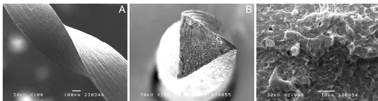
Слика 21. СЕМ приказ Twisted file пре излагања тесту на циклични замор на увећању \times 100 (A) и попречни пресек фрактурисаног фрагмента након излагања поменутом тесту на увећањима \times 200 (B) и \times 2000 (C)
