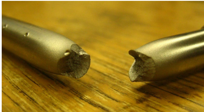
Slika 27 - Plastični lom koji pokazuje lokalno stanjivanje i nepravilnu površinu loma [43]
