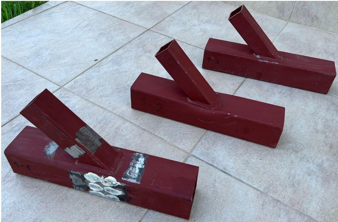
Slika 95 - Neoštećen uzorak - uporedni prikaz uzoraka 1, 2 i 3 nakon ispitivanja
