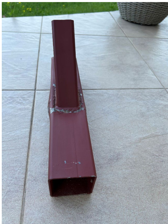
Slika 98 - Uzorak br. 3 sa oštećenjem 2 - lokalne deformacije
