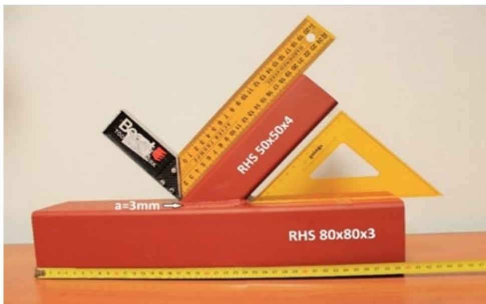
Slika 75 - Geometrija neoštećenog uzorka [108]
