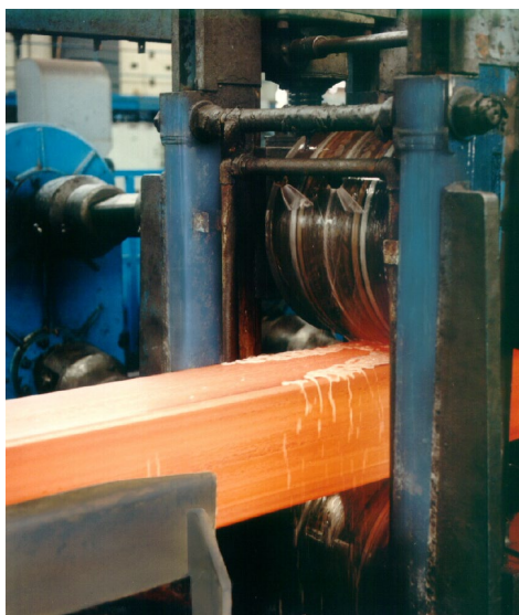
Slika 1 - Proizvodnja šupljih profila pravougaonog poprečnog preseka [22]
