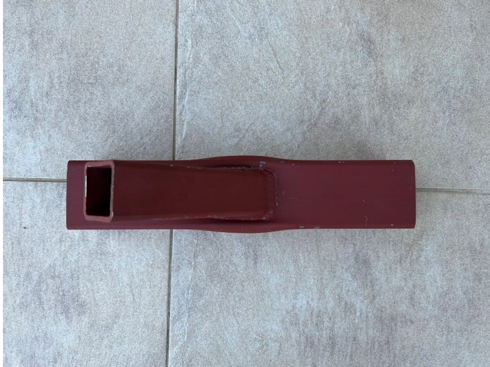
Slika 94 - Neoštećen uzorak br. 3 - lokalne deformacije
