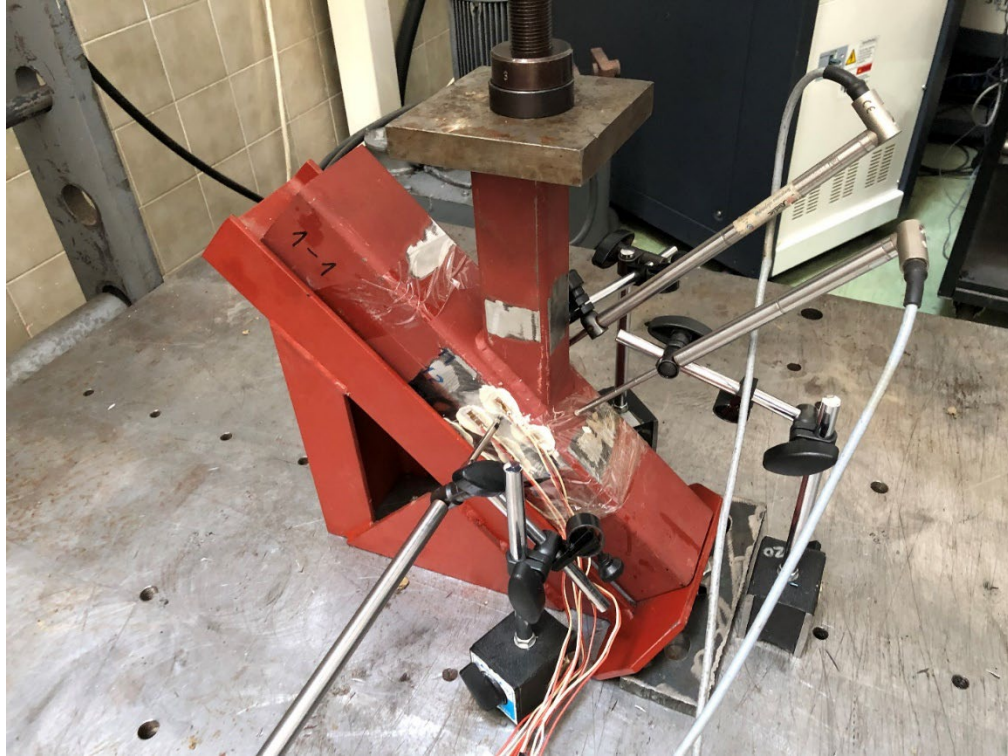
Slika 92 - Neoštećen uzorak br. 1 - lokalne deformacije
