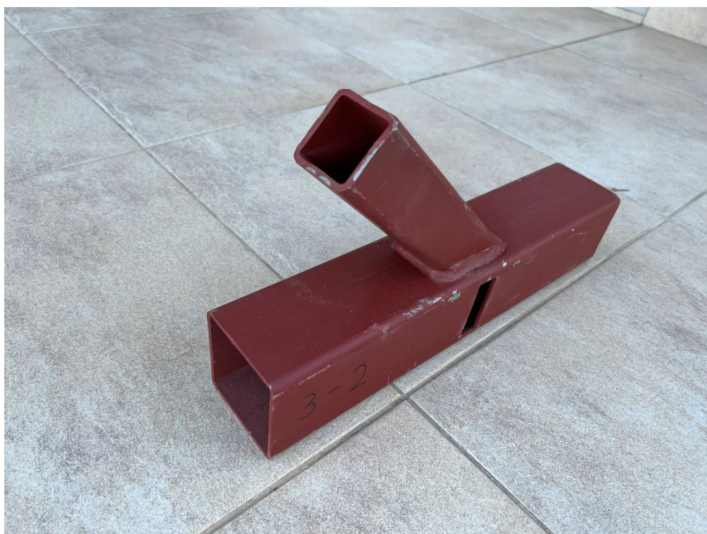
Slika 101 - Uzorak br. 2 sa oštećenjem 4 - lokalne deformacije
