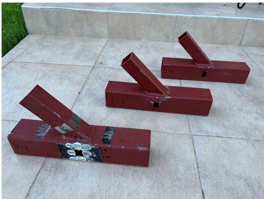
Slika 99 - Uzorci sa oštećenjem 2 - uporedni prikaz uzoraka 1, 2 i 3 nakon ispitivanja
