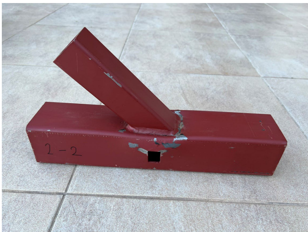
Slika 97 - Uzorak br. 2 sa oštećenjem 2 - lokalne deformacije
