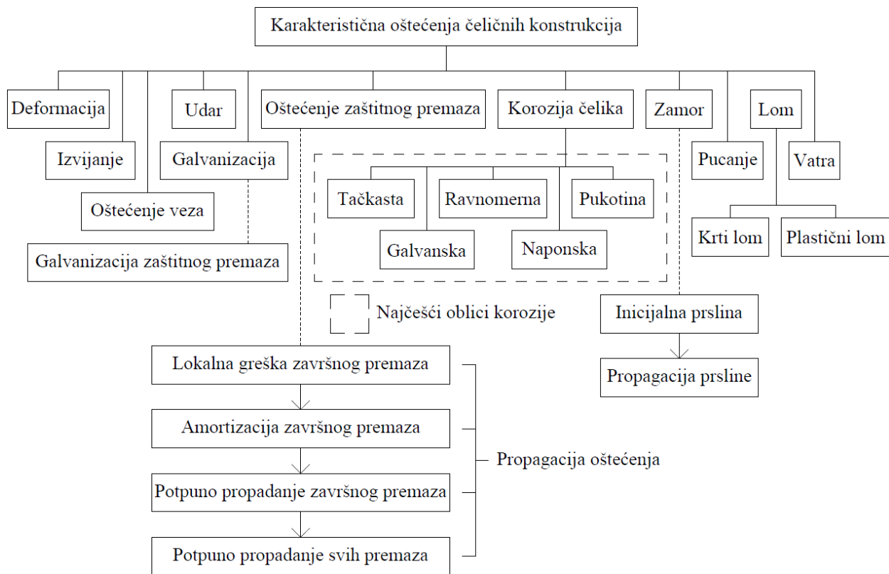
Slika 26 - Karakteristična oštećenja čeličnih konstrukcija [78]
