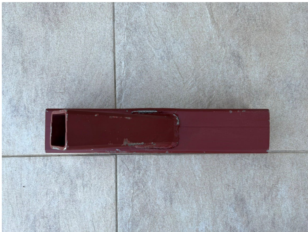
Slika 102 - Uzorak br. 3 sa oštećenjem 4 - lokalne deformacije
