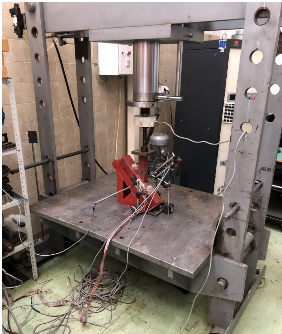
Slika 76 - Hidraulična presa nosivosti 100 t na univerzalnom ramu u Laboratoriji za Mehatroniku na Mašinskom fakultetu Univerziteta u Nišu
