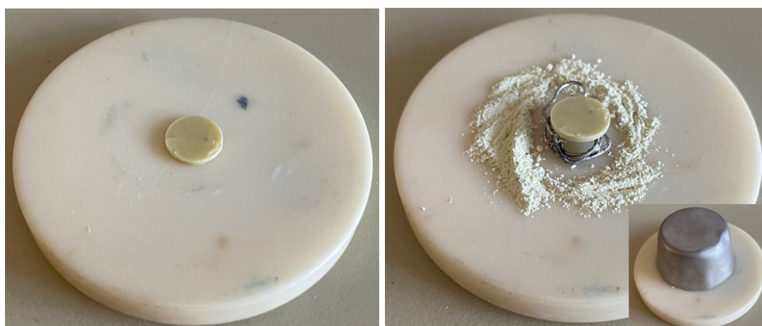
(a) Sinterovanje uzorka postavljenog na držač od alumine
