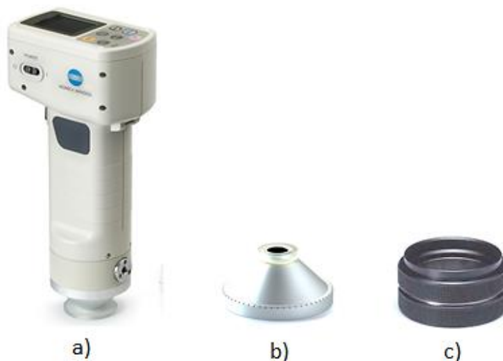
Slika 18. Instrumentalno merenje površinske boje: a) merni uređaj Konica Minolta CR400, b) dodatnik CR-A33f sa zaštitnim staklom i c) dodatnik za praškaste uzorke CR-A50.
