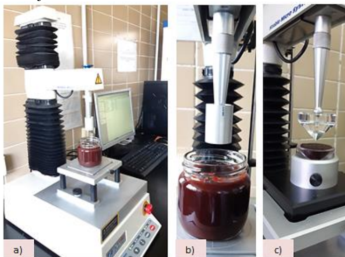
Slika 19. Analizatora teksture TA.XTplus Texture Analyser (StableMicro Systems, UK) (a) opremljen sa cilindričnom sondom P/1R (b) i konusnim mernim elementom za određivanje mazivosti - TTC Spreadability RIG, HDP/SR (c)
