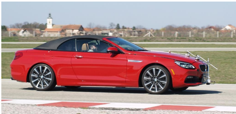
Слика 4.14 Давач Kistler Correvit S-350 Aqua постављен на предњи део возила
