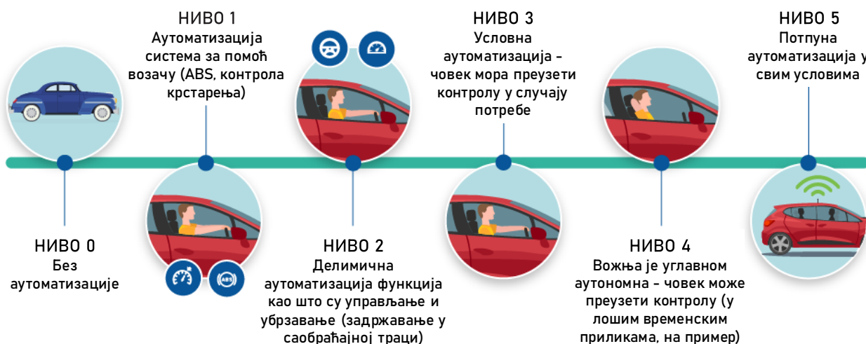
Слика 1.21 Нивои аутоматизације [41] (упрошћен приказ преузет са www.caa.ca )
