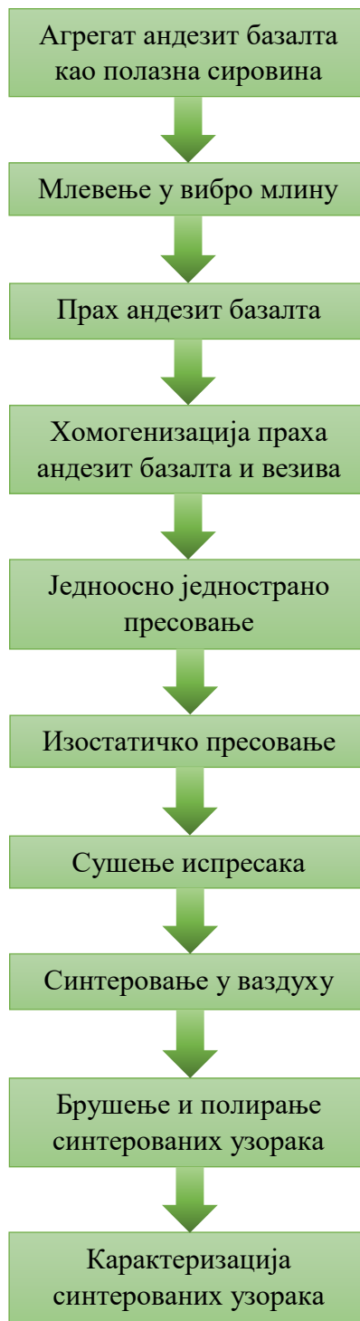
Слика 25. Шематски ток синтезе стакло-керамичких материјала
