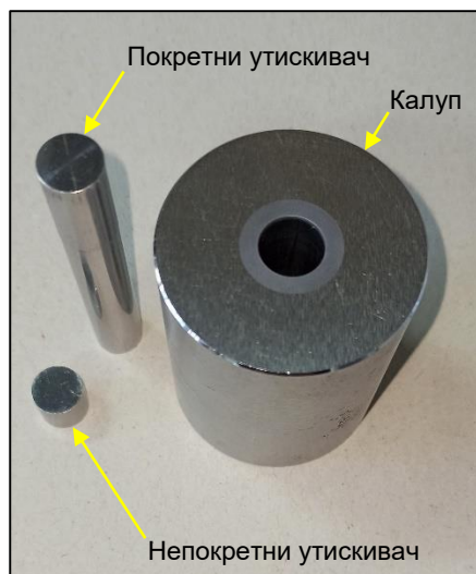
Слика 43. Алат за једноосно једнострано компактирање праха СК и СКМ
