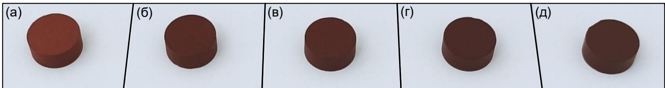
Слика 51. Промена боје СК узорак у функцији температуре синтеровања: (а) 1040 °C, (б) 1050 °C, (в) 1060 °C, (г) 1070 °C, (д) 1080 °C/60 min
