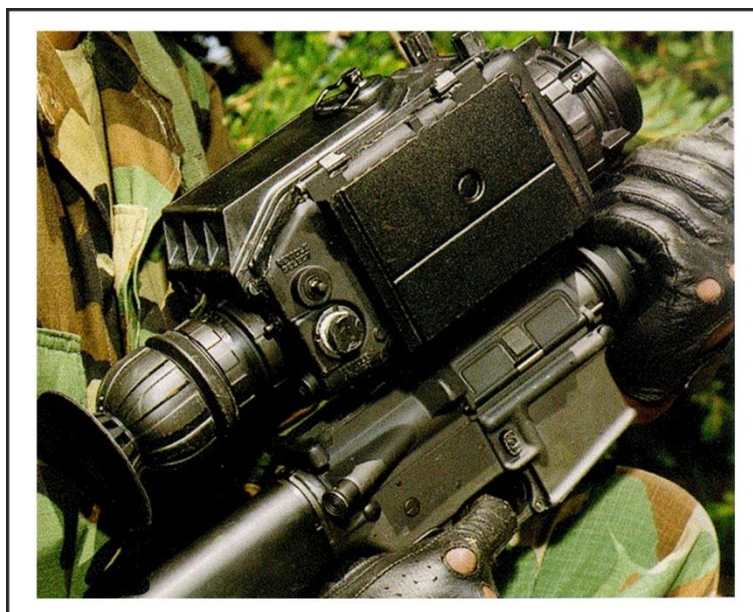
Слика 6. 4 Термовизијски уређај за пешадијско наоружање са краја 20. века
