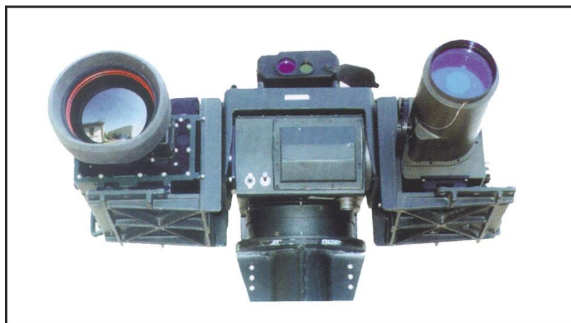
Слика 6. 7 Мултисензорска платформа за осматрање ваздушног простора у Војсци Србије
