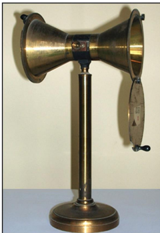
Слика 2. 1 Мелонијев термопар
