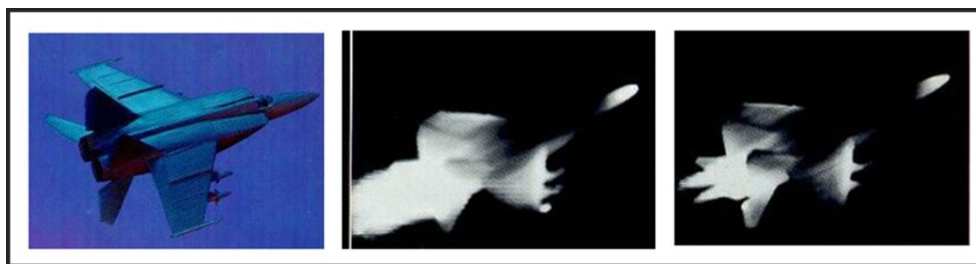
Слика 6. 6 Видљиви (плава фотографија) и термовизијски (црне слике) изглед ваздушног циља
