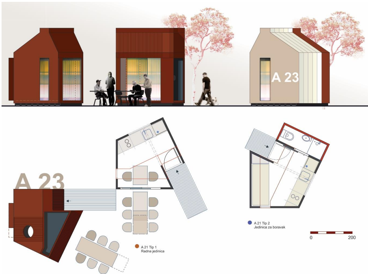
Сл. 92 Објекти А23 на локацији, могућност просторне организације јединица са комбинованим функцијама; табла 3, објекат А23; цртеж 1
