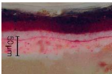
Слика бр. 53, пресек бојеног слоја са слике Лоренца Лота „Св. Катарина“, који показује пет слојева транспарентних наноса који формирају тамну црвену површину
