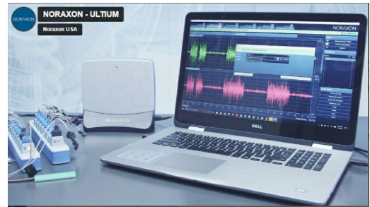
Slika 9. MA-400 EMG i Ultium EMG sistem (koji sadrži i integrisane IMU jedinice) [slika zvanično dobijena ljubaznošću Motion Lab Systems i Noraxon tima].
