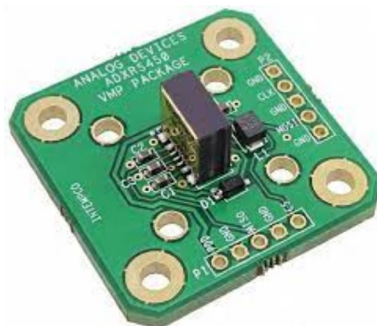
Slika 6. EVAL-ADXRS450 žiroskop [slika zvanično dobijena ljubaznošću Analog Devices, Inc. tima].
