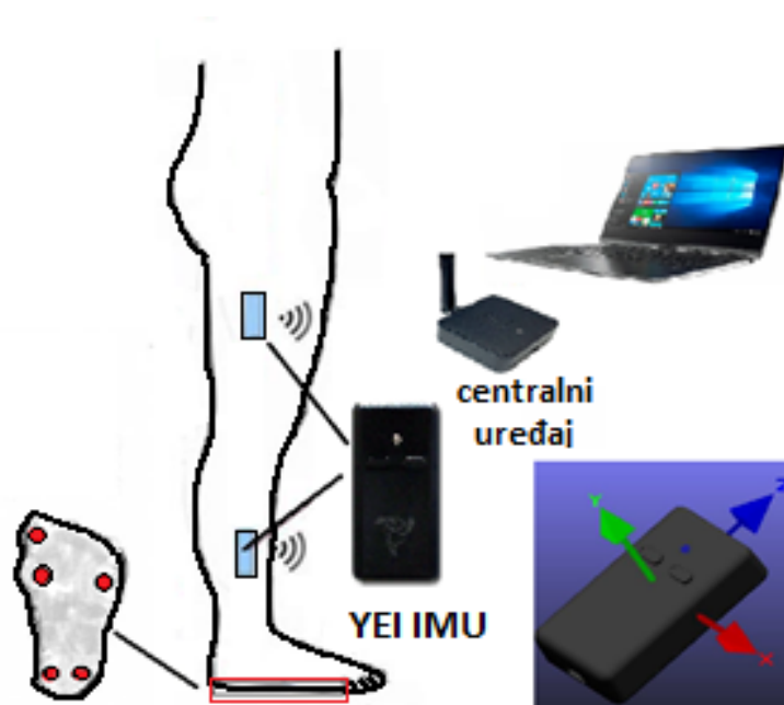
Slika 10. Šema sistema korišćenog u studiji. Walky jedinice bežično komuniciraju sa centralnim uređajem koji je povezan sa računarom. Prikazana je orijentacija osa IMU (slika dole desno). Slika je preuzeta iz rada [Gavrilović, 2018] i modifikovana.
