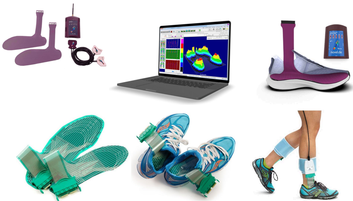
Slika 4. PEDAR ulošci (gornja slika) i Tekscan ulošci (donja slika) [slike zvanično dobijene ljubaznošću Novel i Tekscan tima].
