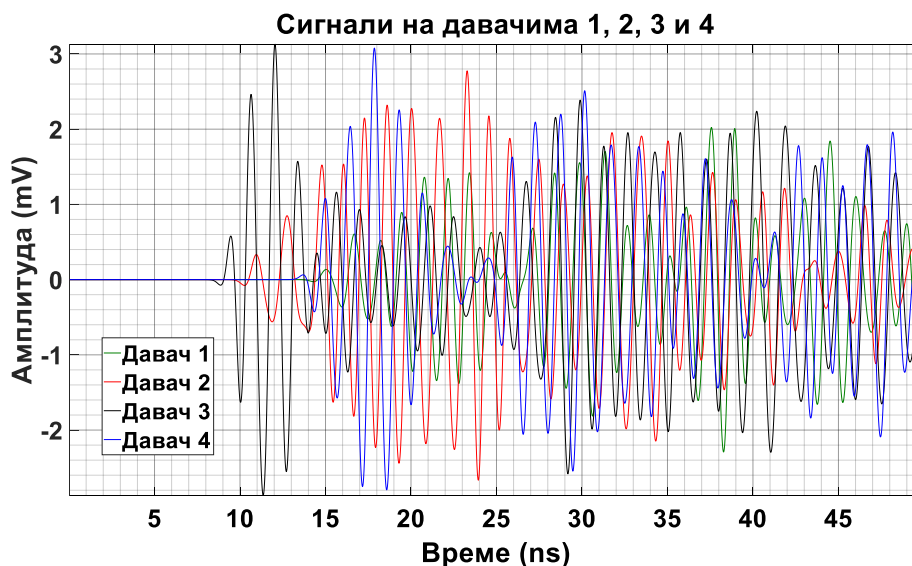
Слика 6.20 – Прикази сигнала парцијалних пражњења на одговарајућим UHF давачима према слици 6.19.
