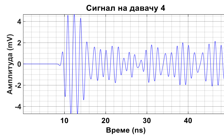
Слика 6.41 – Прикази појединачних сигнала парцијалних пражњења на UHF давачима 1–4 који су кренули из извора I_3 на слици 6.39.
