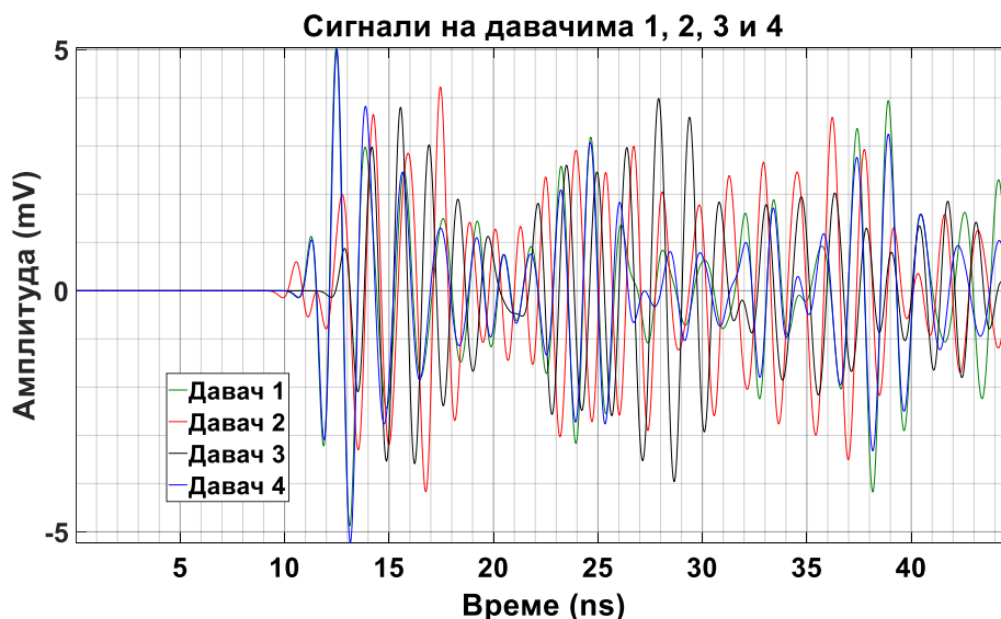
Слика 6.30 – Прикази сигнала парцијалних пражњења на одговарајућим UHF давачима 1–4 према слици 6.29.
