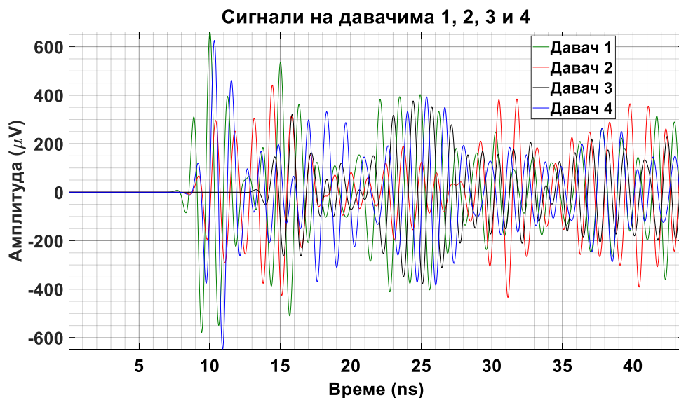
Слика 6.53 – Прикази сигнала парцијалних пражњења на одговарајућим UHF давачима према слици 6.52.
