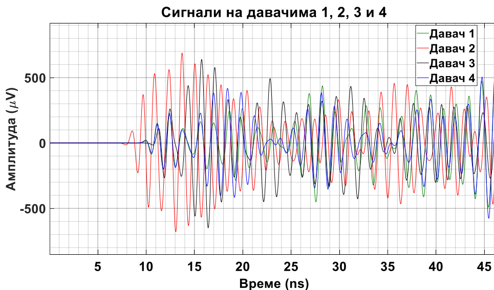
Слика 6.43 – Прикази сигнала парцијалних пражњења на одговарајућим UHF давачима 1–4 према слици 6.42.
