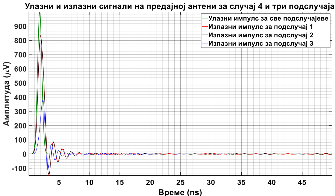
Слика 6.55 – Улазни побудни сигнал предајне антене за све подслучајеве конструкције енергетског трансформатора и излазни побудни сигнали са предајне антене за сваки (упрошћени, сложенији и сложени) подслучај посебно.
