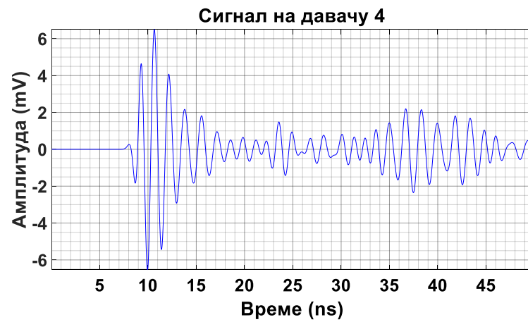
Слика 6.91 – Прикази појединачних сигнала парцијалних пражњења на UHF давачима 1–4 који су кренули из извора I_8 на слици 6.89.
