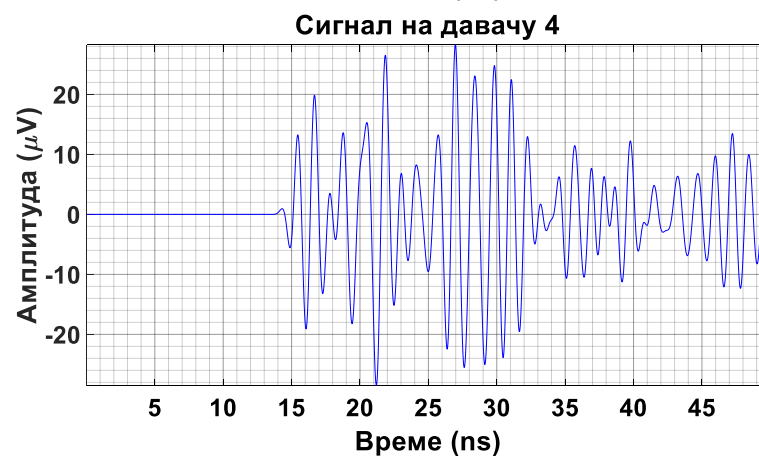
Слика 6.134 – Прикази појединачних сигнала парцијалних пражњења на UHF давачима 1–4 који су кренули из извора I_{12} на слици 6.132.
