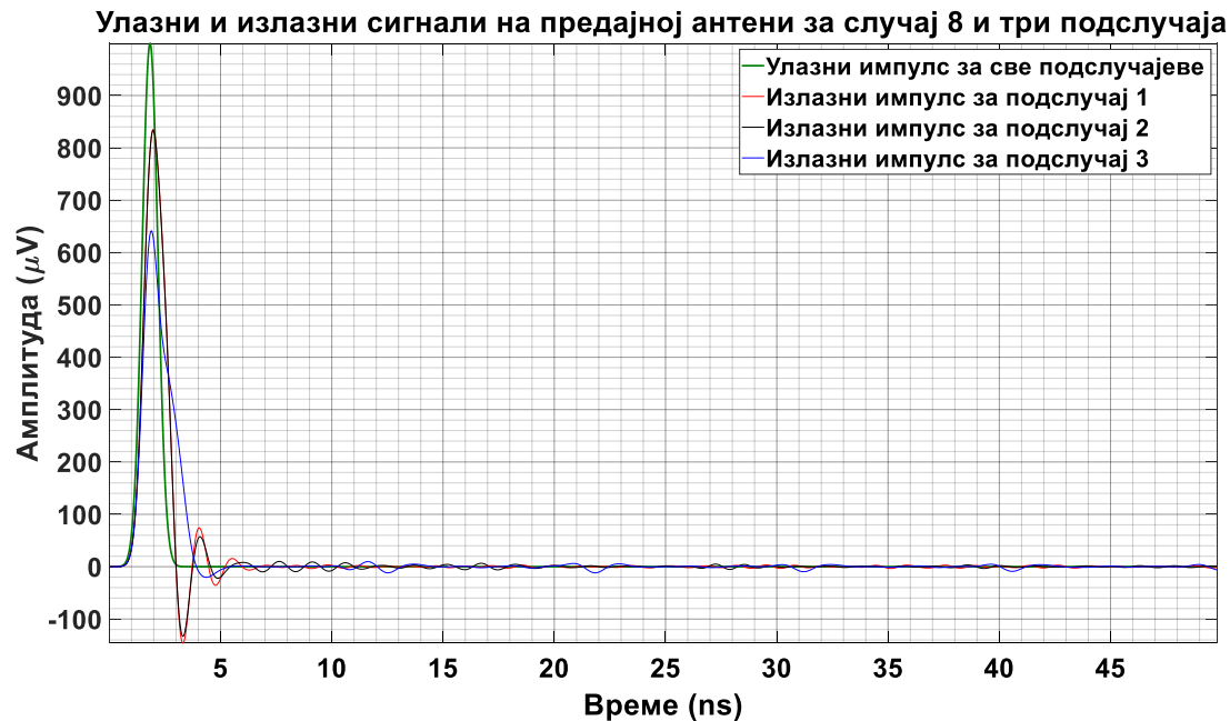
Слика 6.95 – Улазни побудни сигнал предајне антене за све подслучајеве конструкције енергетског трансформатора и излазни побудни сигнали са предајне антене за сваки (упрошћени, сложенији и сложени) подслучај посебно.
