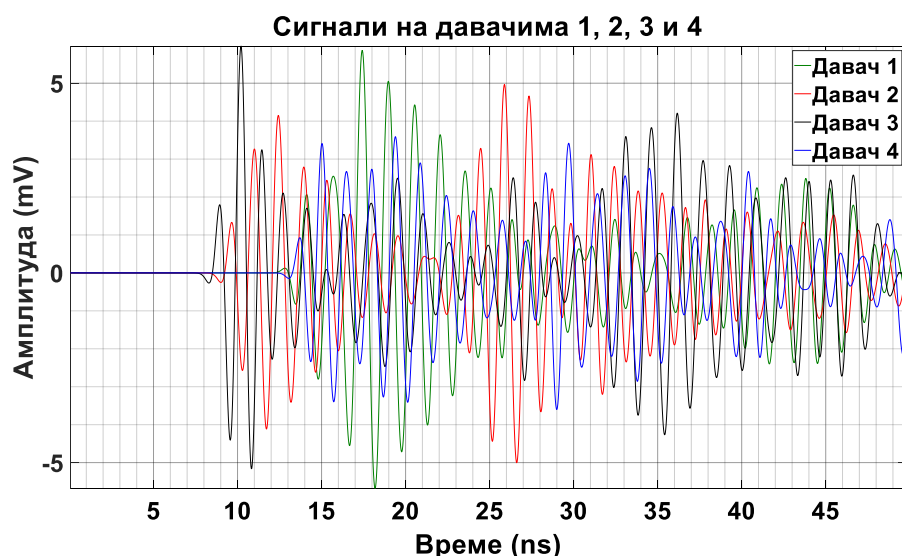
Слика 6.107 – Прикази сигнала парцијалних пражњења на давачима према слици 6.106.
