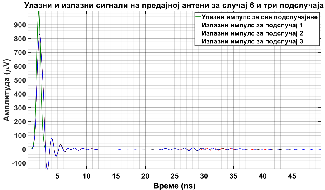
Слика 6.75 – Улазни побудни сигнал предајне антене за све подслучајеве конструкције енергетског трансформатора и излазни побудни сигнали са предајне антене за сваки (упрошћени, сложенији и сложени) подслучај посебно.
