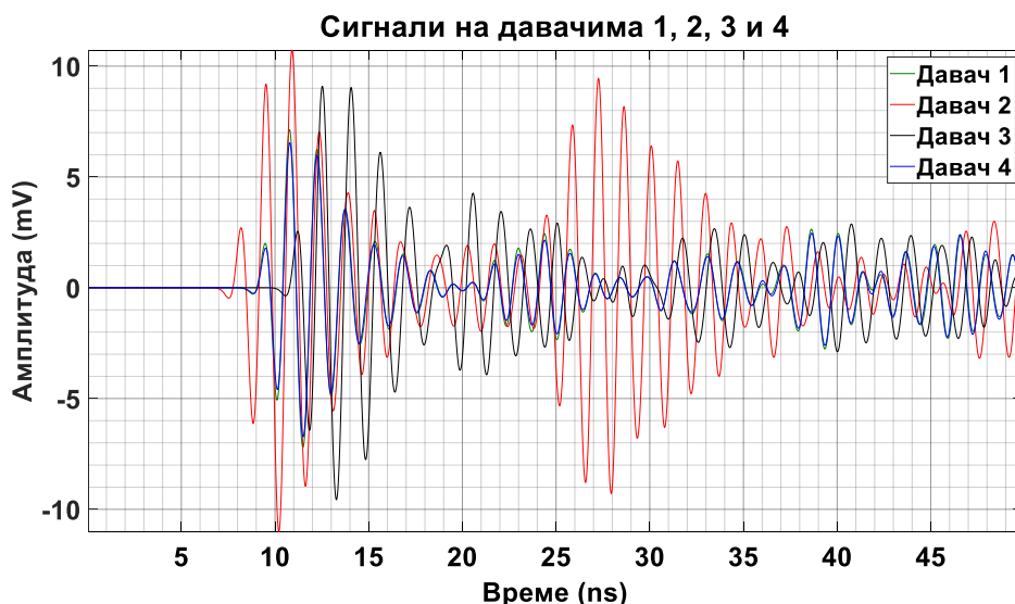
Слика 6.37 – Прикази сигнала парцијалних пражњења на давачима према слици 6.36.
