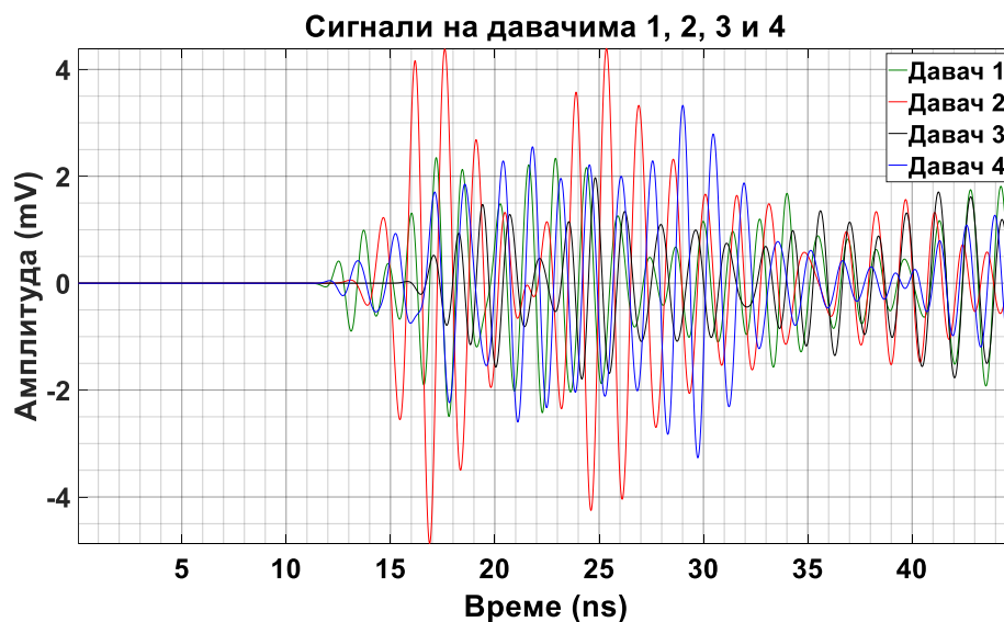
Слика 6.120 – Прикази сигнала парцијалних пражњења на одговарајућим UHF давачима према слици 6.119.
