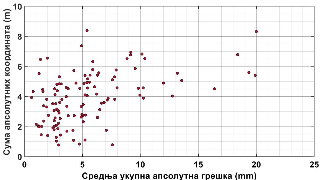
Слика 5.44 – Збир апсолутних вредности координата зависно од средње укупне апсолутне грешке положаја извора парцијалног пражњења за 120 произвољно изабраних тачака извора парцијалних пражњења, за сигнал задатог облика и праг у износу од [20 – 29] % вредности врха највеће амплитуде сигнала.
