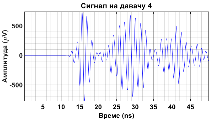
Слика 6.64 – Прикази појединачних сигнала парцијалних пражњења на UHF давачима 1–4 који су кренули из извора I_5 на слици 6.62.
