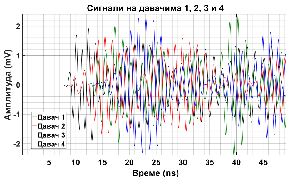
Слика 6.110 – Прикази сигнала парцијалних пражњења на одговарајућим UHF давачима према слици 6.109.
