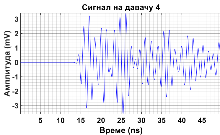
Слика 6.131 – Прикази појединачних сигнала парцијалних пражњења на UHF давачима 1–4 који су кренули из извора I_{12} на слици 6.129.
