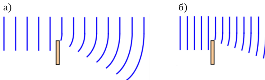
Слика Г.7 – Савијање таласа око ивице. а) Већа таласна дужина таласа доводи до веће дифракције. б) Мања таласна дужина таласа доводи до мањег савијања (12-14) .
