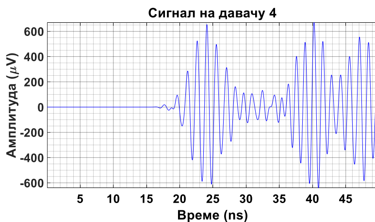
Слика 6.144 – Прикази појединачних сигнала парцијалних пражњења на UHF давачима 1–4 који су кренули из извора I_{13} на слици 6.142.
