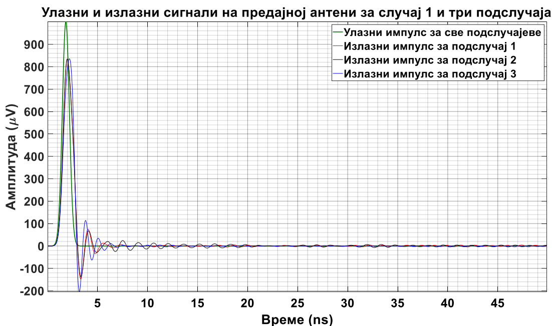
Слика 6.25 – Улазни побудни сигнал предајне антене за све подслучајеве конструкције енергетског трансформатора и излазни побудни сигнали са предајне антене за сваки (упрошћени, сложенији и сложени) подслучај посебно.
