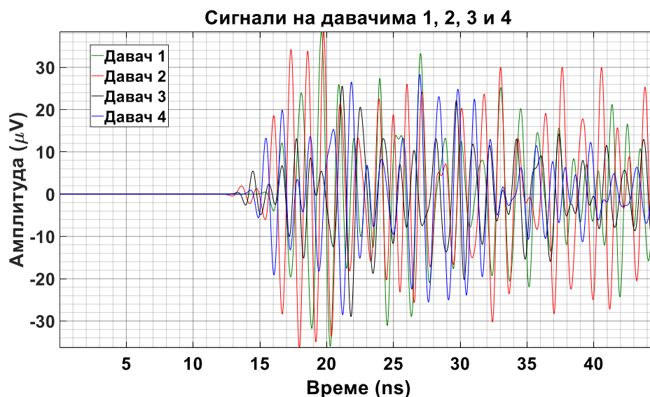
Слика 6.133 – Прикази сигнала парцијалних пражњења на одговарајућим UHF давачима према слици 6.132.
