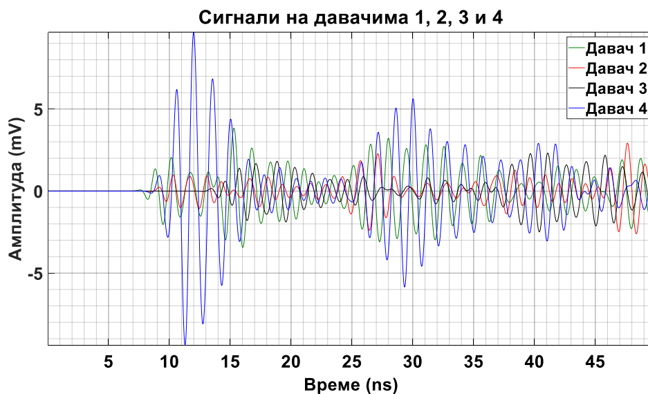
Слика 6.50 – Прикази сигнала парцијалних пражњења на одговарајућим давачима према слици 6.49.
