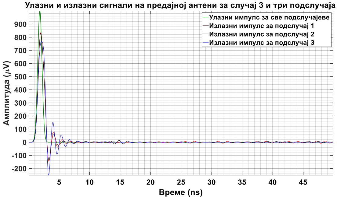
Слика 6.45 – Улазни побудни сигнал предајне антене за све подслучајеве конструкције енергетског трансформатора и излазни побудни сигнали са предајне антене за сваки (упрошћени, сложенији и сложени) подслучај посебно.
