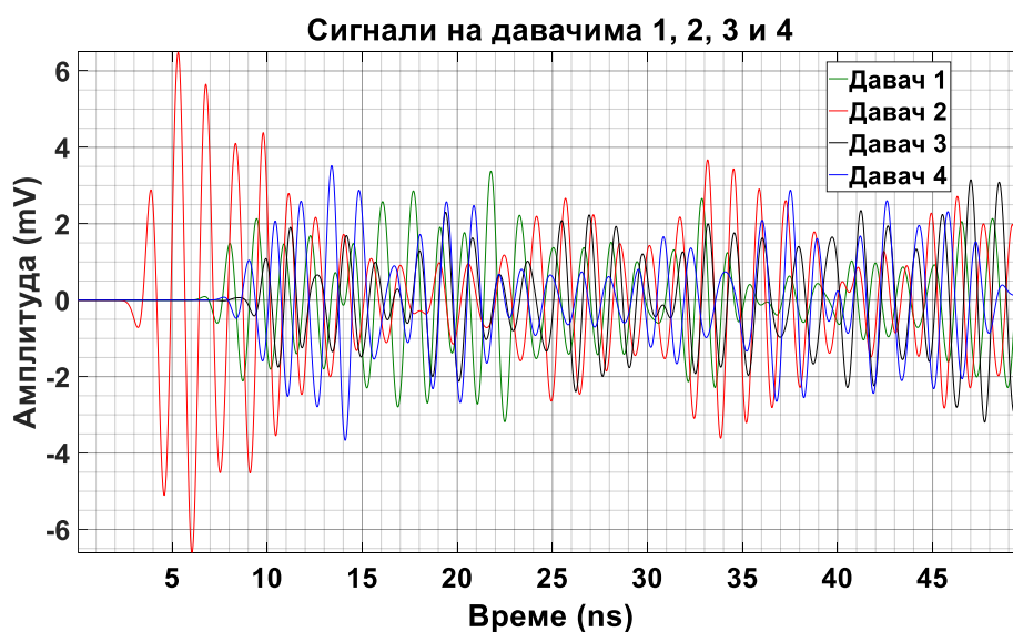
Слика 6.80 – Прикази сигнала парцијалних пражњења на одговарајућим UHF давачима према слици 6.79.
