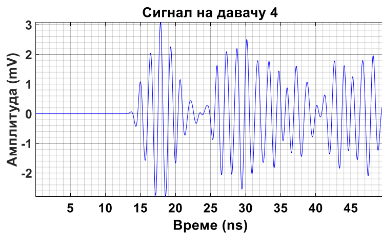
Слика 6.21 – Прикази појединачних сигнала парцијалних пражњења на UHF давачима 1–4 који су кренули из извора I_1 на слици 6.19.
