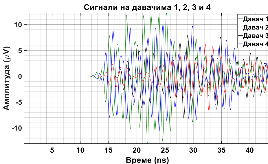
Слика 6.123 – Прикази сигнала парцијалних пражњења на одговарајућим UHF давачима према слици 6.122.
