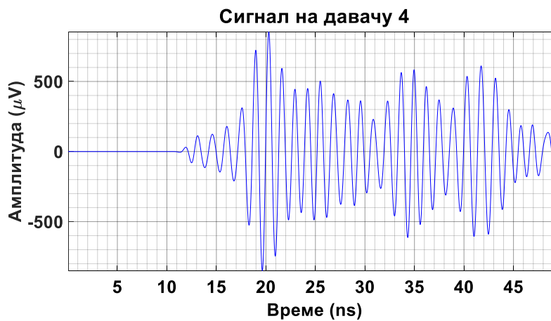
Слика 6.34 – Прикази појединачних UHF сигнала парцијалних пражњења на UHF давачима 1–4 који су кренули из извора I_2 на слици 6.32.
