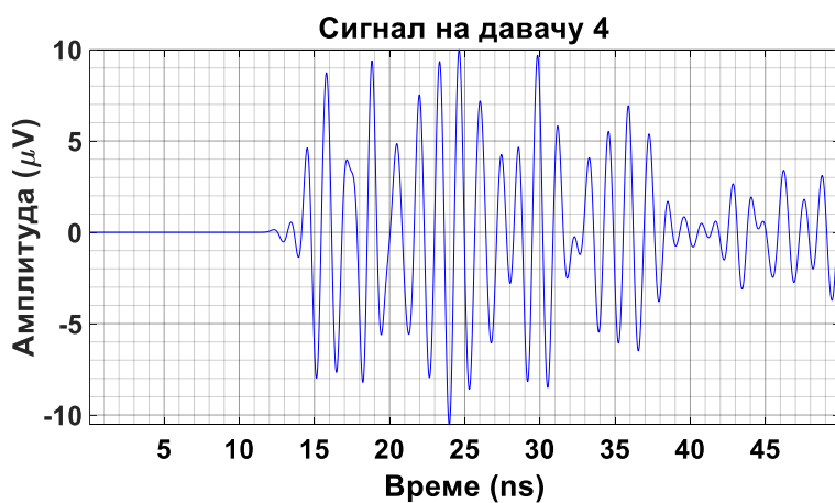
Слика 6.124 – Прикази појединачних сигнала парцијалних пражњења на UHF давачима 1–4 који су кренули из извора I_{11} на слици 6.122.
