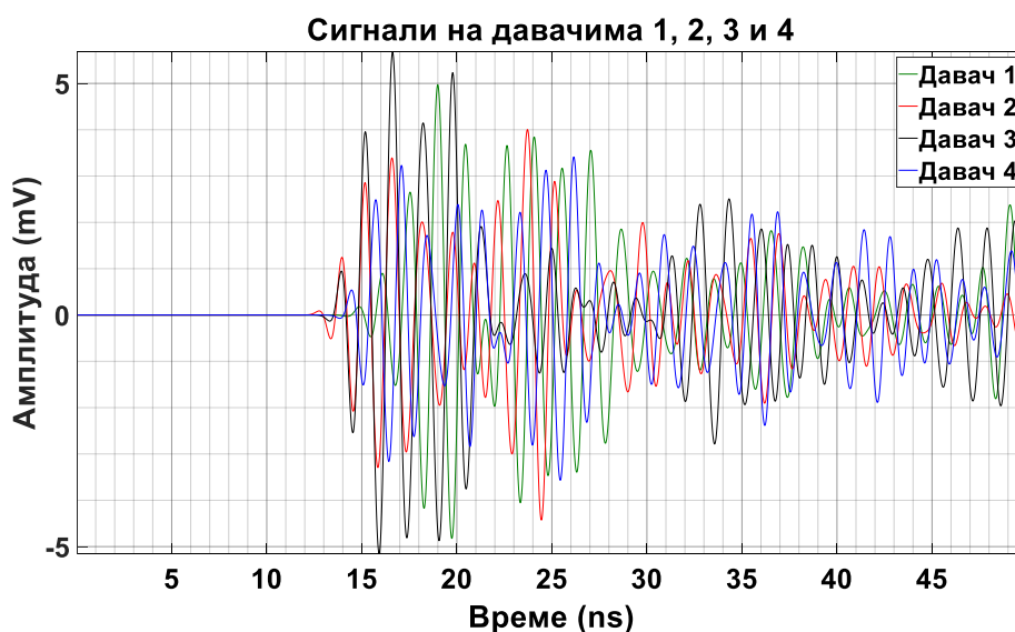
Слика 6.130 – Прикази сигнала парцијалних пражњења на одговарајућим UHF давачима према слици 6.129.
