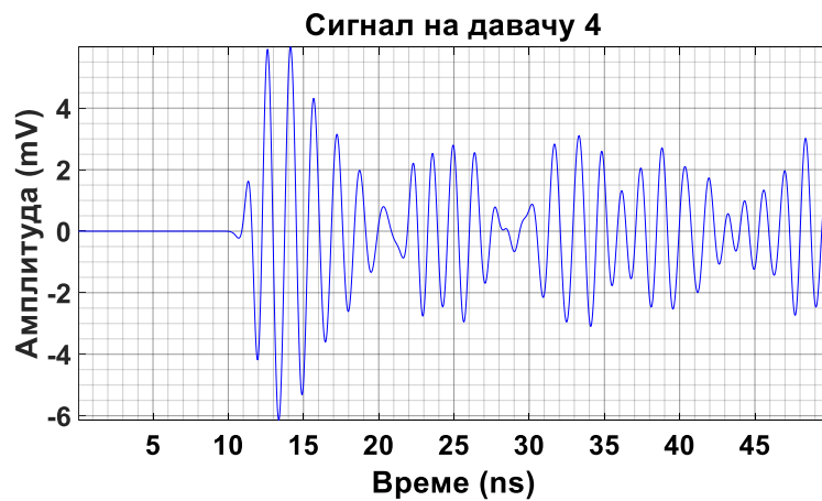
Слика 6.28 – Прикази појединачних сигнала парцијалних пражњења на UHF давачима 1–4 који су кренули из извора I_2 на слици 6.26.
