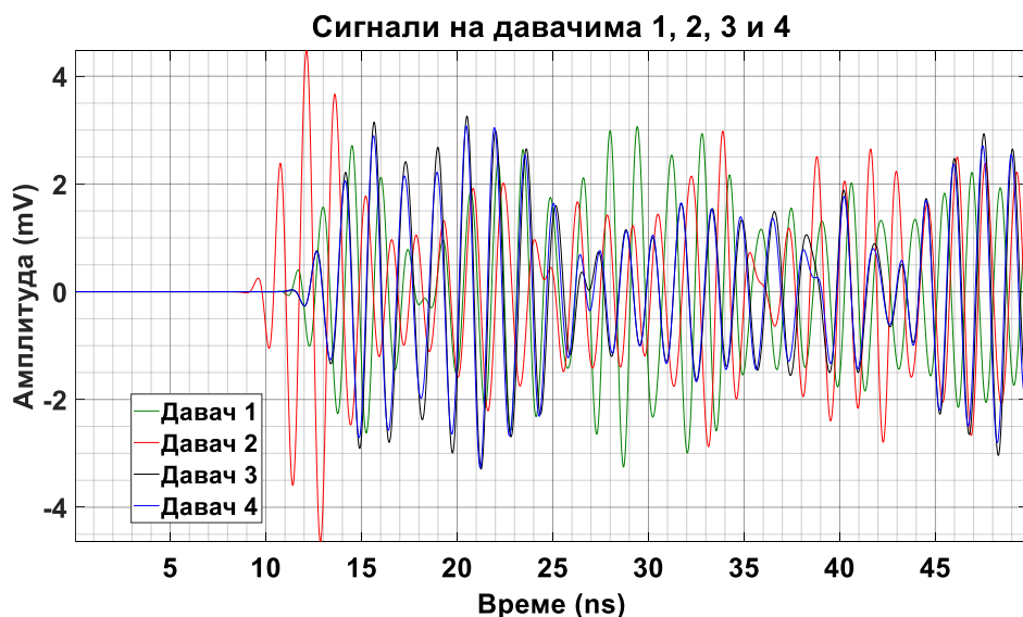
Слика 6.60 – Прикази сигнала парцијалних пражњења на одговарајућим UHF давачима према слици 6.59.
