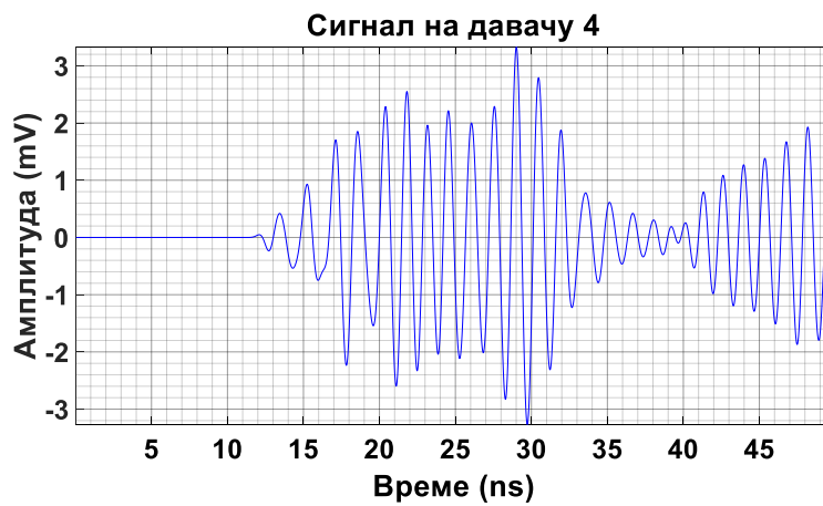
Слика 6.121 – Прикази појединачних сигнала парцијалних пражњења на UHF давачима 1–4 који су кренули из извора I_{11} на слици 6.119.
