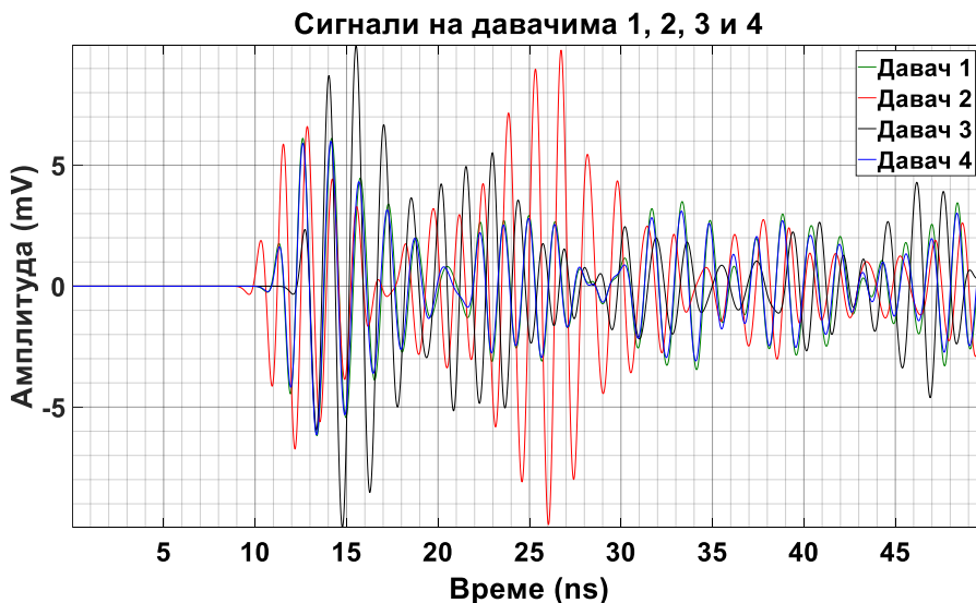
Слика 6.27 – Прикази сигнала парцијалних пражњења на давачима 1–4 са слике 6.26.
