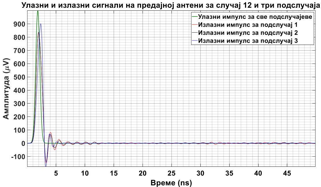
Слика 6.135 – Улазни побудни сигнал предајне антене за све подслучајеве конструкције енергетског трансформатора и излазни побудни сигнали са предајне антене за сваки (упрошћени, сложенији и сложени) подслучај посебно.
