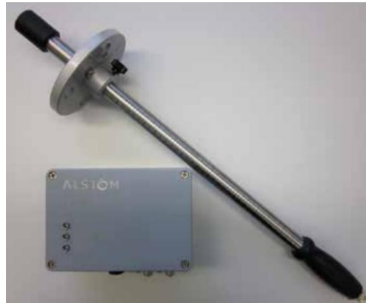
Слика 2.13 – а) UHF давач у облику сонде монтиран кроз пропусни уљни вентил DN50 . б) Уређај за непрекидно надгледање парцијалних пражњења у погону у разводном орману. в) Дијаграм фазно разложених амплитуда парцијалних пражњења [155]. г) UHF једнополни давач за проточни уљни вентил и електроника за непрекидно надгледање UHF парцијалних пражњења у погону [156].
