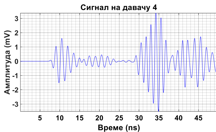
Слика 6.78 – Прикази појединачних сигнала парцијалних пражњења на UHF давачима 1–4 који су кренули из извора I_7 на слици 6.76.
