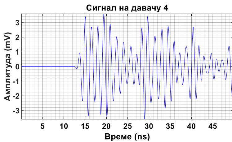
Слика 6.108 – Прикази појединачних сигнала парцијалних пражњења на UHF давачима 1–4 који су кренули из извора I_{10} на слици 6.106.
