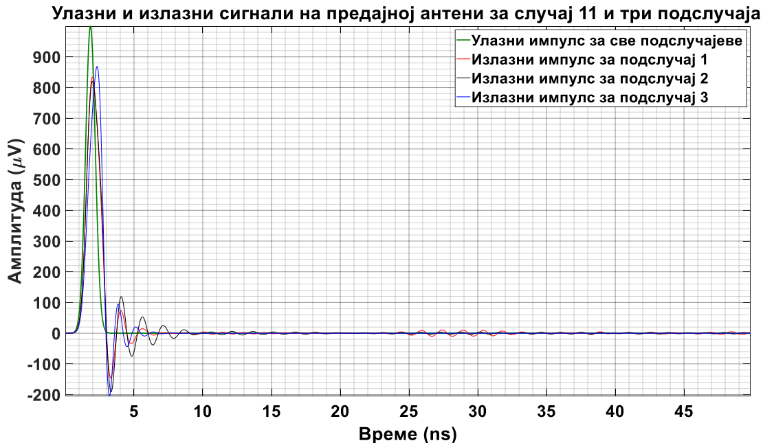
Слика 6.125 – Улазни побудни сигнал предајне антене за све подслучајеве конструкције енергетског трансформатора и излазни побудни сигнали са предајне антене за сваки (упрошћени, сложенији и сложени) подслучај посебно.
