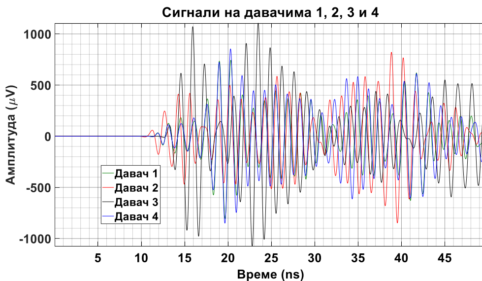
Слика 6.33 – Прикази сигнала парцијалних пражњења на одговарајућим UHF давачима према слици 6.32.
