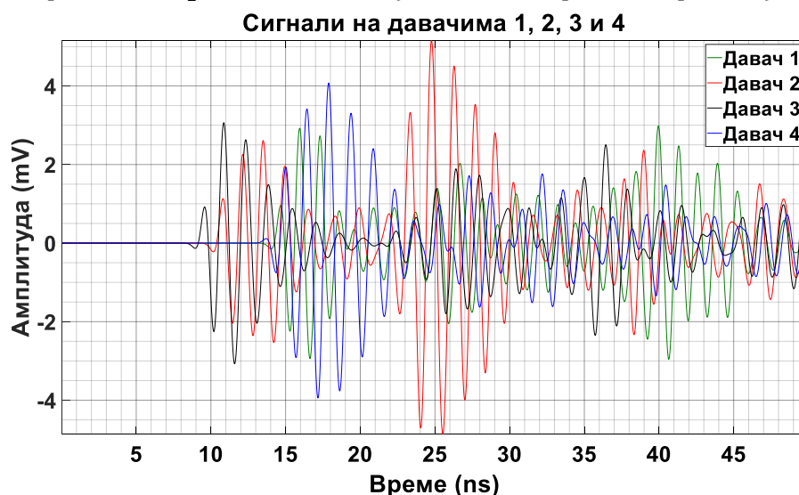
Слика 6.17 – Прикази сигнала парцијалних пражњења на давачима 1–4 са слике 6.16.
