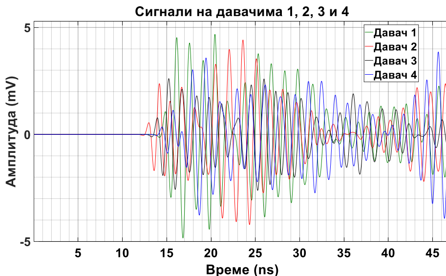
Слика 6.127 – Прикази сигнала парцијалних пражњења на давачима према слици 6.126.
