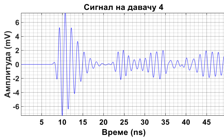
Слика 6.88 – Прикази појединачних сигнала парцијалних пражњења на UHF давачима 1–4 који су кренули из извора I_8 на слици 6.86.
