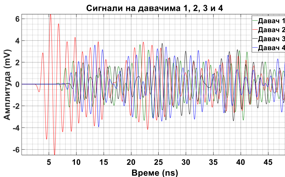
Слика 6.83 – Прикази сигнала парцијалних пражњења на одговарајућим UHF давачима према слици 6.82.
