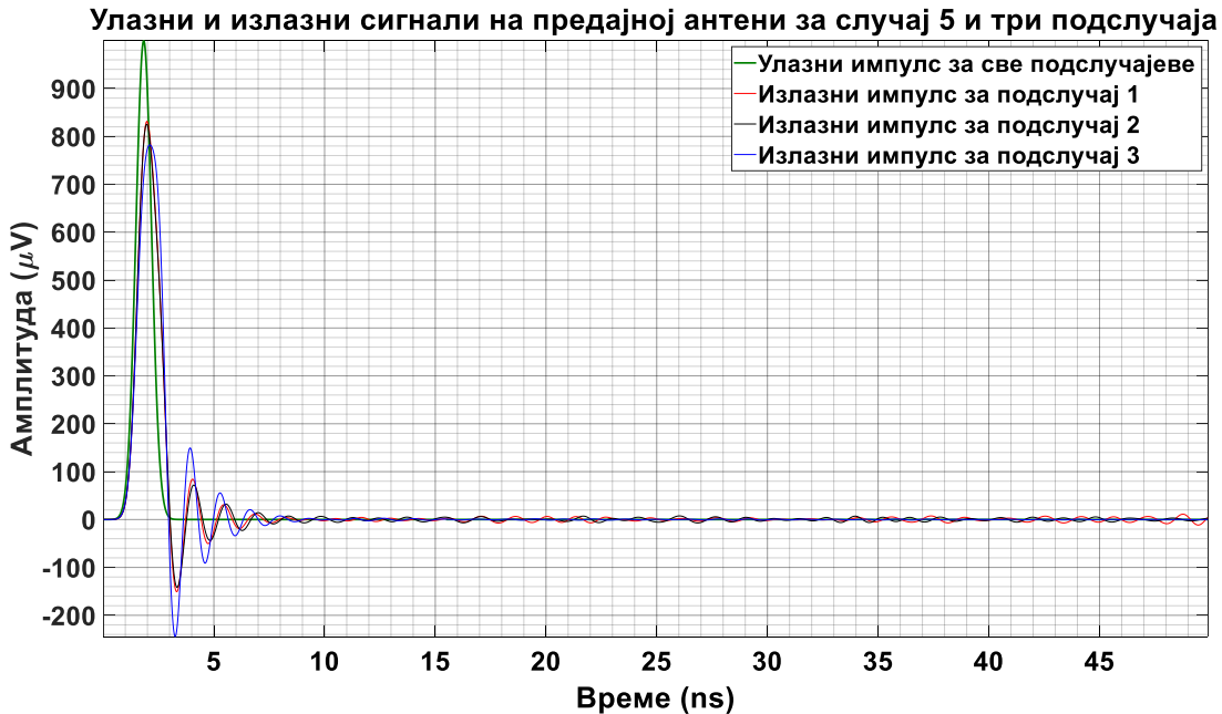
Слика 6.65 – Улазни побудни сигнал предајне антене за све подслучајеве конструкције енергетског трансформатора и излазни побудни сигнали са предајне антене за сваки (упрошћени, сложенији и сложени) подслучај посебно.
