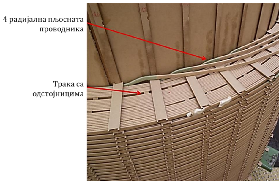
Слика В.14 – Диск намотај са вишеструким тракама, радијалним каналима за хлађење и два осна канала за хлађење (4) .
