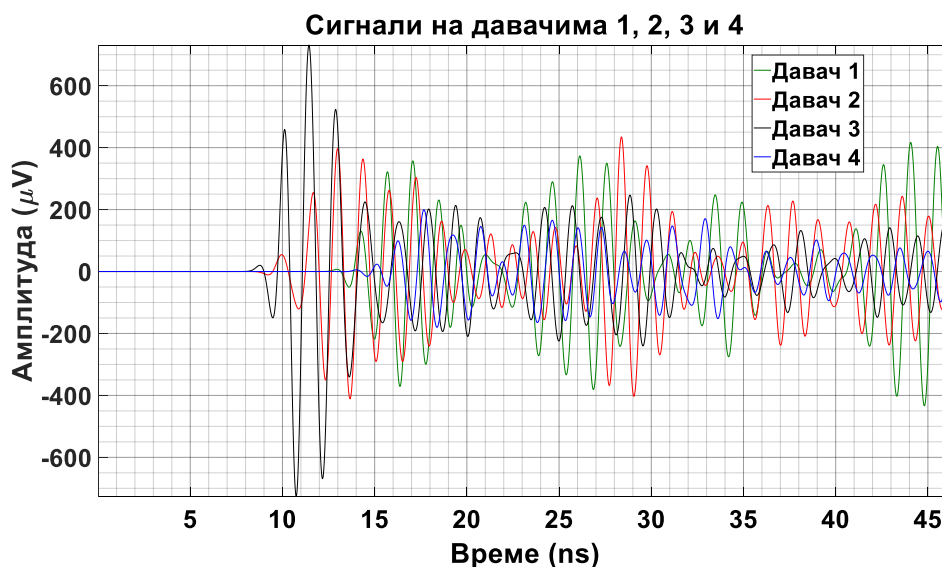
Слика 6.113 – Прикази сигнала парцијалних пражњења на одговарајућим UHF давачима према слици 6.112.
