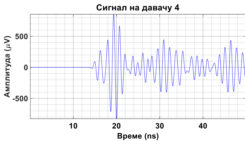
Слика 6.24 – Прикази појединачних сигнала парцијалних пражњења на UHF давачима 1–4 који су кренули из извора I_1 на слици 6.22.
