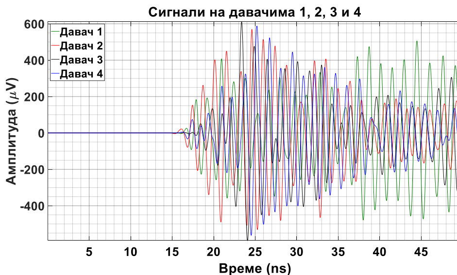
Слика 6.140 – Прикази сигнала парцијалних пражњења на одговарајућим UHF давачима према слици 6.139.
