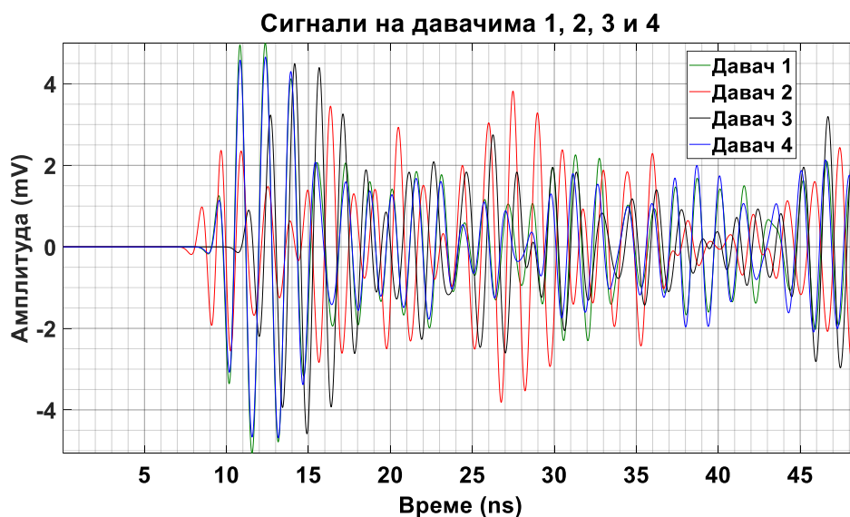
Слика 6.40 – Прикази сигнала парцијалних пражњења на одговарајућим UHF давачима према слици 6.39.
