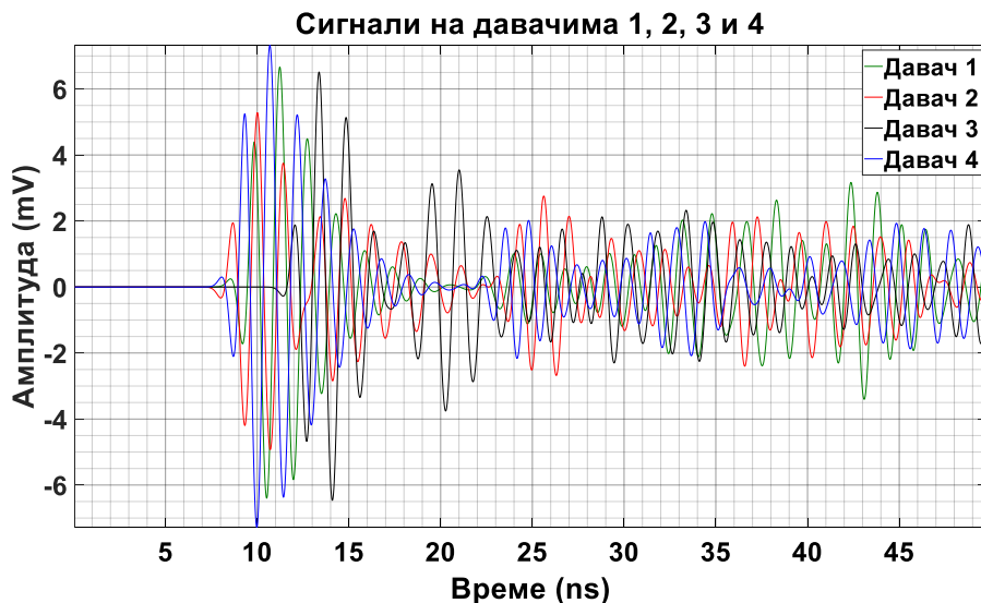
Слика 6.87 – Прикази сигнала парцијалних пражњења на давачима према слици 6.86.
