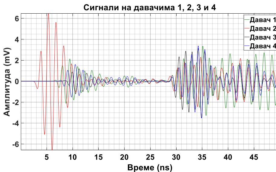
Слика 6.77 – Прикази сигнала парцијалних пражњења на давачима према слици 6.76.
