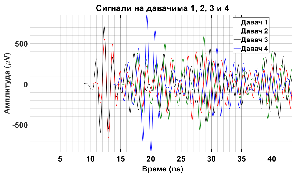
Слика 6.23 – Прикази сигнала парцијалних пражњења на одговарајућим UHF давачима према слици 6.22.
