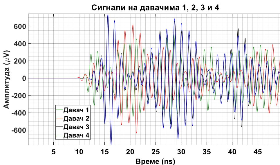
Слика 6.63 – Прикази сигнала парцијалних пражњења на одговарајућим UHF давачима према слици 6.62.
