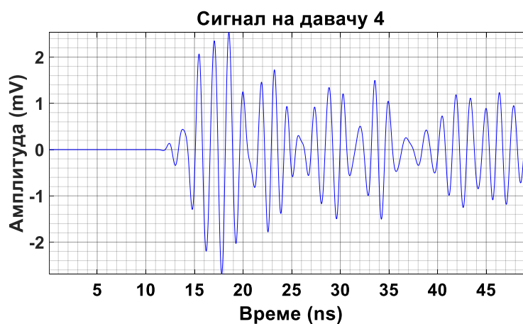
Слика 6.118 – Прикази појединачних сигнала парцијалних пражњења на UHF давачима 1–4 који су кренули из извора I_{11} на слици 6.116.
