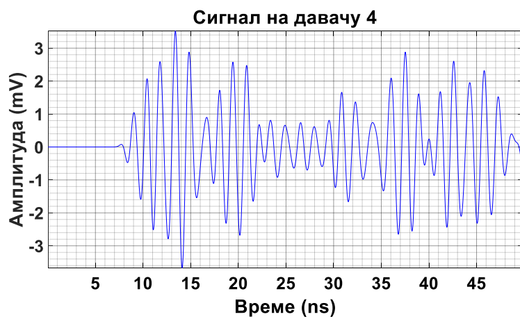
Слика 6.81 – Прикази појединачних сигнала парцијалних пражњења на UHF давачима 1–4 који су кренули из извора I_7 на слици 6.79.
