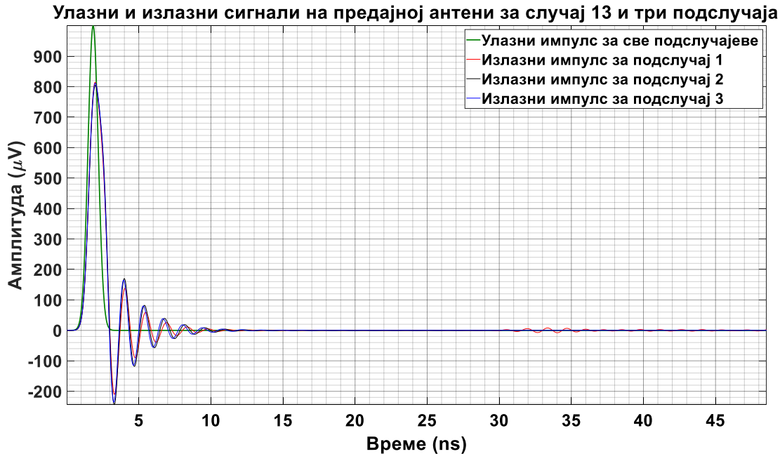
Слика 6.145 – Улазни побудни сигнал предајне антене за све подслучајеве конструкције енергетског трансформатора и излазни побудни сигнали са предајне антене за сваки (упрошћени, сложенији и сложени) подслучај посебно.
