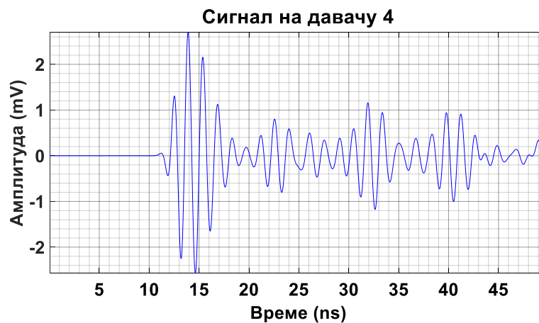
Слика 6.58 – Прикази појединачних сигнала парцијалних пражњења на UHF давачима 1–4 који су кренули из извора I_5 на слици 6.56.
