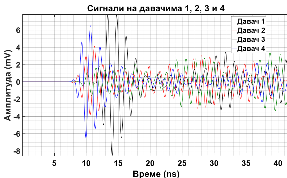
Слика 6.90 – Прикази сигнала парцијалних пражњења на одговарајућим UHF давачима према слици 6.89.
