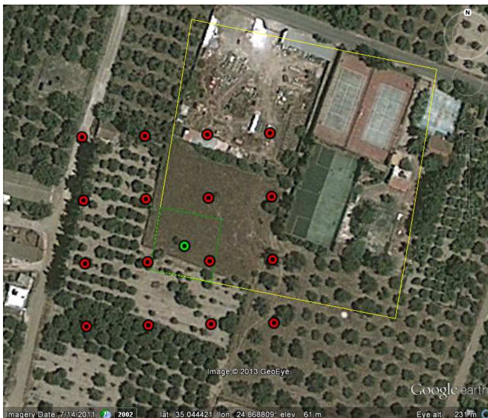
Слика 6-2. Локална пројекција ћелија грида у ETRS-LAEA пројекцији и то: 25x25 m (зелени полигон), 100x100 m (жути полигон) на локално равну површину Земље. Зелена тачка представља пројекцију центра ћелије грида 25x25 m. Црвене тачке представљају хипотетичке центре пиксела LANDSAT снимака од 25 m.
