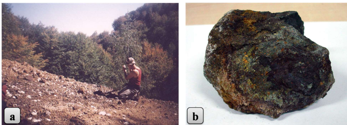
Slika 3.15. a) Halda na lokalitetu Jurija sa koje su uzeti uzorci rude (CV-J1 do CV-J4, tabela 3.1). Pojava belih skrama na haldi koja može da se zapazi na slici, predstavlja eflorescenciju (“procvetavanje”) sekundarnih minerala (uglavnom gipsa) po sulfidnoj rudi; b) reprezentativni uzorak rude (uzorak CV-J1) sa halde prikazane na slici (a) (širina uzorka ~8 cm).
