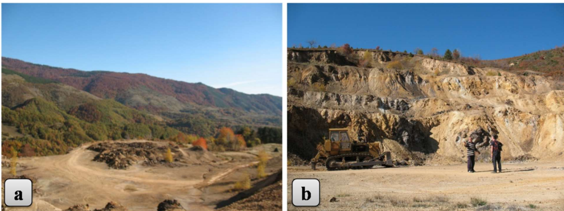
Slika 3.9. Ležište olova i cinka Sastavci: a) etaža iznad parkinga sa gomilama iskopanog materijala; b) površinski kop Sastavci.
