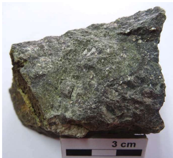
Slika 3.7. Reprezentativni uzorak (T1-6) arsenopirita (zapaziti metalični sjaj) sa lokaliteta Drenjak.
