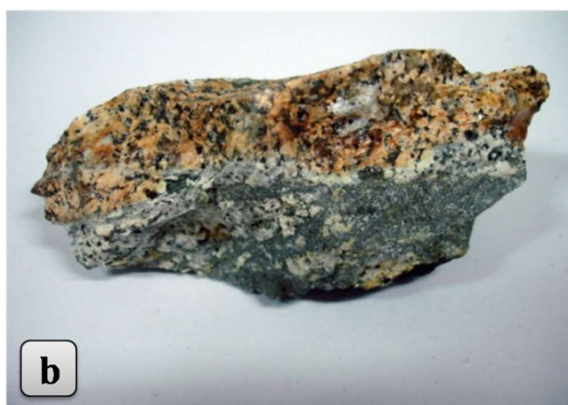
Slika 3.13. Rudne pojave u Goljiškoj reci: a ) profil sa koga su uzeti uzorci; b ) uzorak G.R.7.1 na kojem se zapaža pojava arsenopirita (sivo) u granitoidnoj steni (širina uzorka ~10 cm).
