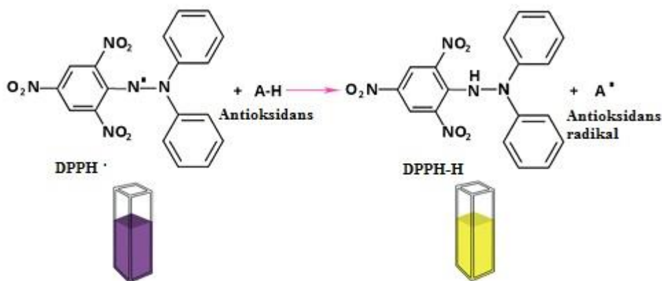
Slika 2.11: Redukcija DPPH radikala ( DPPH^{\cdot} ) sa antioksidansom (A-H) koja dovodi do promjene boje iz početne ljubičaste u žutu (izvor: CHIMACTIV, 2016).
