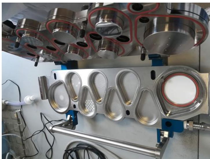
Slika 3.4. In vitro ispitivanje aerodinamičkih svojstava praškova čvrstih lipidnih mikročestica u impaktoru novije generacije (NGI)
