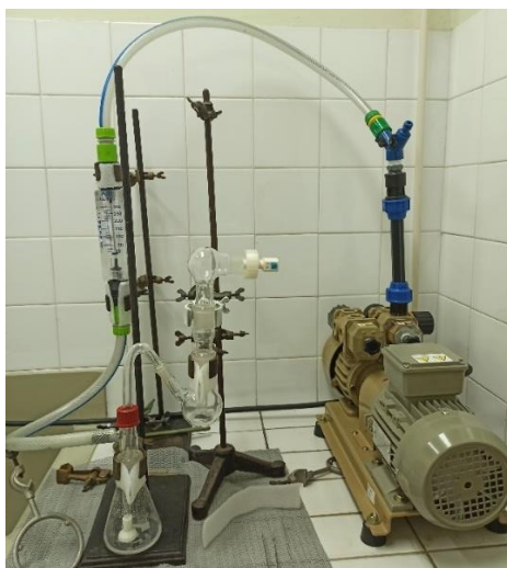
Slika 3.5. In vitro ispitivanje aerodinamičkih svojstava praškova za inhalaciju u dvofaznom staklenom impindžeru (TSI)
