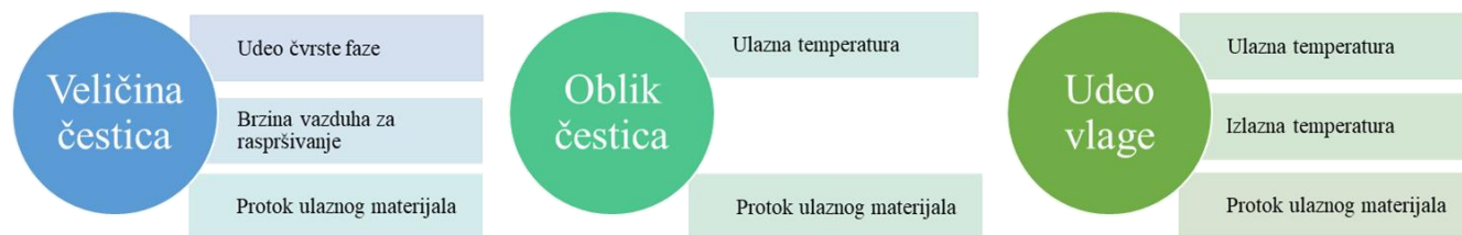
Slika 1.4. Prikaz ključnih procesnih parametara koji mogu da utiču na karakteristike finalnog praška dobijenog sušenjem raspršivanjem
