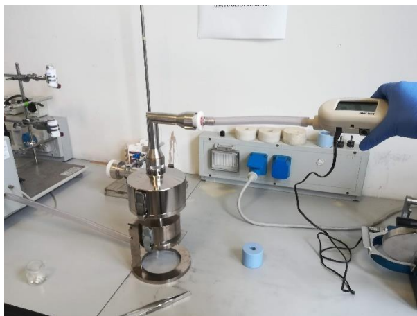
Slika 3.1. In vitro ispitivanje aerodinamičkih svojstava praškova čvrstih lipidnih mikročestica u impaktoru za brzu analizu (FSI)
