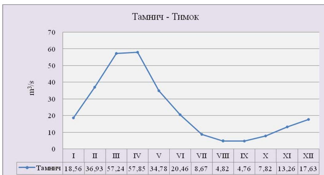
Слика 65 – Хидрограм средњемесечних протицаја Тимока код Тамнича за период 1961–2005. година
