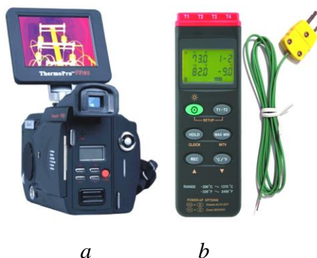
Slika 5.3 Uređaji za merenje temperature: a) IC kamera ThermoPro™ TP8S i b) četvorokanalni termometar T395 sa termoparom tipa-K
