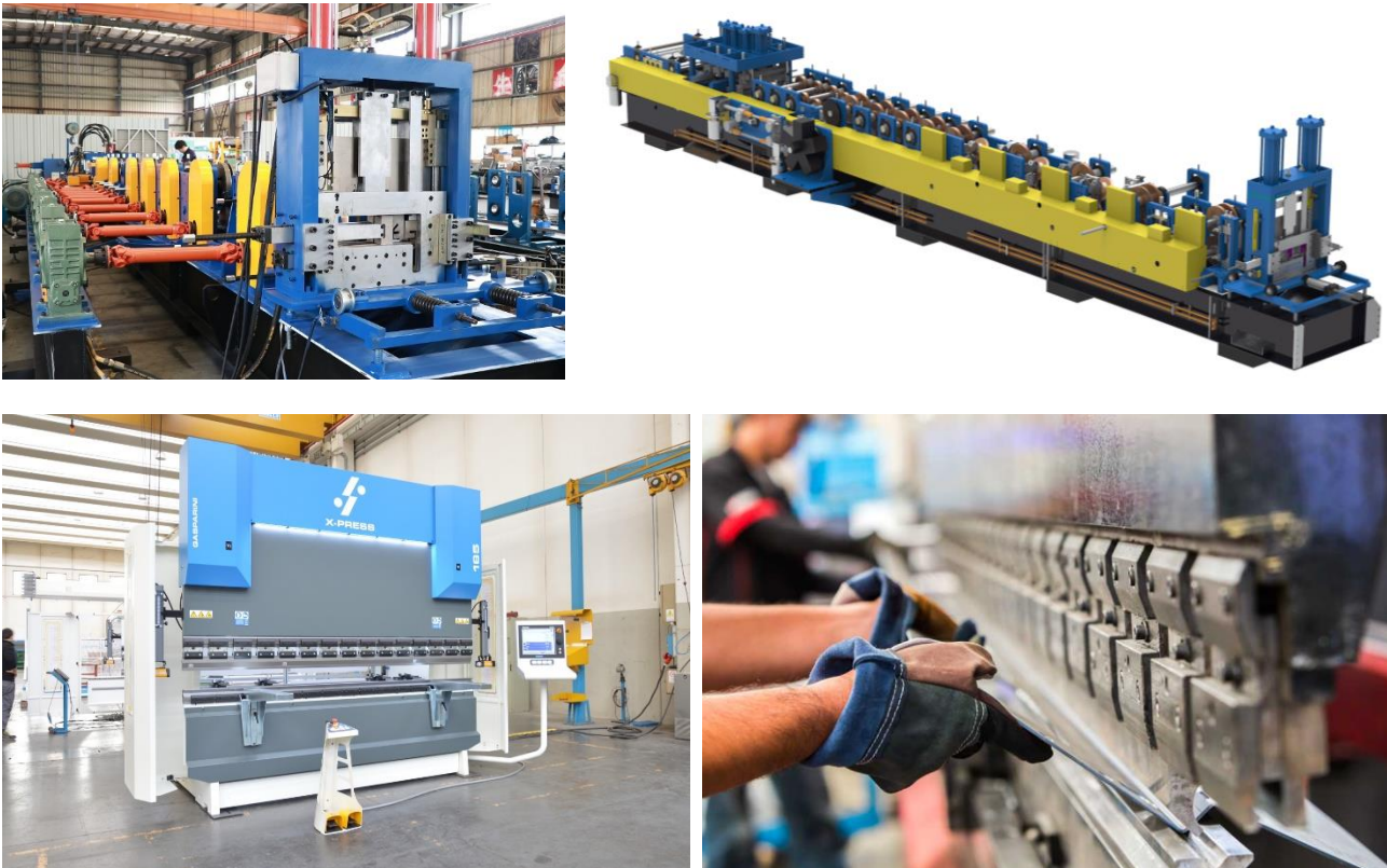
Слика 1.4. Машине за производњу хладно-обликованих челичних елемената: DAHEZB FX350 за производњу хладним ваљањем (горе) [ www.dahezbforming.com/ ] и GASPARINI X PRESS 165 преса за савијање лимова (доле) [ www.gasparini.com , www.rollerdie.com ]
