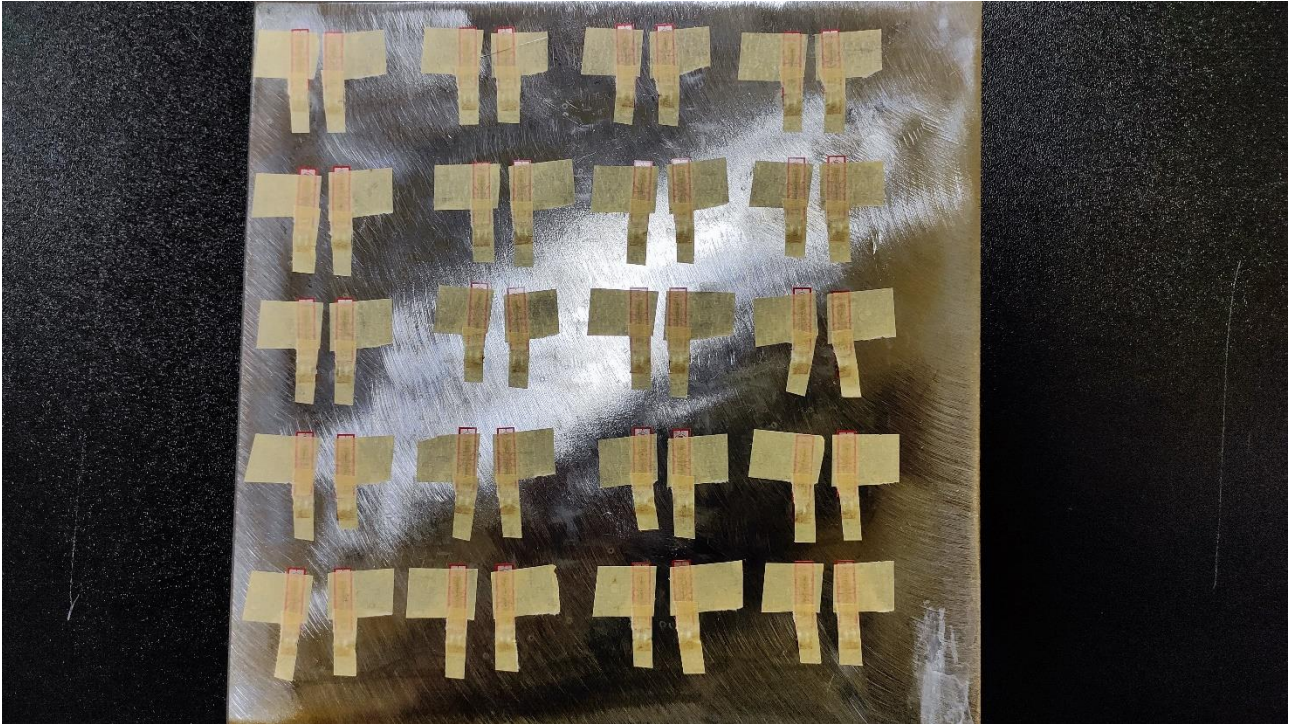
Слика 3.32. Мерне траке припремљене за лепљење
