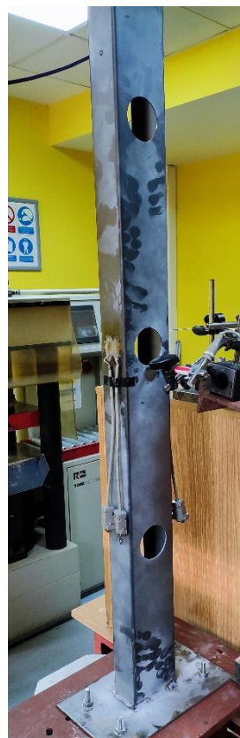
Слика 3.3. Узорак C100 са 3 отвора у ребру
