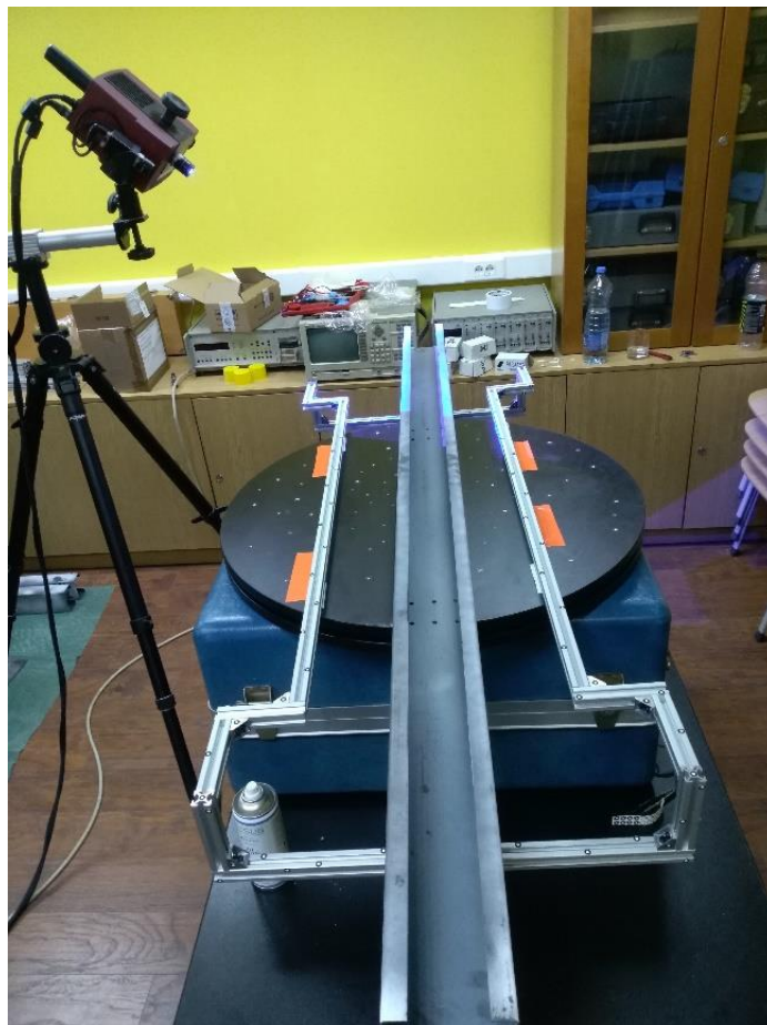
Слика 3.19. Помоћни рам и узорак припремљени за контролу геометрије
