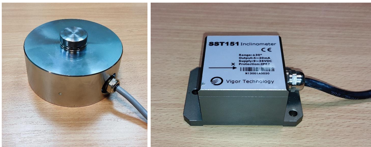
Слика 3.46. Давач силе HBM-C2F-S20/200kN (лево) и инклинометар SST151-30-P (десно)
