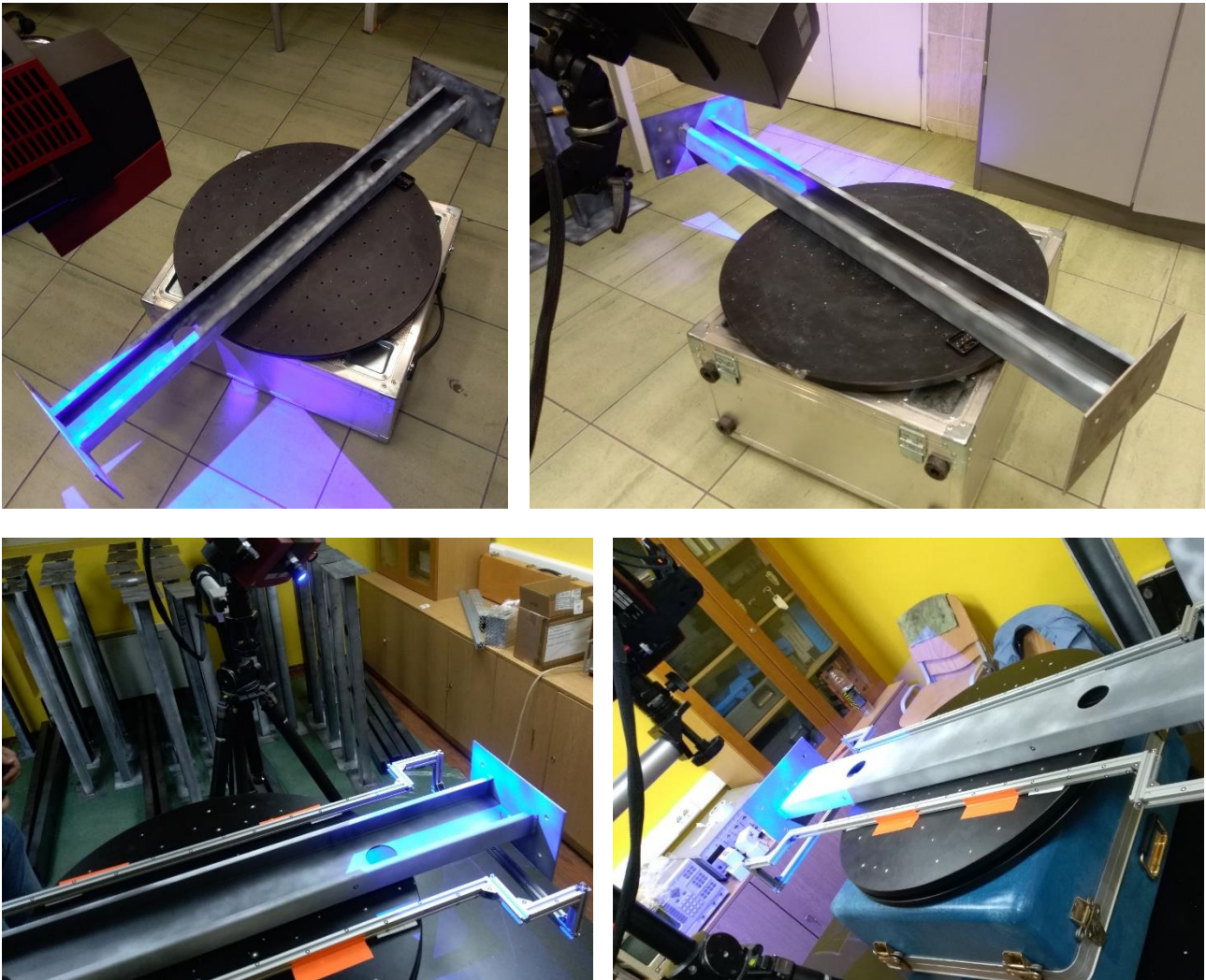
Слика 3.20. Контрола геометрије оптичким 3Д скенером ATOS (GOM)
