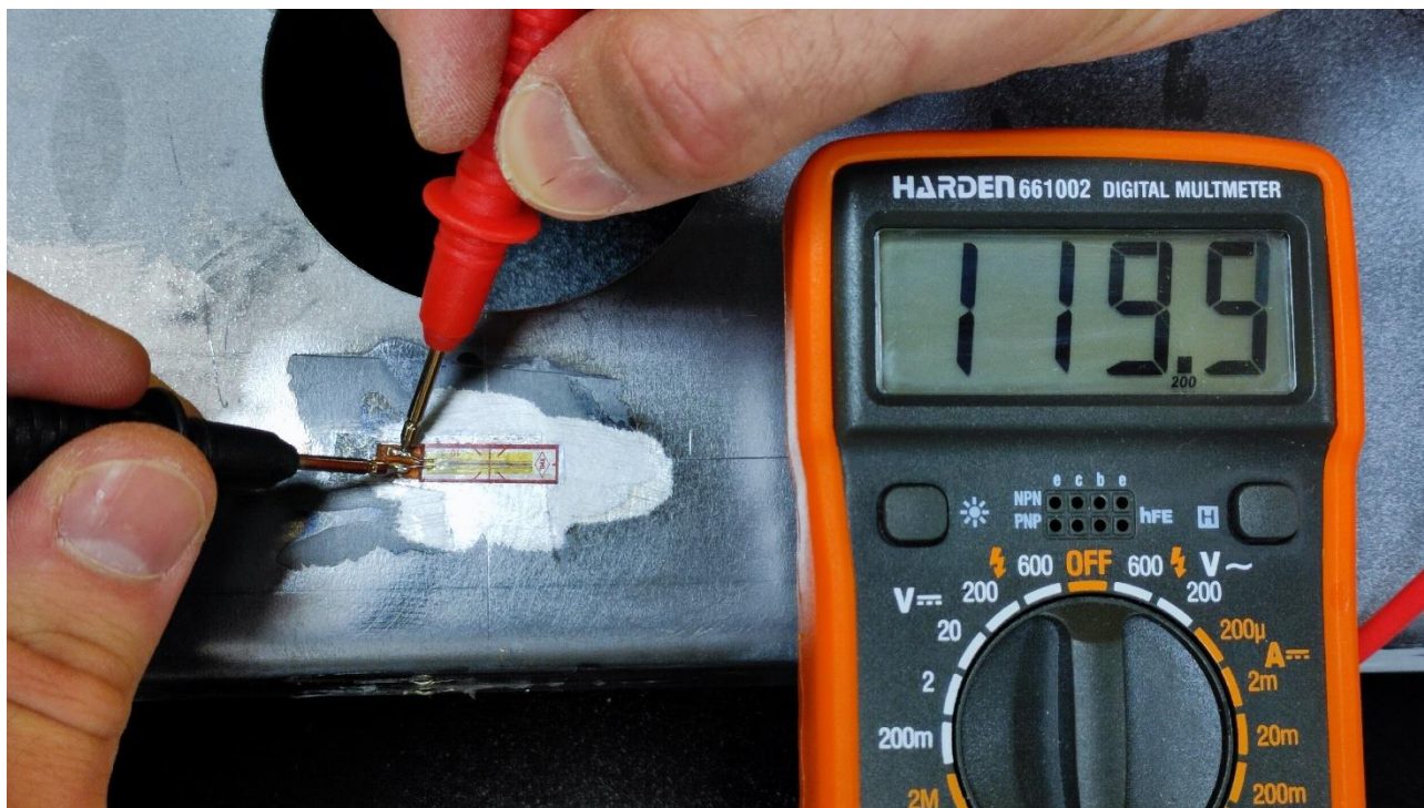
Слика 3.36. Контрола отпора у мерној траци након лепљења
