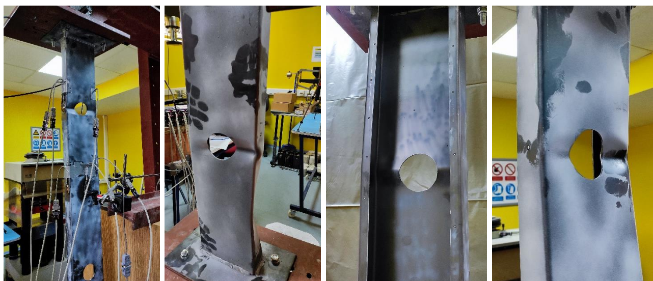
Слика 3.56. Испитивање узорака C150 на дејство центричног и ексцентричног притиска: а) C150-0-e00-2 , б) C150-0-e40-2 , в) C150-0-e80-2 , г) C150-0-e80-2 , д) C150-2-e00-2 , ђ) C150-2-e80-1 , е) C150-3-e00-2 и ж) C150-3-e40-2
