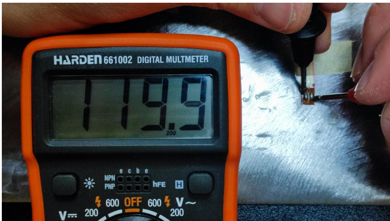
Слика 3.31. Провера отпора у мерној траци након лемљења
