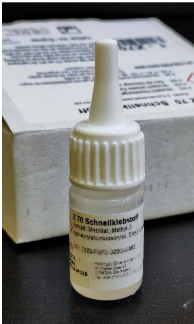
Слика 3.34. RMS 1 спреј за уклањање нечистоће (лево) и лепак Z70 за лепљење мерних трака (десно)
