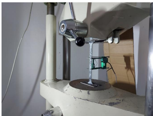
Слика 3.10. Поставка контролног теста епрувете (лево) и поређење резултата екстензометра и КДС методе (десно)
