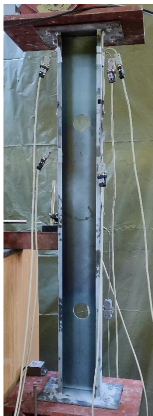
Слика 3.4. Узорак C150 са 2 отвора у ребру
