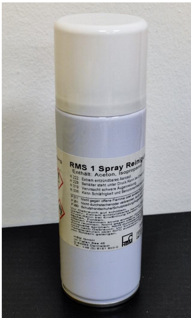
Слика 3.34. RMS 1 спреј за уклањање нечистоће (лево) и лепак Z70 за лепљење мерних трака (десно)
