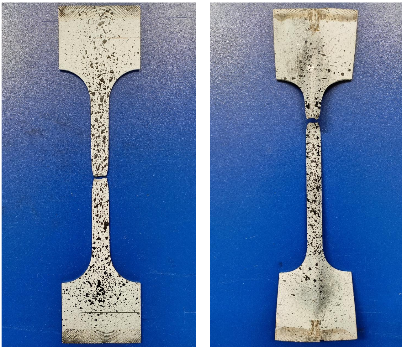
Слика 3.12. Типични облици лома за равну (лево) и угаону (десно) епрувету
