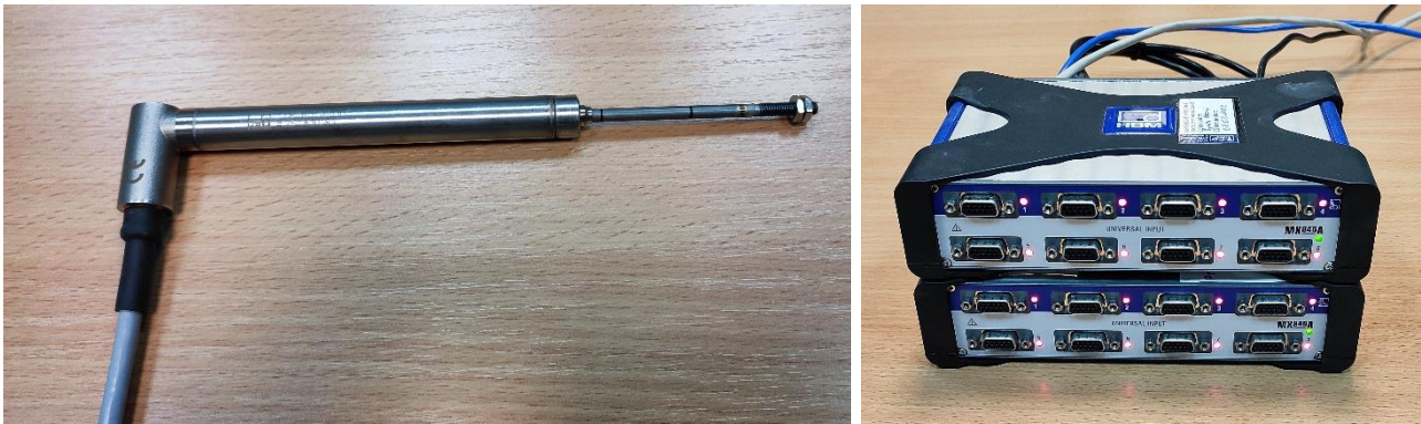
Слика 3.47. Индуктивни давач померања HBM-WA/50mm (лево) и два осмоканална аквизициона уређаја Quantum MX 840A (десно)
