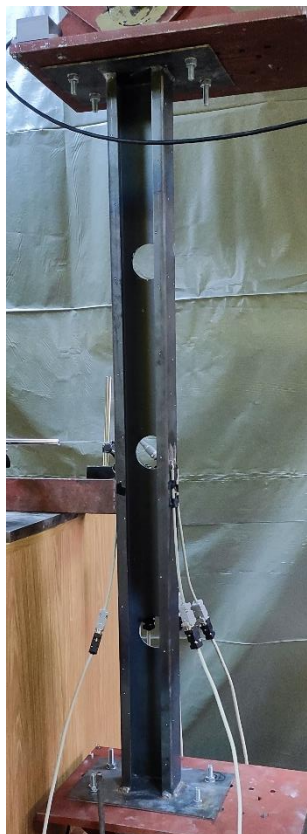
Слика 3.3. Узорак C100 са 3 отвора у ребру
