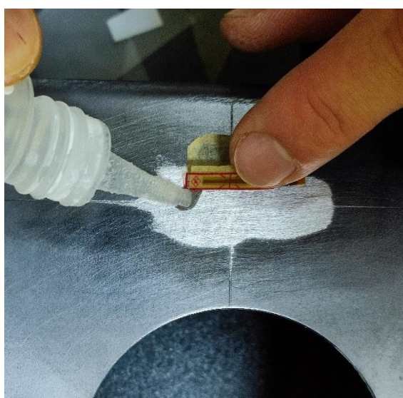
Слика 3.35. Наношење лепка на површину узорка (лево) и лепљење мерне траке (десно)
