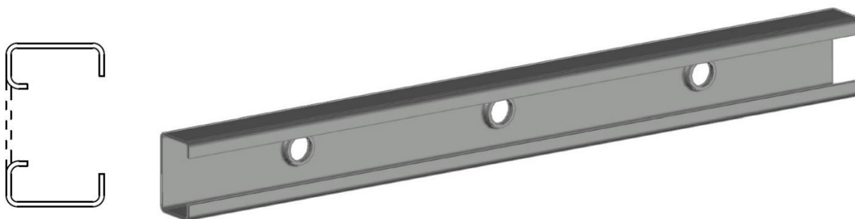
Слика 1.2. Хладно-обликовани челични елемент са ивичним укрућењима отвора
