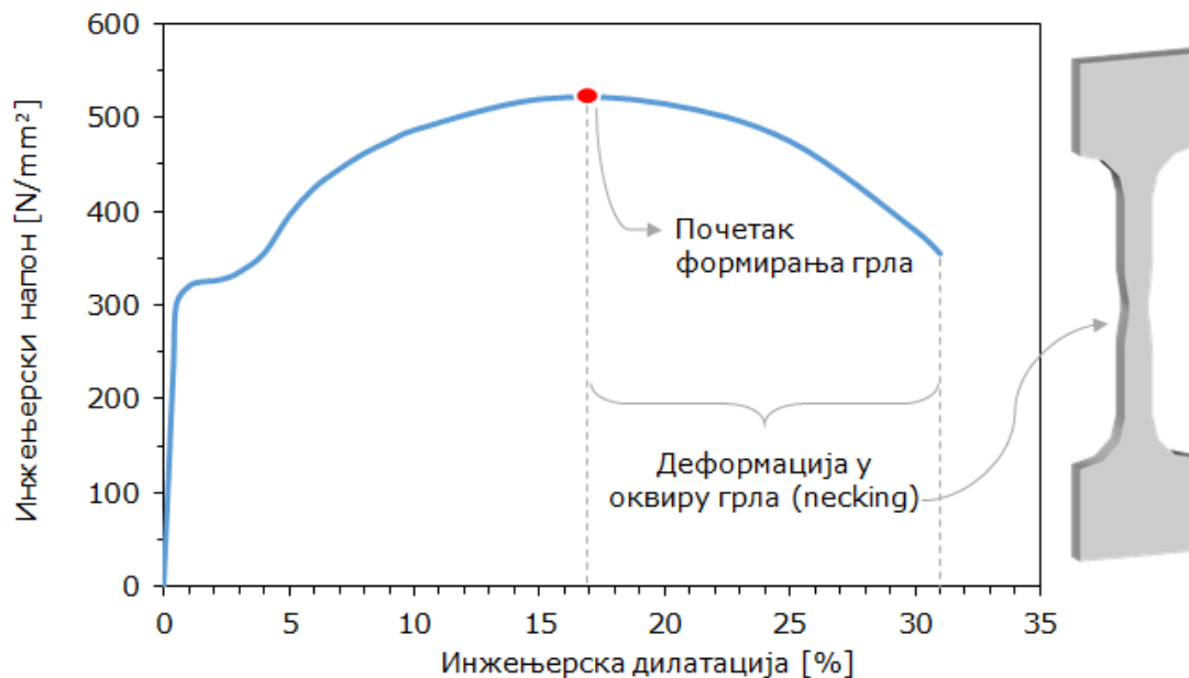
Слика 4.2. Типична крива инжењерски напон-инжењерска дилатација за конструкциони челик
