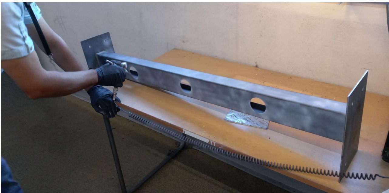
Слика 3.18. Наношење титанијум диоксида на површину узорка
