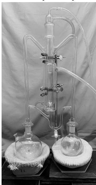
Слика 2.2.1.3. Фотографија апаратуре за симултану дестилацију и екстракцију (лево) и нацрт наставка по Лајкенсу и Никерсоновој. [109]
