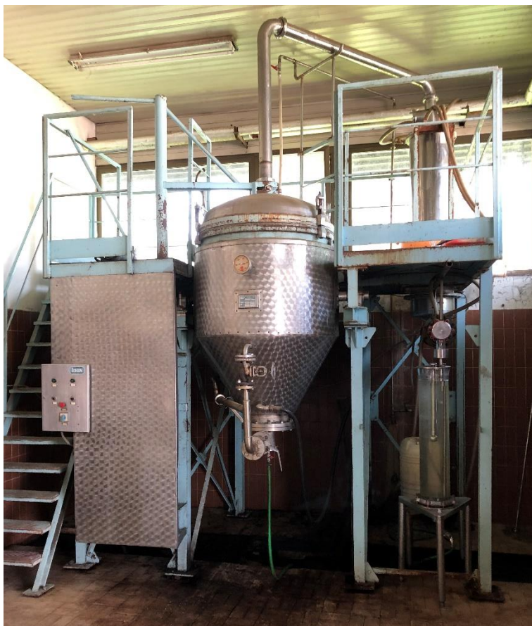
Слика 2.2.1.1. Погон за дестилацију етарских уља воденом паром на Одељењу за повртарске и алтернативне биљне врсте Института за ратарство и повртарство (Бачки Петровац).
