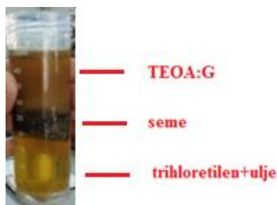
Slika 17 Ekstrakciona smeša seme+trihloretilen+TEOA:G nakon centrifugiranja na 3900 obrtaja/min u trajanju od 10 min
