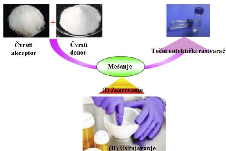
Slika 7 Reprezentativne metode pripreme eutektičkih rastvarača (I) zagrevanjem i usitnjavanjem (II) (Huang i sar. 2019)
