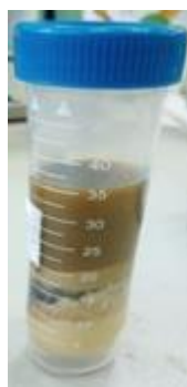
Slika 16 Ekstrakciona smeša seme+n-heksan+TEOA:G (odnos 1:5:5 m/m/m) nakon centrifugiranja u trajanju od 10 min na 3900 obrtaja/min
