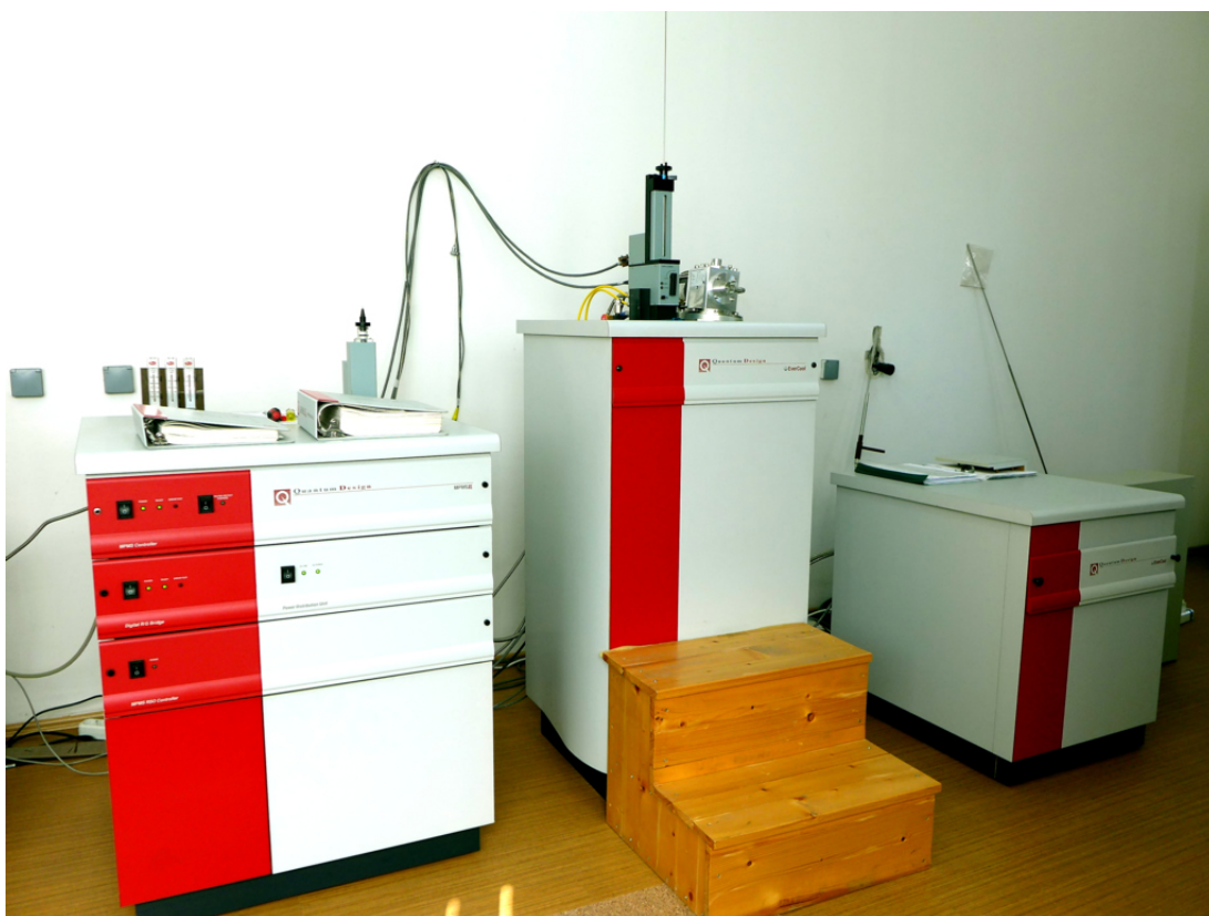
Слика 17: Quantum Design XL-5 SQUID магнетометар.
