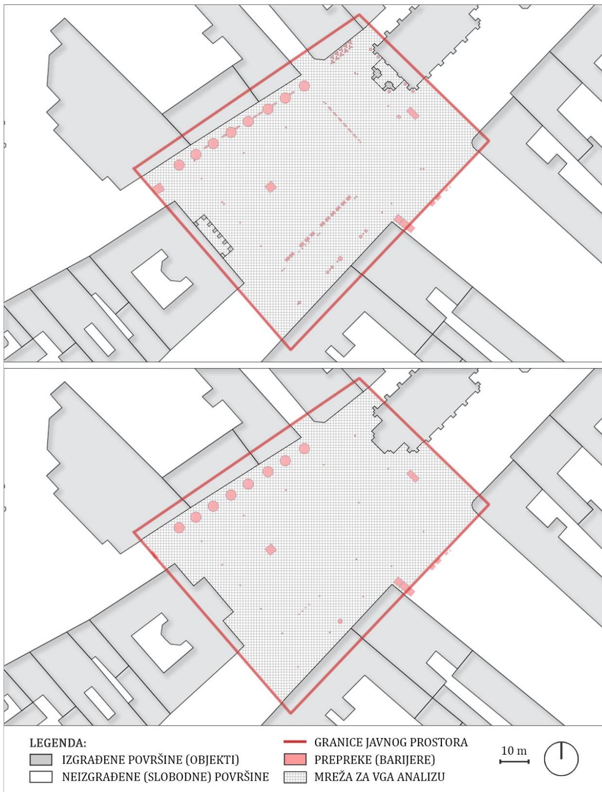
Slika 55. Priprema modela za analizu parametara prostorne konfiguracije za Trg slobode u Novom Sadu, sa preprekama (barijerama) ispod 1,50 m visine (gore) i iznad 1,50 m visine (dole)
