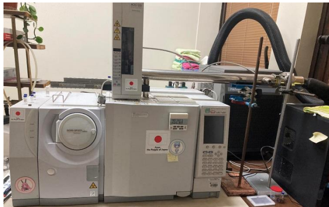
Slika 24. GC × GC – MS (GCMS-QP2010 Ultra (Shimadzu, Kyoto, Japan), korišćen za sveobuhvatnu metabolomsku analizu uzoraka hipokampusa (Univerzitet u Beogradu - Hemijski fakultet, lab. 637).
