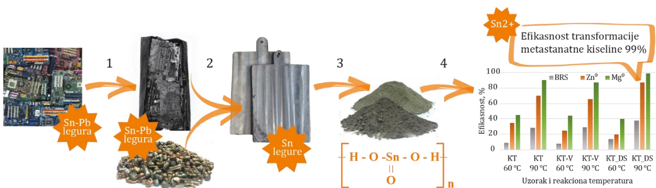
Slika 53. Uprošćena šema celokupnog procesa transformacije metastannatne kiseline u rastvorna kalajna jedinjenja (1 – vakuum piroliza, 2- topljenje i izlivanje anoda, 3 – elektrorefinacija, 4 – rastvaranje), autor [137].
