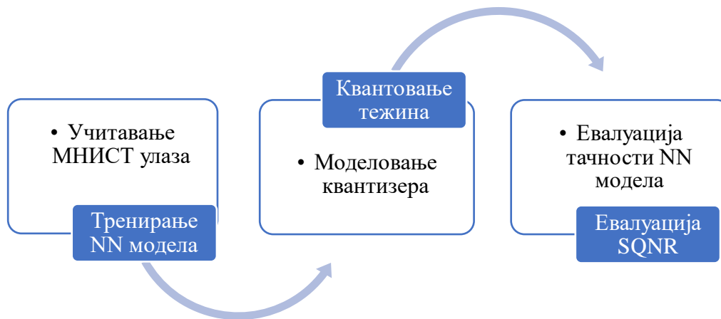
Слика 4.1.1.1. Блок дијаграм за експерименталну процену перформанси квантизације после тренинга.
