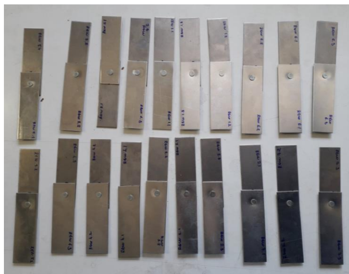
Slika 3.10. Izgled i dimenzije epruvete za ispitivanje na zatezanje spoja DP500 čelika i legure aluminijuma AW 5754, dobijenog elektrootpornim tačkastim zavarivanjem elementima [194, 195]
