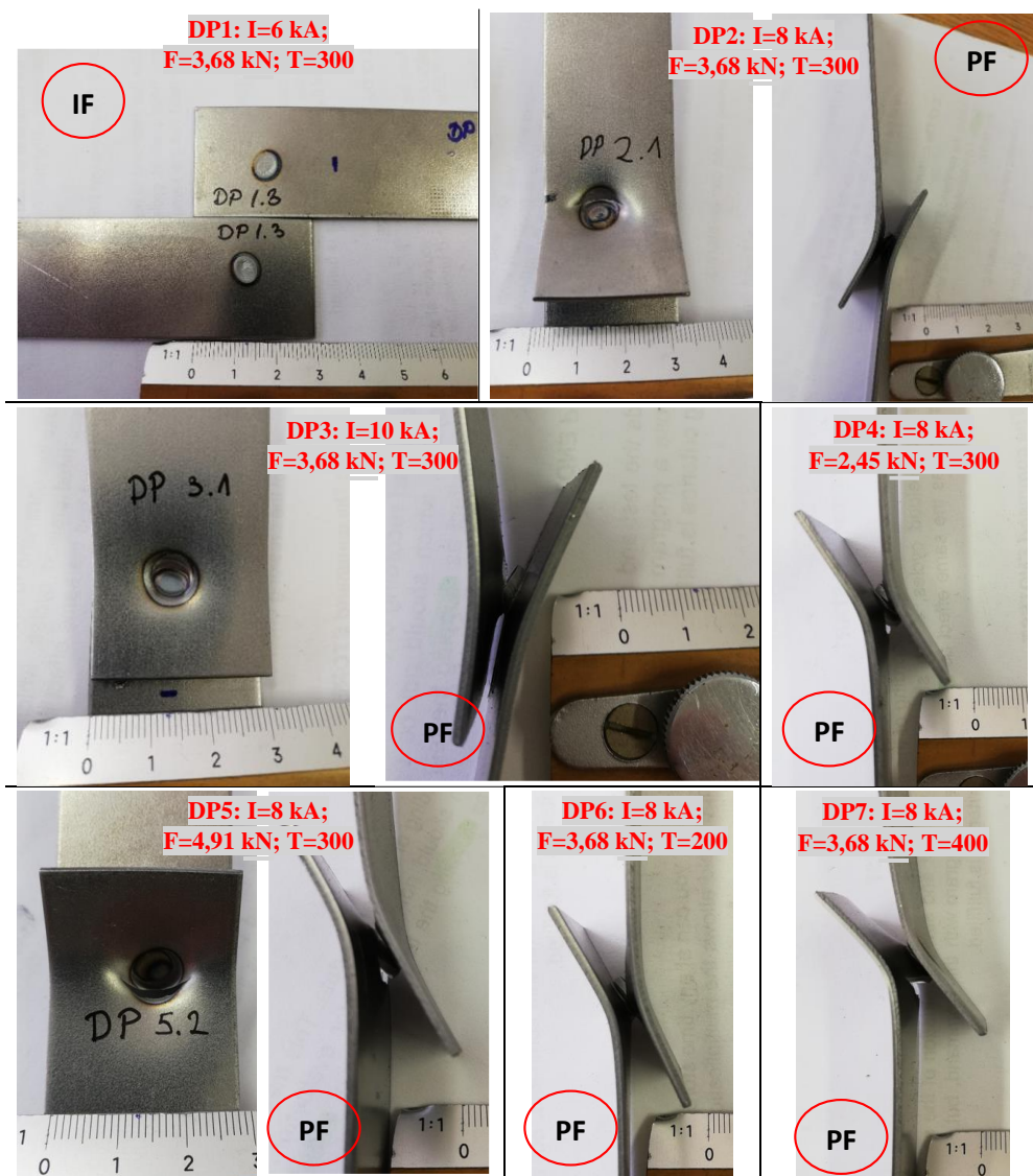
Slika 4.4. Prikaz načina loma tačkastog zavarenog spoja dva čelika od lima DP500 nakon testa na zatezanje
