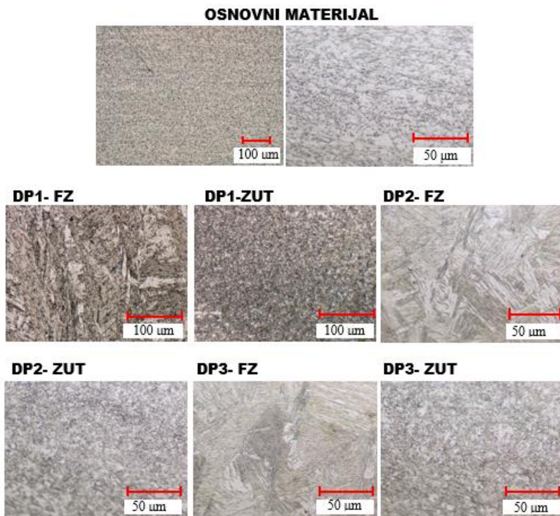
Slika 4.10. Prikaz mikrostruktura tačkastih zavarenih spojeva limova od čelika DP500 za uzorke označene sa DP1, DP2 i DP3 ( ZUT – zona uticaja toplote, FZ – zona fuzije)
