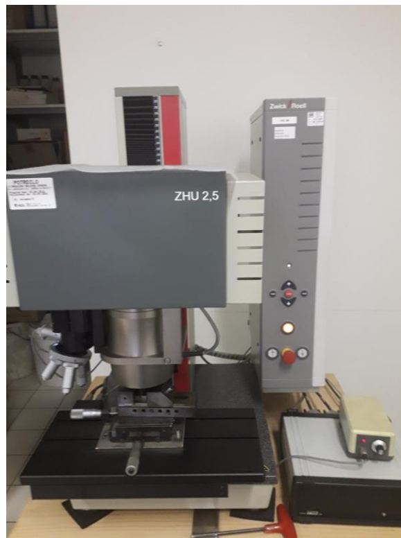
Slika 3.15. Izgled mašine za ispitivanje tvrdoće po Vickersu
