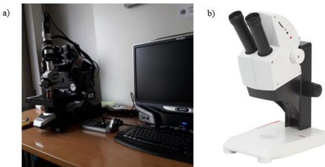
Slika 3.13. Izgled mikroskopa: a) Keyence VHX-6000; b) Leica EZ4 HD
