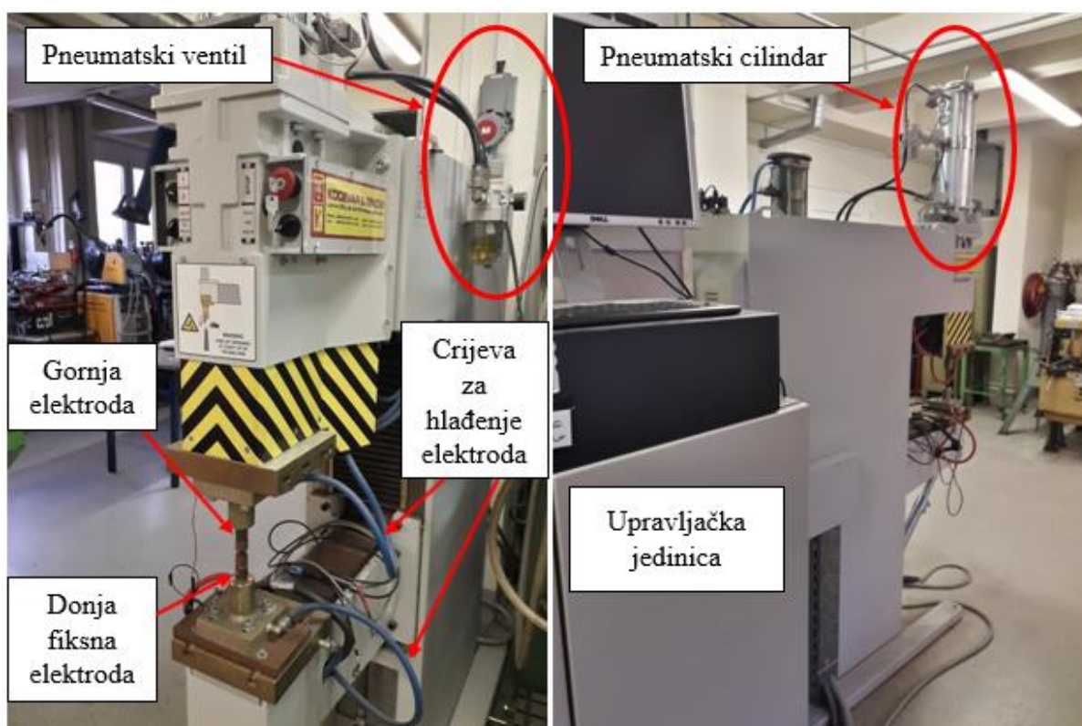
Slika 3.2. Mašina za elektrootporno tačkasto zavarivanje proizvođača Kočevar i sinovi
