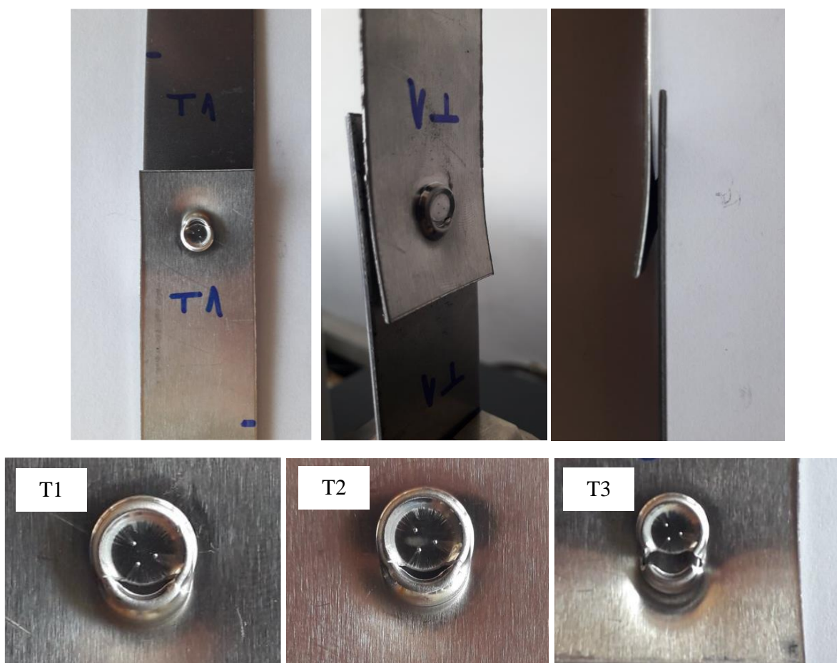
Slika 4.32. Prikaz loma uzoraka dobijenih mehaničkim spajanjem nakon testa na zatezanje
