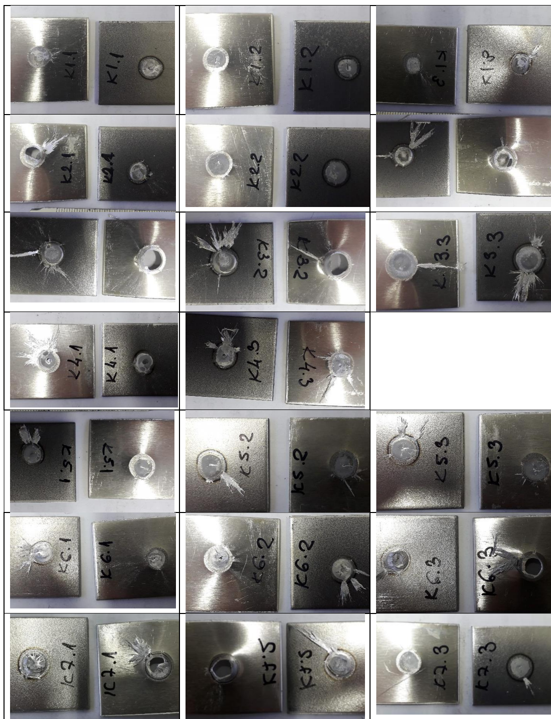
Slika 4.18. Izgled uzoraka dobijenih elektrootpornim tačkastim zavarivanjem čelika DP500 i legure aluminijuma AW 5754 nakon testa na zatezanje
