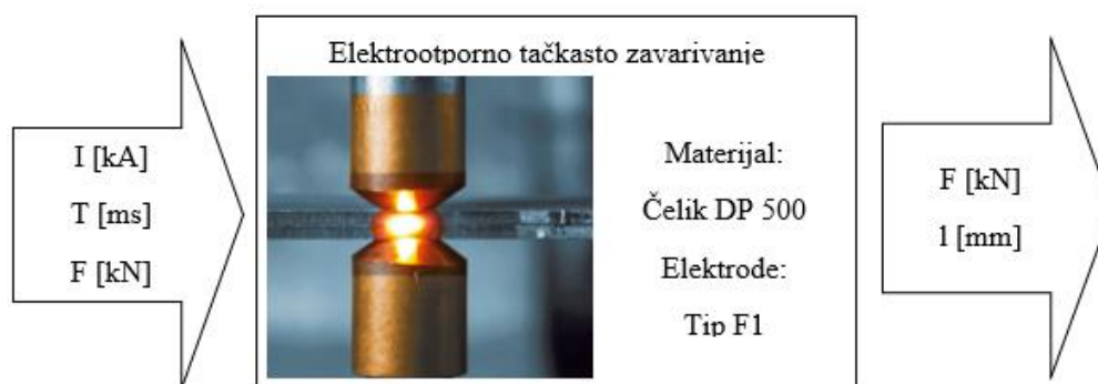
Slika 3.20. Prikaz procesa elektrootpornog tačkastog zavarivanja sa ulaznim parametrima, te izlaznim performansama zavarenog spoja na osnovu kojih će biti urađena optimizacija
