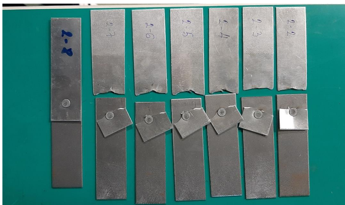
Slika 4.29. Prikaz loma REW uzoraka nakon dinamičkog ispitivanja [194]
