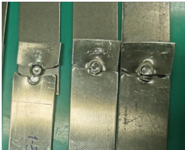
Slika 4.35. Prikaz loma uzoraka dobijenih zakivanjem bez zakovica nakon dinamičkog ispitivanja na zatezanje
