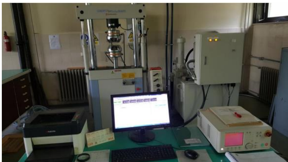
Slika 3.18. Servo hidraulična testna mašina (pulzator) Shimadzu Servopulser E100kN [55]
