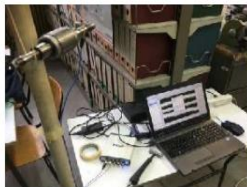
Slika 4.21 Ispitivanje impulsnom pobudom u cilju određivanja frekventnog odziva sistema
