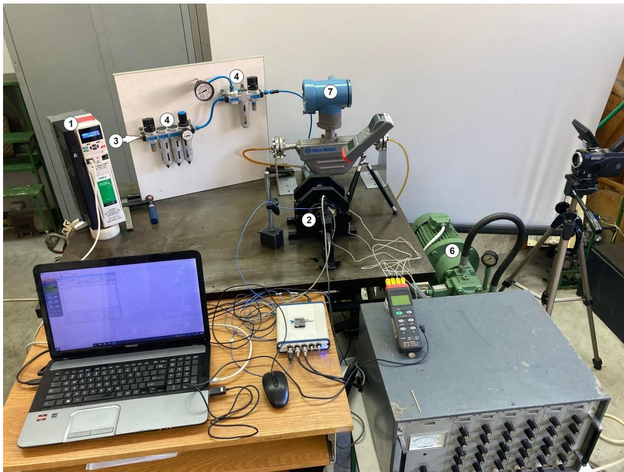
Slika 4.2 Izgled eksperimentalnog štanda za ispitivanje toplotno-mehaničkog ponašanja visokobrzinskog motor-vretena
