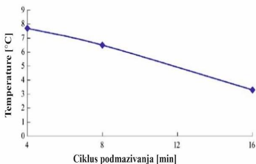
Slika 2.48 Uticaj ciklusa podmazivanja na povećanje temperature [91]
