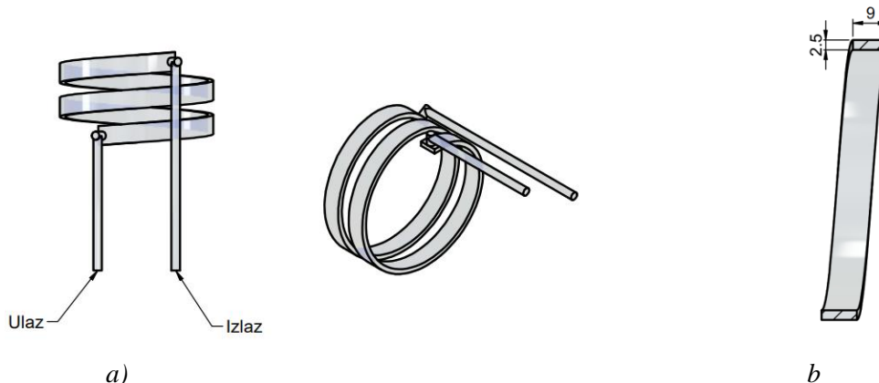
Slika 5.17 ni model rashladnog žleba
