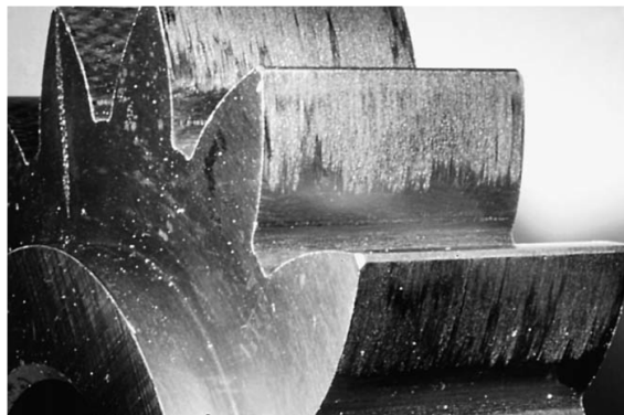
Slika 4.14: Skafing na boku zupca [89]
