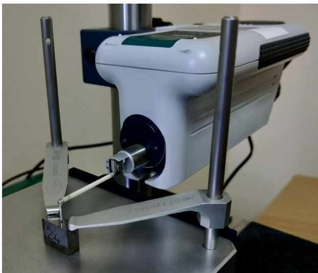
Slika 6.2: Merenje površinske hrapavosti metodom kontaktne profilometrije
