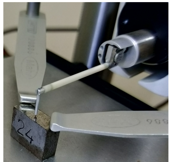
Slika 6.2: Merenje površinske hrapavosti metodom kontaktne profilometrije
