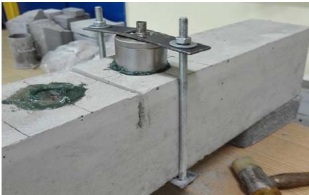
Slika 5.44 Stativ za pričvršćavanje sondi za element tokom merenja
