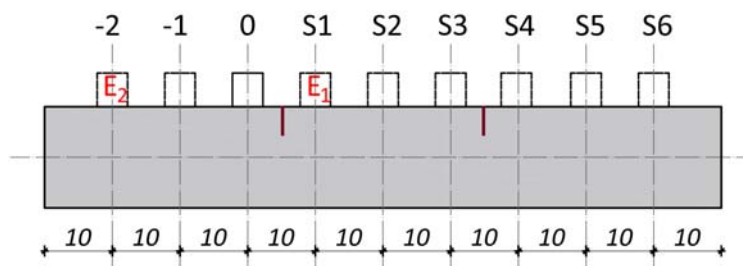
Slika 5.56 Šema ispitivanja elementa sa dva oštećenja
