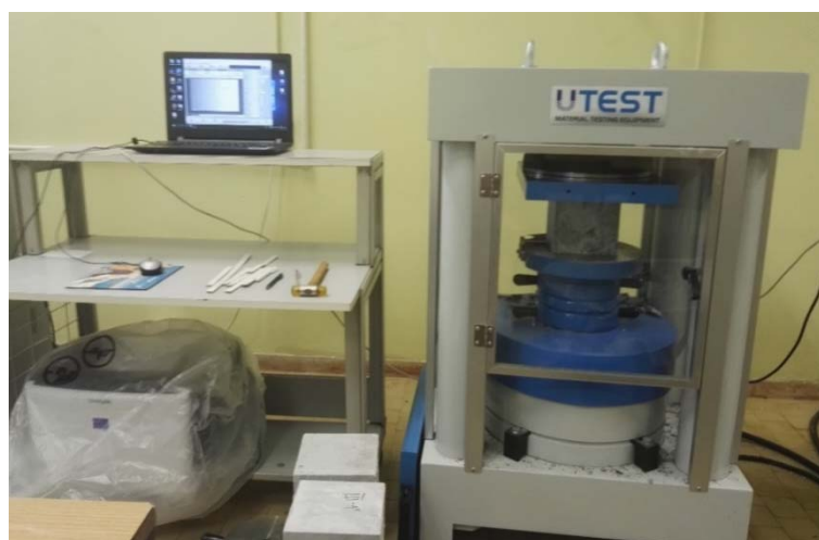
Slika 5.35 Presa za ispitivanje čvrstoće na pritisak
