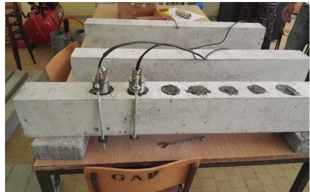
Slika 5.44 Stativ za pričvršćavanje sondi za element tokom merenja
