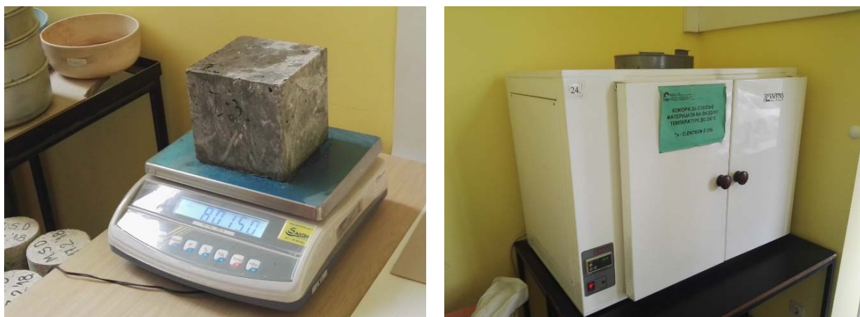
Slika 5.34 Aparatura za merenje: elektronska vaga (levo), komora za sušenje (desno)
