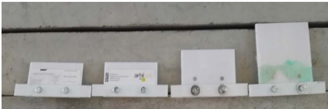
Slika 5.30 Pločice od pleksiglasa korišćene za simulaciju oštećenja
