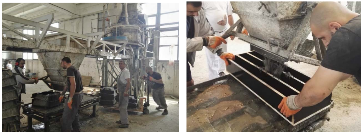
Slika 5.32 Izrada laboratorijskih modela u betonskom pogonu
