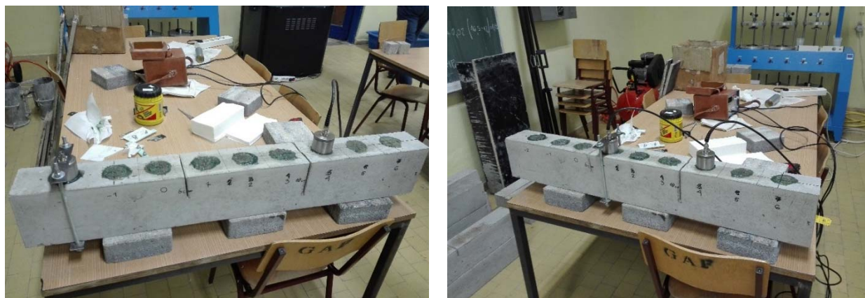
Slika 5.57 Dodatna merenja ultrazvukom na elementima serije IV
